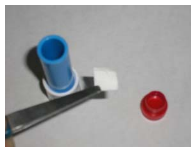
b) Filtro captador impregnado con DPE
