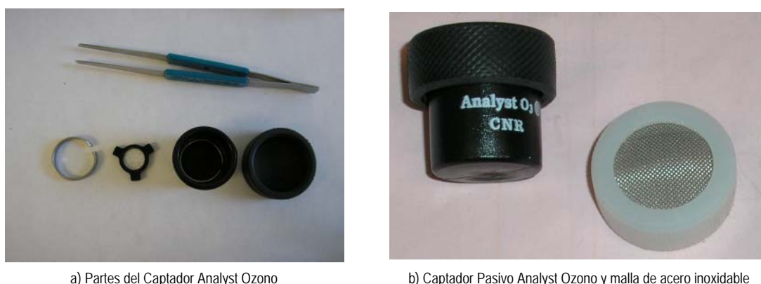
Figura 8.175. Captador pasivo Analyst para medir ozono
