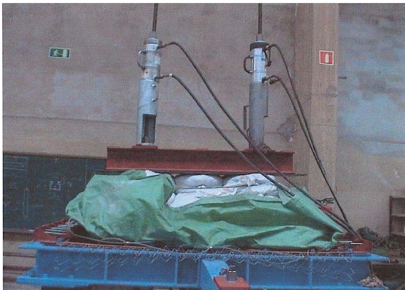
Figura 3.15. Vista del ensayo de carga distribuida sobre la malla TECCO G-65 (Castro, 2000)
