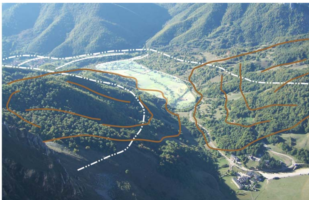
Figura 47. Vista general de la morfología heredada en la parte inferior del glaciar del Alto Deva. Con la línea de rayas y puntos blancos se delimita la máxima extensión alcanzada por el glaciar, así como los arcos morrénicos frontales fruto del retroceso glaciar. El conjunto en la actualidad aparece deformado por varios deslizamientos de ladera que han modificado la topografía generada durante el máximo glaciar. En el centro en tonos claros la llanura proglaciar generada cuando los hielos estaban ya situados en torno al paraje de Fuente De, cubeta de sobreexcavación rellena y que aparece en primer plano en la parte inferior derecha.
