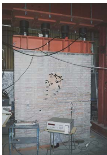
Fig. 2.179: Vista de la fábrica de ladrillo y del sistema de carga (Sánchez-Beitia 2006)
