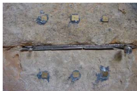
Fig. 2.107: Resultado de un ensayo de gato plano simple (Lourenco et al. 2008).
