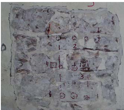
Fig. 2.192: Ensayo de gato plano doble n° 3 en un muro de la planta baja del edificio (Cortesía de Aidico).
