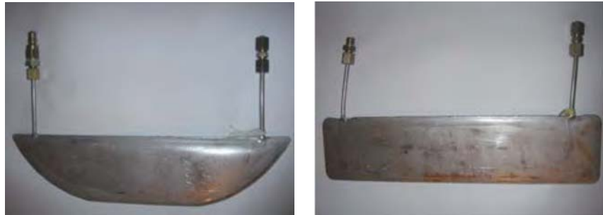
Fig. 2.134: Detalle de los gatos planos empleados en los ensayos, semi-rectangulares y rectangulares (Lourenço et al. 2005).
