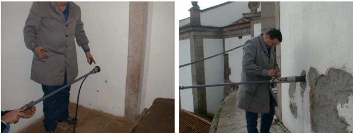
Fig. 2.277 y 2.278: Introducción del dilatómetro en las perforaciones interior (ensayo 1) y exterior (ensayo 2), (Almeida 2000).
