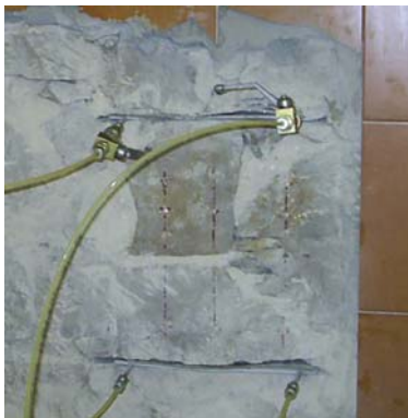
Fig. 2.191: Ensayo de gato plano doble n° 2 en un muro de la primera planta del edificio (Cortesía de Aidico)
