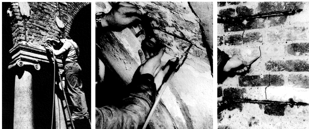
Fig. 2.22: Determinación del estado tensional sobre un tímpano del claustro de S. Eustorgio, Milán (Rossi 1985).
