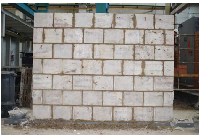
Fig. 2.206: Instante tomado durante un ensayo de gato plano simple en el muro de ladrillo referido, Marzo de 2009 (Cortesía de Aidico).
