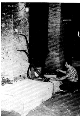
Fig. 2.16: Ensayo de gato plano doble en un pilar de la biblioteca “Classense”, Rávena (Rossi 1982a).
