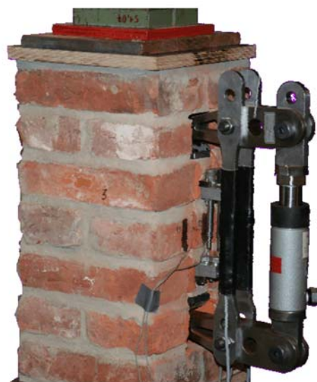
Fig. 2.316: Dispositivo móvil de ensayo, pinza FreD (Gutermann y Knaack 2008).
