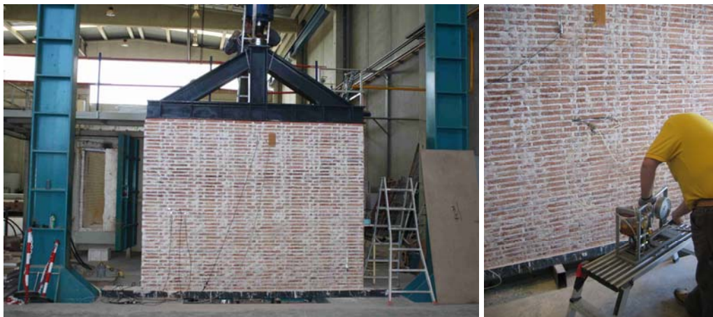
Fig. 2.205: Ensayo de muro de ladrillo ensayado en el Laboratorio del Instituto Tecnológico de la Construcción de la Comunidad Valenciana, Marzo de 2009 (Cortesía de Aidico).
