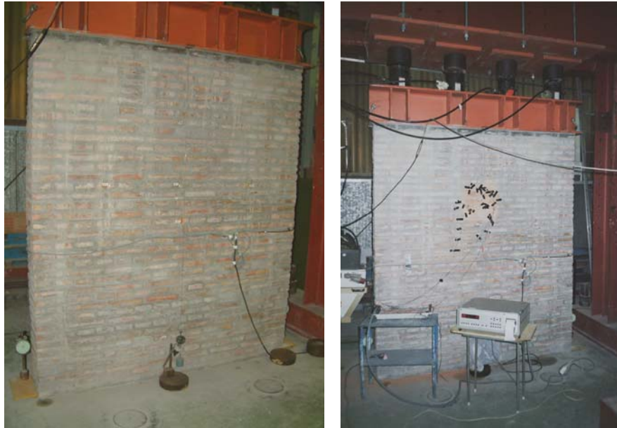
Fig. 2.225 y 2.226: Vistas de la fábrica de ladrillo y del sistema de carga (cortesía Prof. Sanchez-Beitia).
