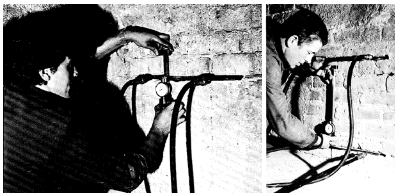
Fig. 2.9: 1ª Fase del ensayo, gato plano simple (Rossi 1982a).
