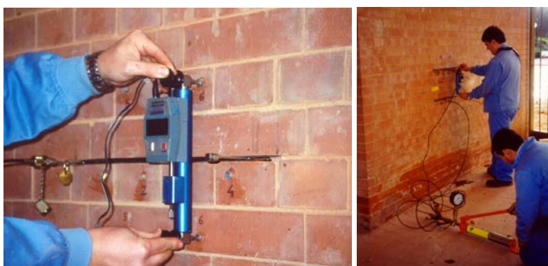
Fig. 2.208: Ejecución de un ensayo de gato plano simple en un fábrica actual de ladrillo (Ley 2007).
