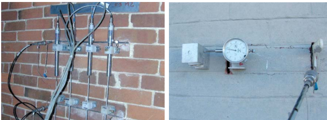
Fig. 2.121: Detalle de un ensayo de gato plano doble (Hose y Gosian).
