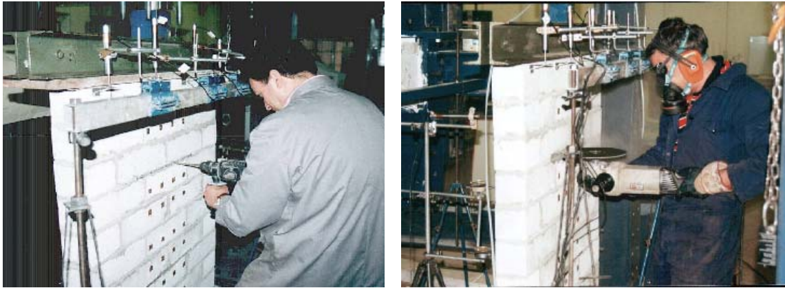
Fig. 2.101: Remoción del mortero: (a) mediante taladro, (b) mediante sierra de disco (Gregorczyk y Lourenco 2000).
