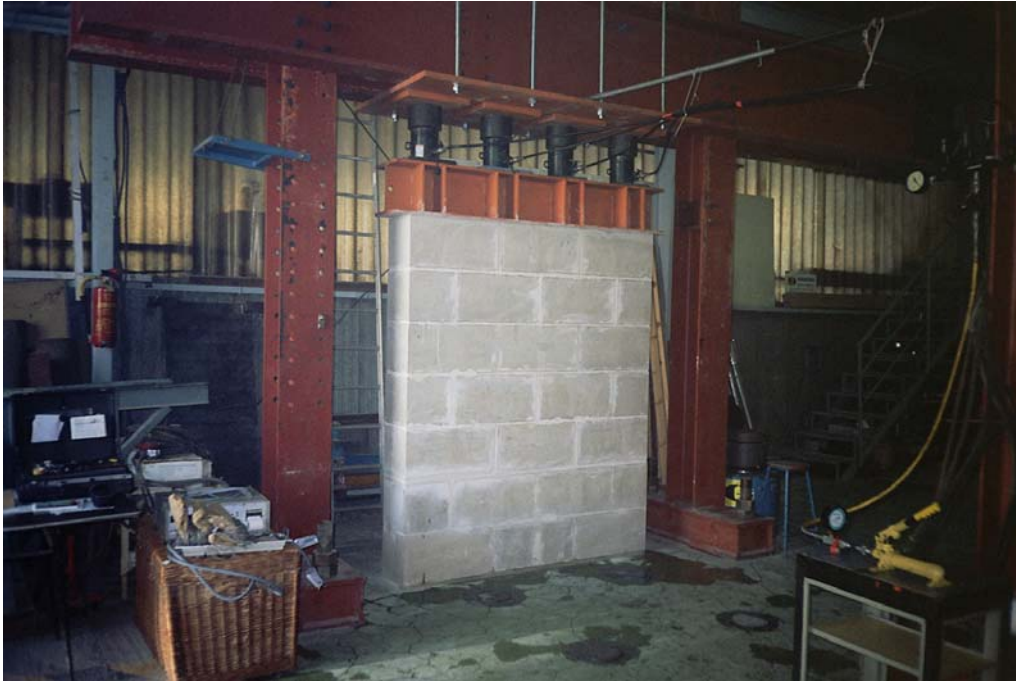
Fig. 2.219: Aspecto general de la sillería construida y ensayada en laboratorio.
