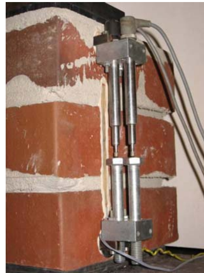
Fig. 2.315: Medida de la deformación. Se aprecia tanto la disposición de dos transductores de desplazamiento, como la disposición de una galga extensométrica afectando a dos tendeles de mortero (Gutermann y Knaack 2008).
