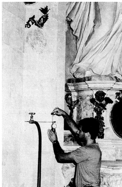
Fig. 2.41: Ensayo de gato plano ejecutado en uno de los pilares (Giani et al. 1988).
