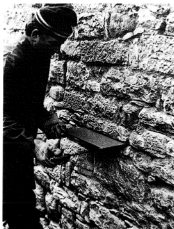
Fig. 2.35: Medida de la tensión de una fábrica de piedra en la iglesia de Madonna del Prato, Gubbio (Rossi 1988).
