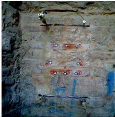
Fig. 2.195: Ensayo de gato plano doble nº 1 en un muro de ladrillo de la planta baja del inmueble (Cortesía de Aidico).
