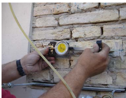
Fig. 2.189: Ensayo de gato plano doble en una fábrica de ladrillo sita en un edificio de Burjassot, Valencia (Cortesía de Aidico).
