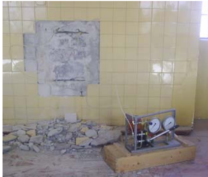
Fig. 2.190: Ensayo de gato plano doble n° 1 en un muro de la primera planta del edificio (Cortesía de Aidico)
