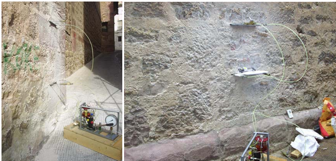
Fig. 2.193: Ensayo de gato plano doble en una fábrica de sillería de la iglesia de Nuestra S a de los Ángeles en Tuéjar-Valencia (Yuste et al. 2007).
