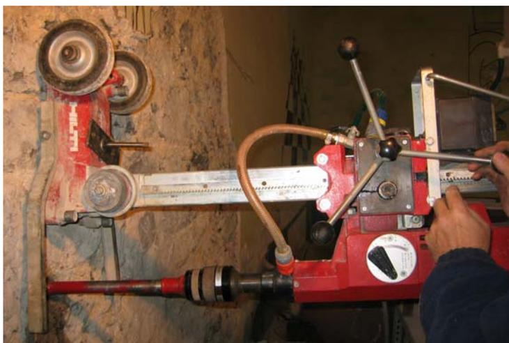
Fig. 3.120: Configuración general de la perforación ejecutada en relación con un ensayo mini-presurométrico realizado en la mampostería caliza existente en uno de los muros portantes del Seminario Mayor de Comillas (Cantabria, España).
