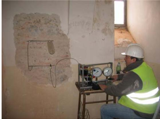
Fig. 3.36: Instante tomado durante el proceso de purga del aire, previamente a la ejecución de un ensayo de gato plano doble realizado en el Seminario Mayor de Comillas.
