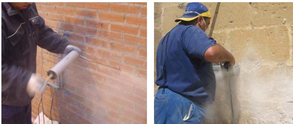
Fig. 3.22: Remoción de las porciones de material residual tras la realización de la roza mediante una bomba de aire. Ensayo de gato plano simple realizado en una fábrica de ladrillo ensayada en el Laboratorio de Estructuras de la Universidad de Cantabria.
