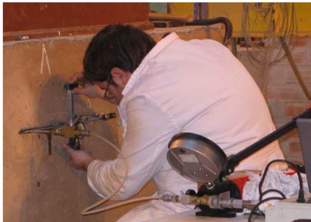
Fig. 3.51: Bomba hidráulica manual Glötzl M2H16 de la casa alemana Glötzl, empleada en el laboratorio de ensayos no destructivos del Grupo de Tecnología de la Edificación de la Universidad de Cantabria.
