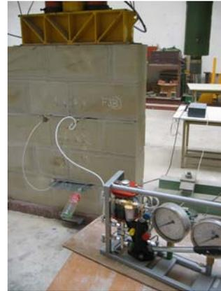
Fig. 3.37: Instante tomado durante el proceso de purga del aire, previamente a la ejecución de un ensayo de gato plano doble realizado en un muro de sillería ensayado en el Laboratorio de Estructuras de la Universidad de Cantabria.
