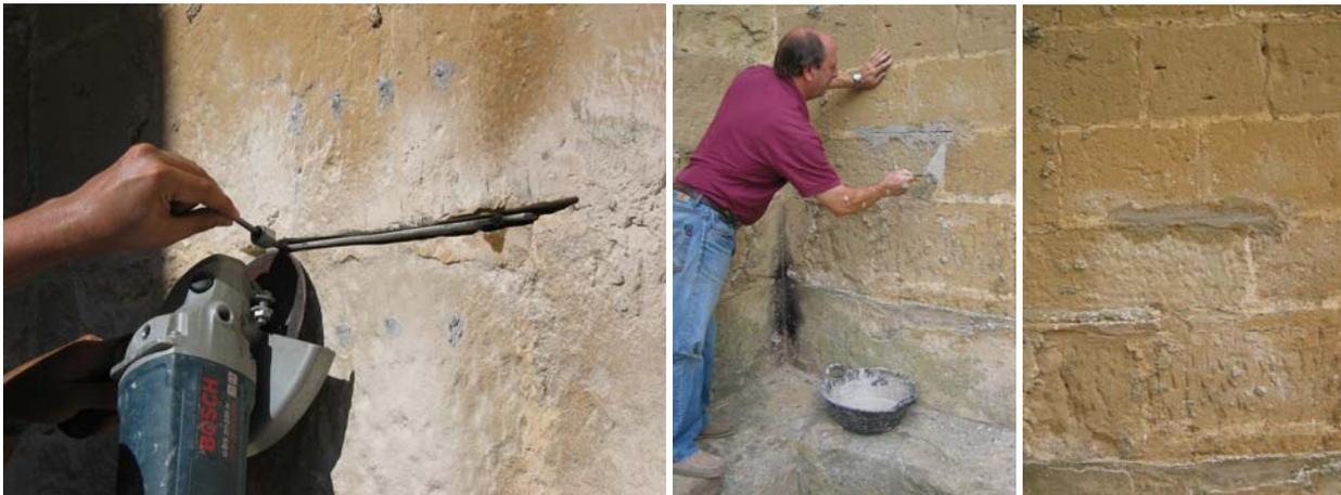
Fig. 3.40-3.42: Corte de los puertos de entrada y salida del gato plano, y recibido con mortero de cal de la roza.
