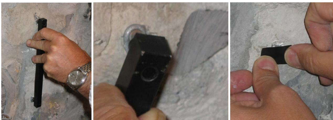
Fig. 3.11: Posicionamiento del segundo punto de control mediante barra fija.
