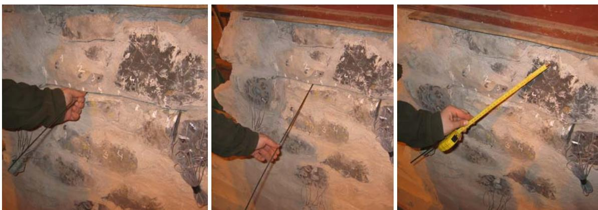
Fig. 3.29-3.31: Pasos para la medida de la profundidad de la roza ejecutada. Ensayo de gato plano simple realizado en una mampostería caliza ensayada en el Laboratorio de Estructuras de la Universidad de Cantabria.
