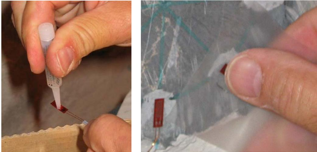
Fig. 3.89: Aplicación del adhesivo en la banda.
