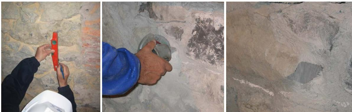
Fig. 3.1: Nivelado durante la fase de replanteo de los puntos de control necesarios para la ejecución de un ensayo de gato plano simple realizado en un contrafuerte de la iglesia del Seminario Mayor de Comillas (Cantabria, España).
