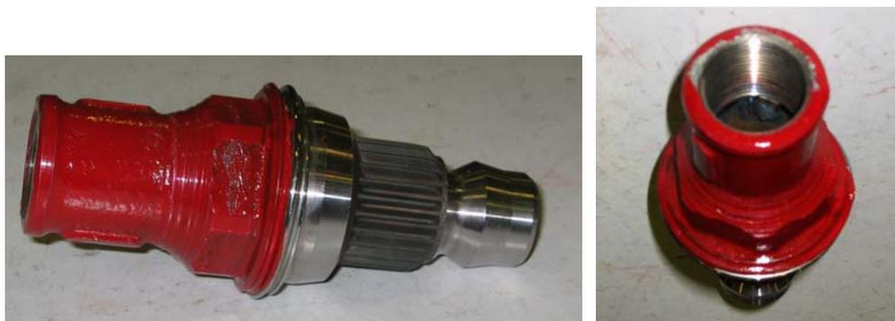
Fig. 3.113: Detalle general del cabezal adaptado para el perforador Hilti, desarrollado en el Laboratorio de Estructuras de la Universidad de Cantabria. Puede apreciarse la rosca hembra existente para el posterior roscado de la rosca macho de uno de los manguitos-conectores fabricado.
