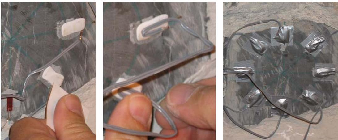
Fig. 3.91: Protección de las galgas extensométricas mediante adhesivo plástico maleable.
