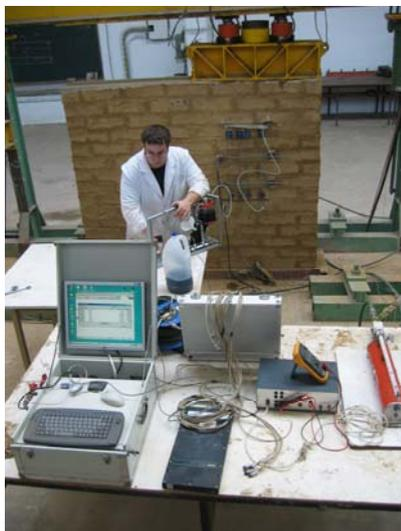
Fig. 3.59: Detalle general del sistema de adquisición de datos, marca Solartron IMP 35951C-35951B, equipado con tarjeta a PC IMP 25954C.
