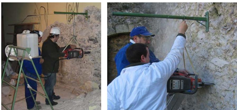
Fig. 3.27: Ajuste de la altura necesaria de la sierra para ejecutar la roza en la posición replanteada. Ensayo de gato plano doble realizado en el Seminario Mayor de Comillas.
