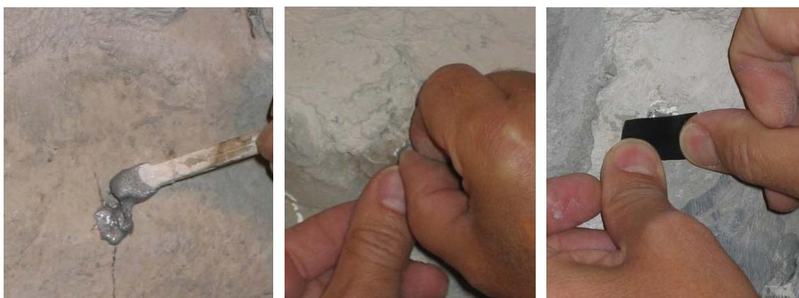
Fig. 3.8: Aplicación del adhesivo en el sustrato.
