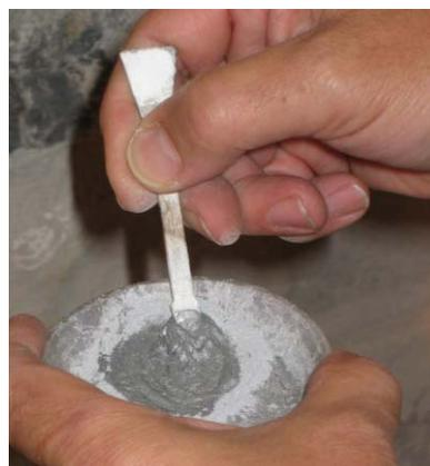
Fig. 3.6: Mezcla de ambos con un espátula hasta conseguir viscosidad deseada.
