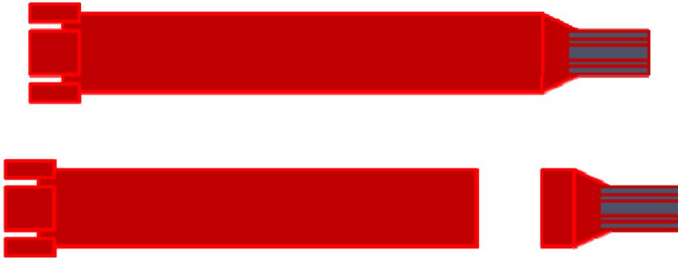
Fig. 3.110. Corte de una corona Hilti de de 40 cm de longitud y 36 mm de diámetro.
