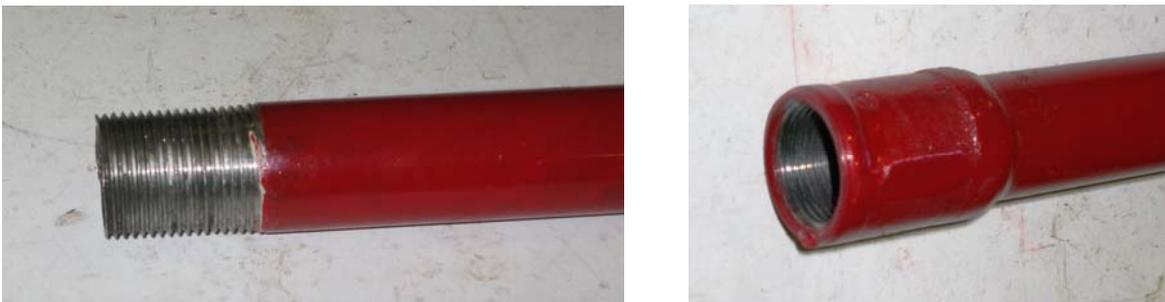
Fig. 3.112: Detalle de las roscas cónicas macho y hembra de uno de los manguitos-conectores fabricados en el Laboratorio de Estructuras de la Universidad de Cantabria.
