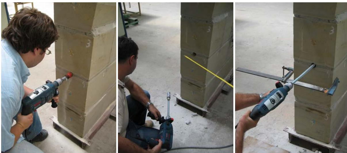
Fig. 3.107-3.109: Primera aproximación para la consecución de perforaciones de mayor profundidad que las proporcionadas por la corona hueca de 36 mm.
