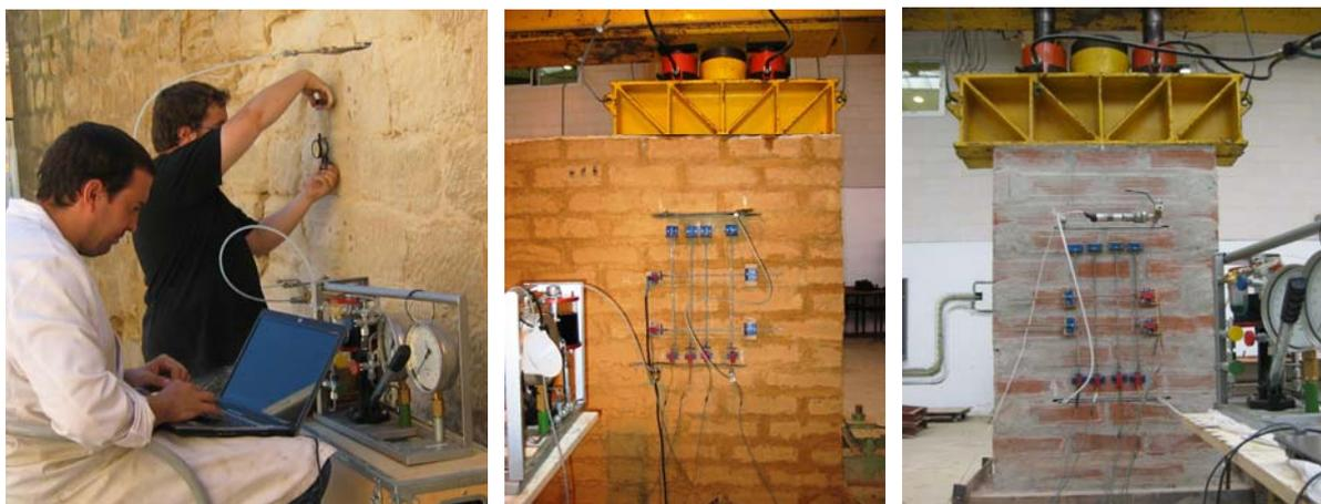
Fig. 3.55: Instante tomado durante el registro del desplazamiento registrado por un par de puntos de control durante un ensayo de gato plano simple llevado a cabo en Zarratón (La Rioja).
