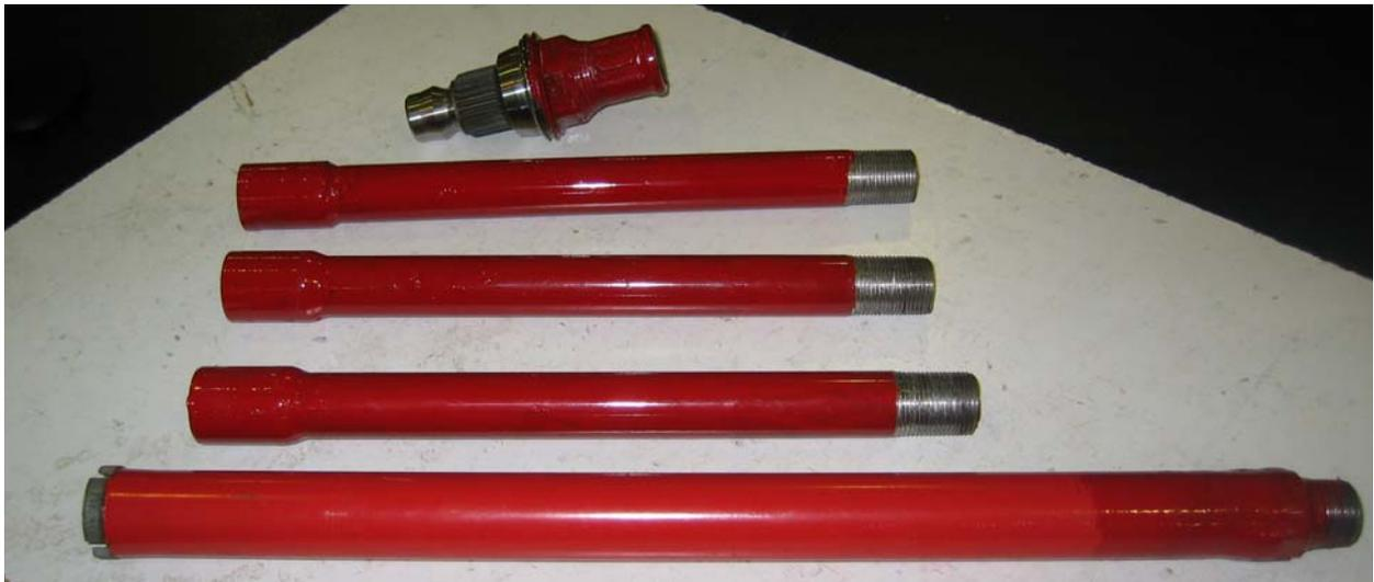
Fig. 3.111: Conectores tubulares fabricados, así como la cabeza de ajuste al perforador Hilti (parte superior) y cabeza de corte de diamante (parte inferior).
