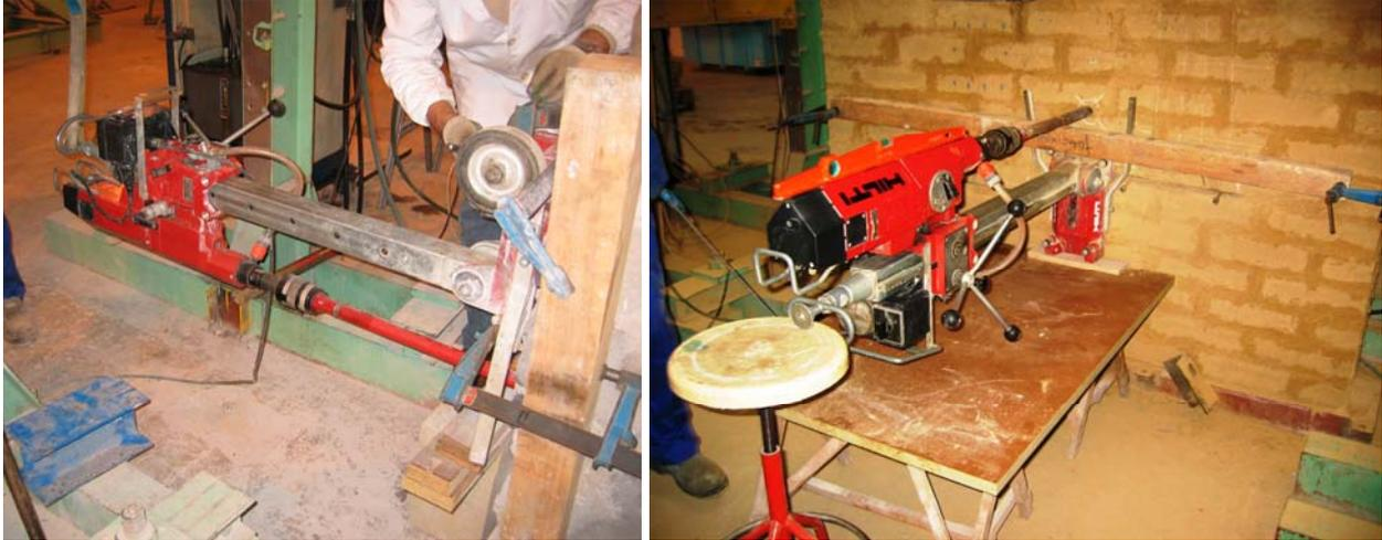
Fig. 3.116: Necesidad de dar la vuelta al taladro para evitar que los dispositivos que gobiernan el avance de la perforación queden en contacto con el terreno si el ensayo queda a una altura reducida. Igualmente, puede apreciarse como el taladro está anclado al muro sin necesidad de disponer elementos de apoyo.
