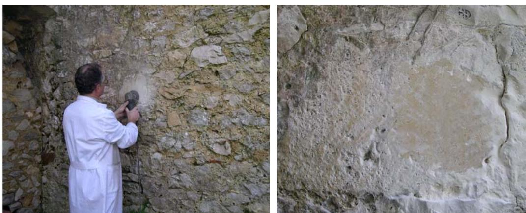
Fig. 3.80: Instante captado durante el proceso de preparación y limpieza de la superficie pétreo en la que se realizó un hole drilling en el palacio de Riva-Herrera de Santander.
