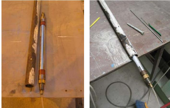
Fig. 3.125-3.126: Procedimiento para la eliminación de la rigidez de la sonda presiométrica.
