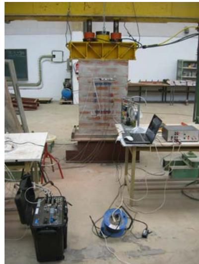
Fig. 3.60: Sistema portátil de adquisición, acondicionamiento y registro para la medida de hasta 16 canales analógicos de entrada, con bastidor modelo Cronos SL-2, marca IMC, y con 2 módulos de 8 entradas diferenciales modelo CRSL/DCB-8-D, marca IMC (Laboratorio de ensayos no destructivos del Grupo de Tecnología de la Edificación de la Universidad de Cantabria, LABEND-UC).
