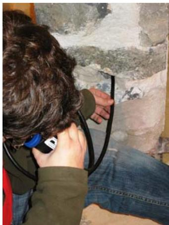
Fig. 3.122 y 3.123: Auscultación de la perforación realizada en un muro de mampostería caliza ensayado, con posterioridad, en el Laboratorio de Estructuras de la Universidad de Cantabria, para verificar la idoneidad de la misma.
