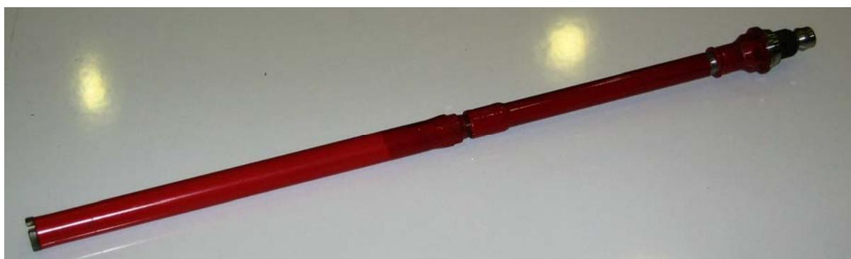
Fig. 3.115: Aspecto del útil una vez fabricado y ensamblado haciendo uso de un único manguito-conector. La longitud aproximada del útil de perforación ilustrado en la imagen es de 70 cm, la cuál puede incrementarse hasta 1.30 m mediante acoplamiento de los otros manguitos producidos.
