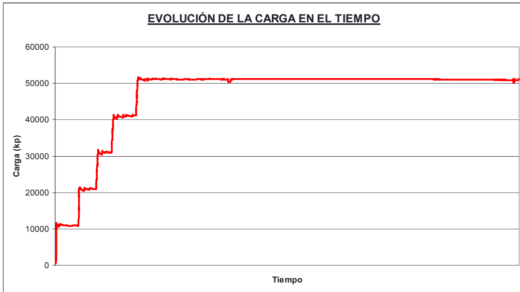
Fig. 4.2.52: Introducción de la carga durante el ensayo. El nivel medio de carga vertical mantenido constante en la cabeza del muro fue de 51,359.5 kp.
