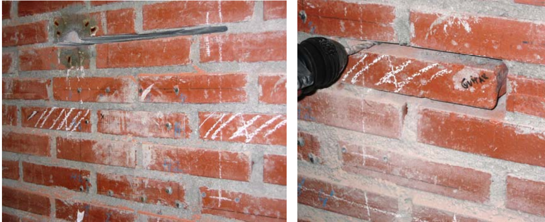
Fig. 4.3.91: Detalle de las dos piezas a remover (rayadas) y de la pieza simple de fábrica escogida para realizar el ensayo (la dispuesta entre las dos anteriores).
