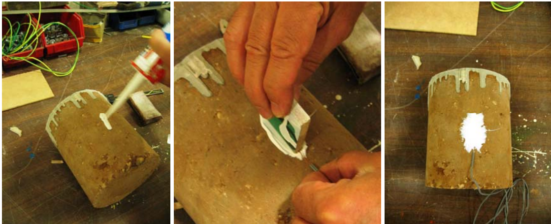
Fig. 4.5.85, 4.5.86 y 4.5.87: Adhesión y protección de una galga extensométrica a una probeta de tierra mediante silicona.
