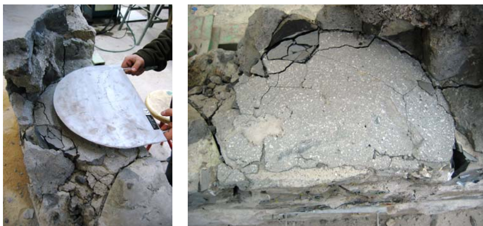
Fig. 4.2.113: Posición relativa del gato plano GPMD1-Superior, respecto de la roza.
