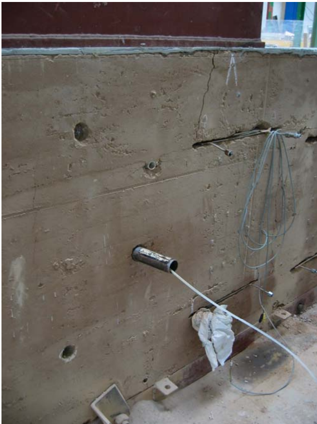
Fig. 4.5.159: Instante captado durante la ejecución del ensayo mini-presurómetro DILTap1.
