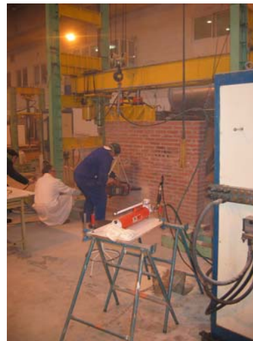
Fig. 4.3.83 y 4.3.84: Ejecución de la segunda roza, paralela con la realizada para el ensayo de gato plano simple.
