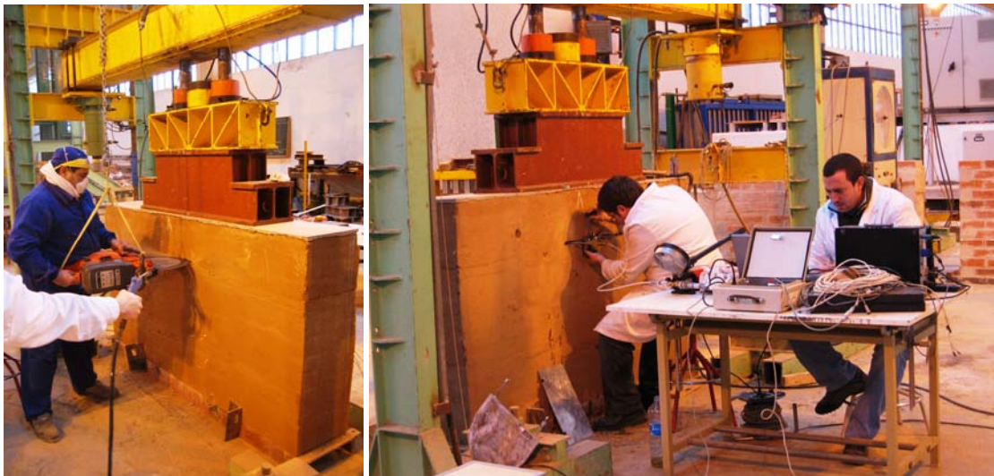
Fig. 4.5.118: Ejecución de la roza para insertar el gato plano simple.
