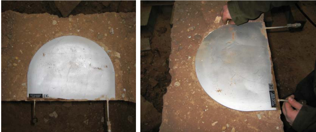
Fig. 4.5.172: Planta en la que puede comprobarse la posición relativa del gato plano respecto de la roza.
