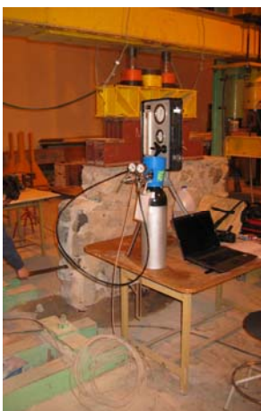
Fig. 4.2.104: Introducción de la sonda presurométrica en la perforación realizada (DILM2).
