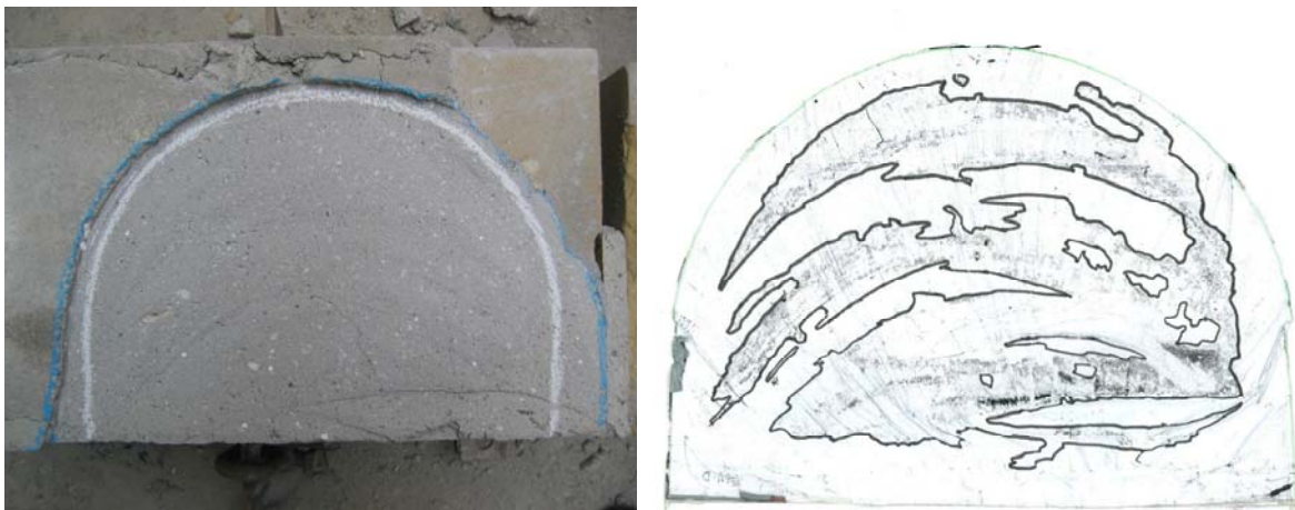
Fig. 4.1.258: Detalle de la posición relativa del gato plano respecto de la roza. Pueden apreciarse los contornos con nitidez.
