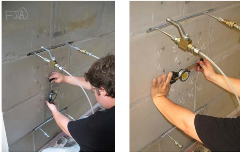
Fig. 4.1.149: Registro de la evolución de la deformación de los puntos de control vertical a lo largo del ensayo GPS-A Doble.
