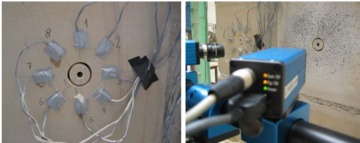
Fig. 4.1.96: Instante tomado durante el ensayo hole drilling realizado mediante extensometría resistiva (HDS8), en el Laboratorio de Estructuras de la Universidad de Cantabria. La profundidad del taladro fue de 37.97 cm.
