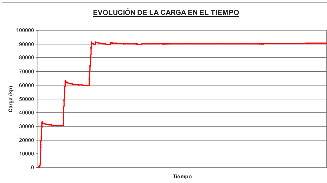
Fig. 4.1.48: Introducción de la carga durante el ensayo. El nivel medio de carga vertical mantenido constante en la cabeza del muro fue de 90,319.8 kp.
