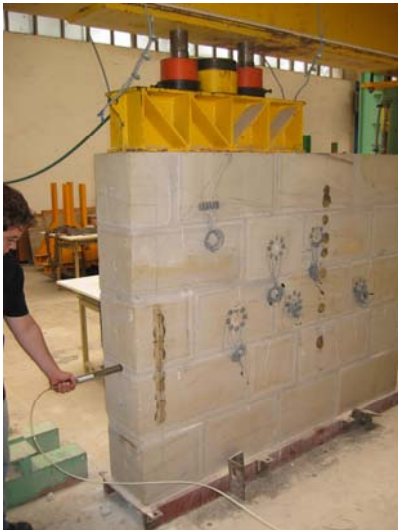
Fig. 4.1.241: Introducción de la sonda mini-presurométrica en la perforación realizada.
