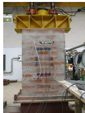
Fig. 4.4.10: Instante captado durante la ejecución de la roza para la inserción del gato plano inferior.
