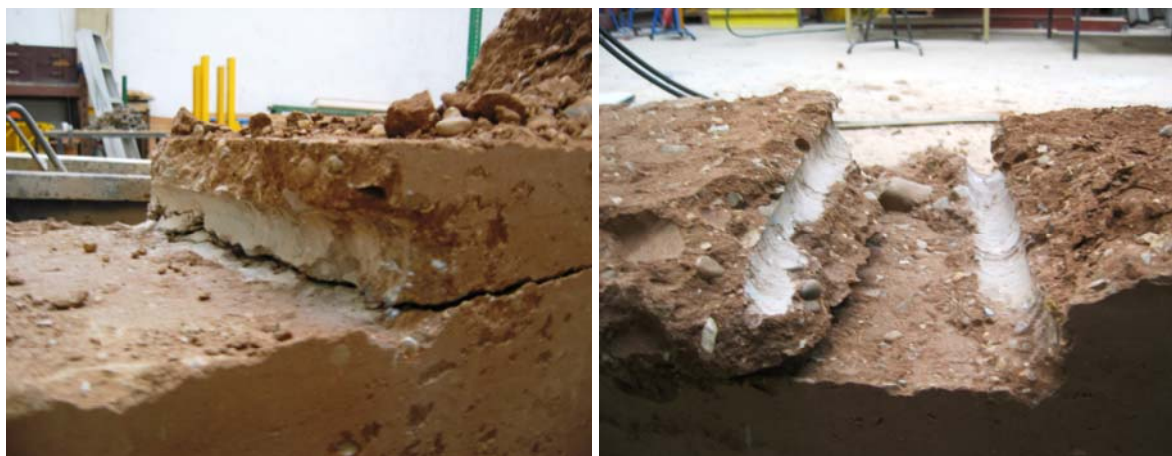
Fig. 4.5.182: Detalle de la huella dejada por la perforación del mini-presurómetro DILTap1.
