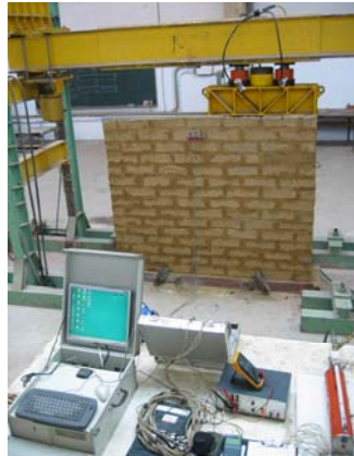
Fig. 4.6.23: Detalle de la numeración de los transductores dispuestos en el muro de adobe para estimar el ángulo de apertura de carga.
