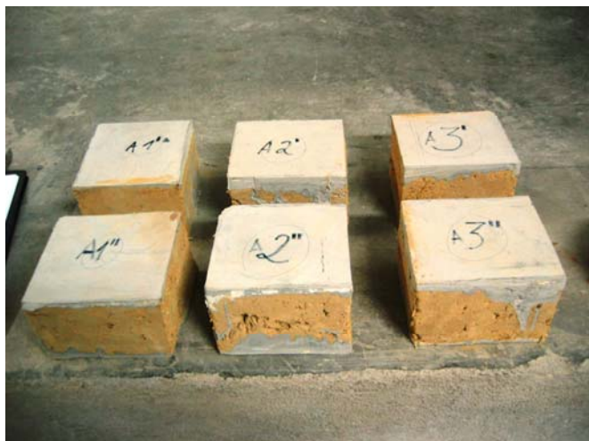
Fig. 4.6.10: Detalle de las seis probetas obtenidas de tres adobes previamente a su ensayo.
