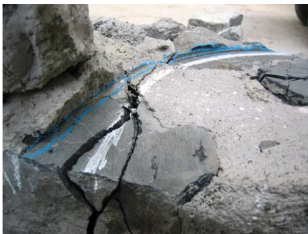
Fig. 4.2.119: Detalle de la posición relativa del gato plano GPMD1-Inferior respecto de la roza. Pueden apreciarse los contornos con nitidez.
