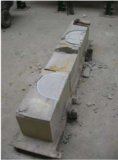
Fig. 4.1.270: Detalle de la posición de los gatos planos GPS-B Inferior (superior-derecha) y GPS-A Inferior (inferior-izquierda) en una fase avanzada del proceso de demolición.
