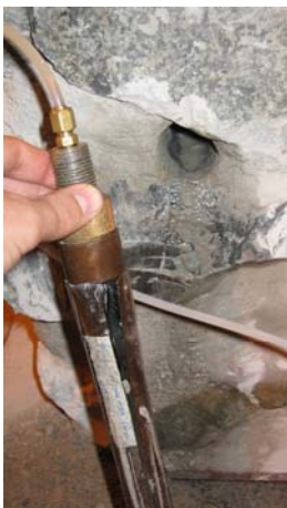
Fig. 4.2.101 y 4.2.102: Detalles de la rotura de la sonda.
