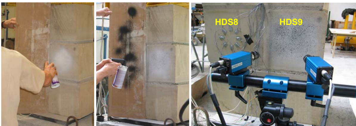
Fig. 4.1.115 y 4.1.116: Definición del patrón aleatorio de referencia mediante spray.
