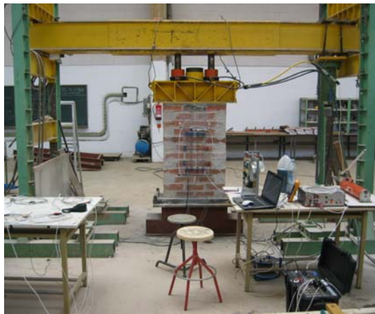
Fig. 4.4.31: Instante captado durante la ejecución de la rozas para la inserción del gato plano superior del ensayo nº 3.
