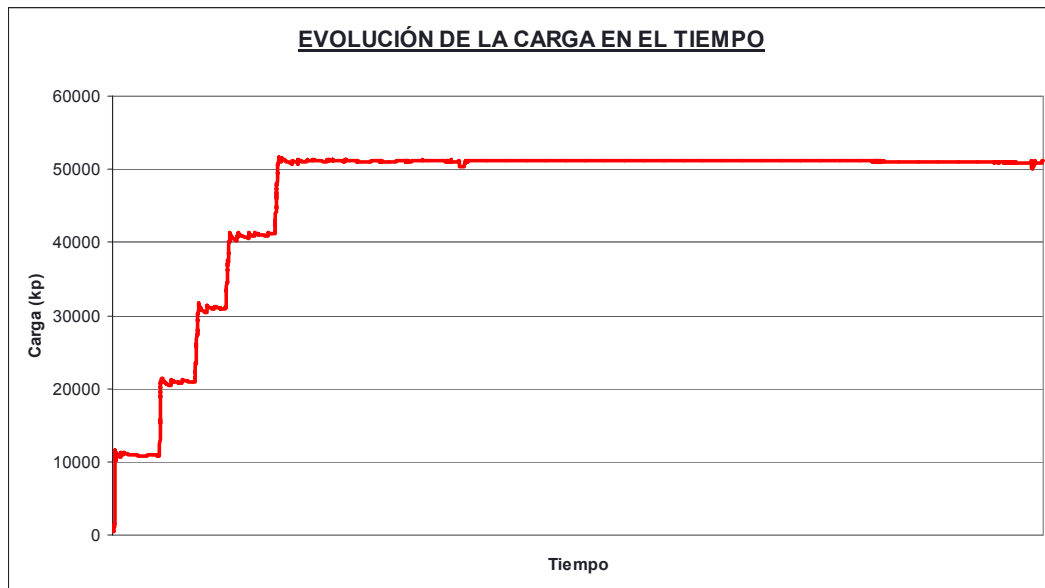
Fig. 4.2.44: Introducción de la carga durante el ensayo. El nivel medio de carga vertical mantenido constante en la cabeza del muro fue de 51,095.9 kp.
