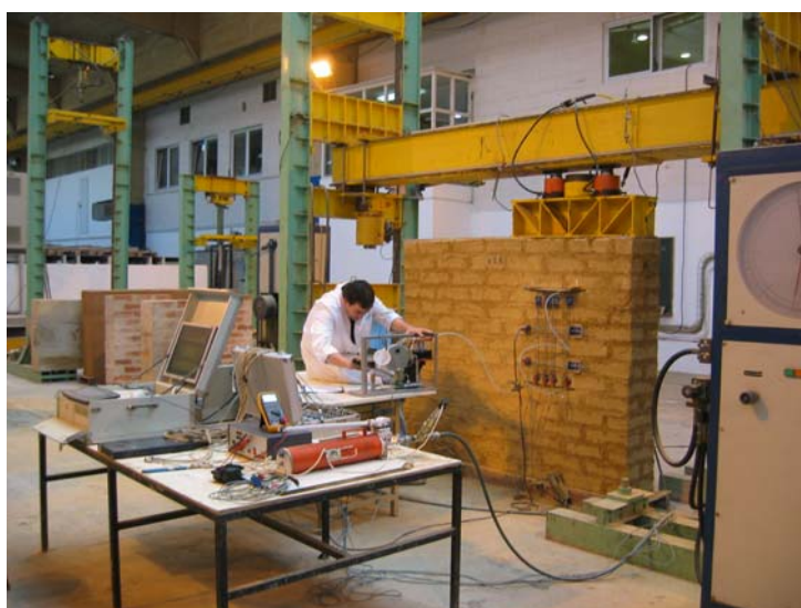
Fig. 4.6.36: Configuración general de un ensayo de gato plano doble con registro de la presión y de los desplazamientos mediante transductores.
