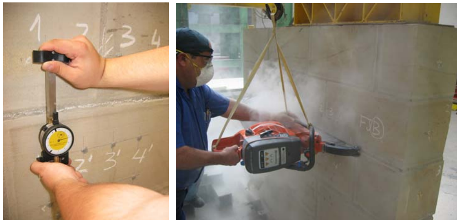
Fig. 4.1.158: Medida de la distancia inicial previamente a la ejecución de la roza.
