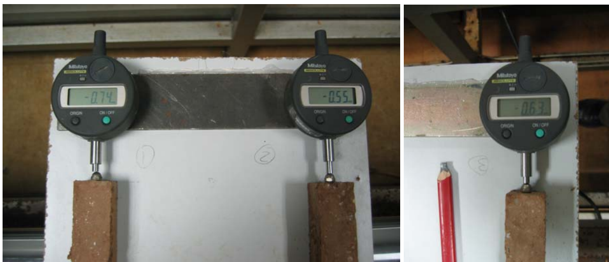
Fig. 4.5.64 y 4.5.65: Acortamientos registrados por las tres muestras el día 15-06-09 a las 9:00h.
