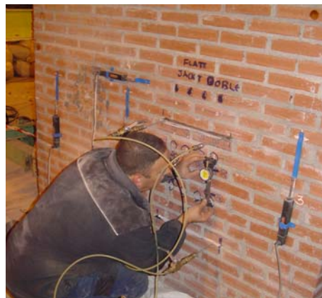
Fig. 4.3.68: Registro del movimiento de los puntos verticales.
