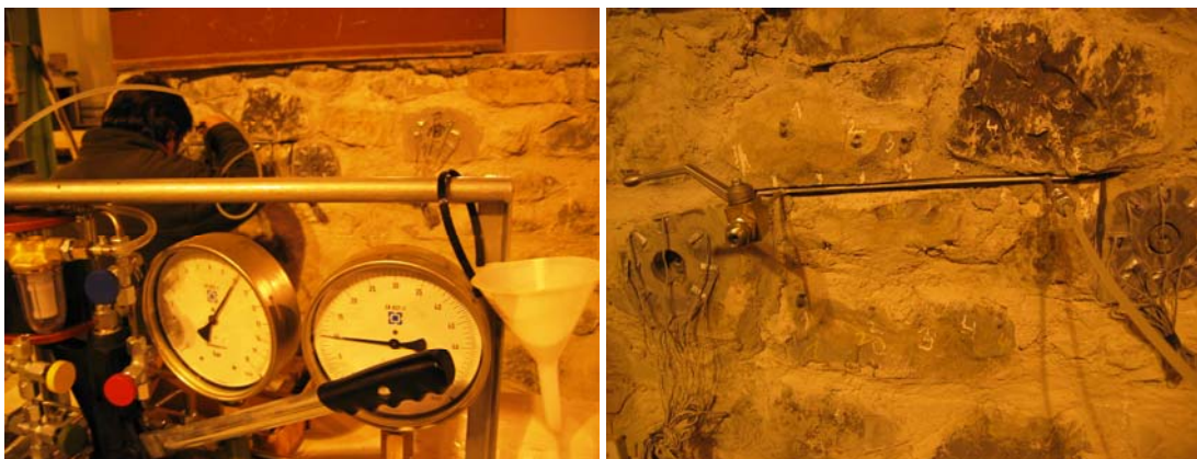
Fig. 4.2.75: Proceso de presurización del gato plano y control de la evolución de las deformaciones experimentas por los puntos de control.
