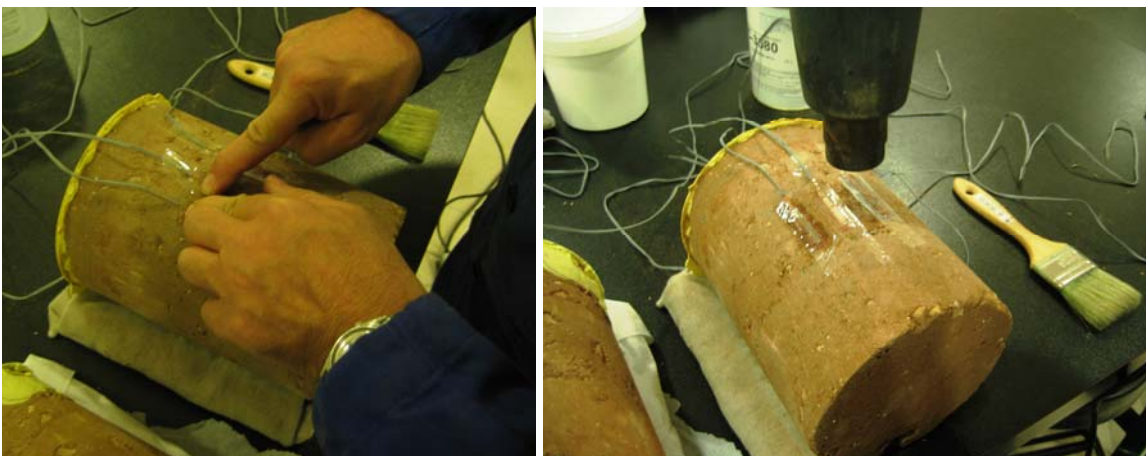
Fig. 4.5.93: Instante durante la unión por contacto de la galga adherida mediante C-3580 (previamente se adhirió la fijada con C-3580).
