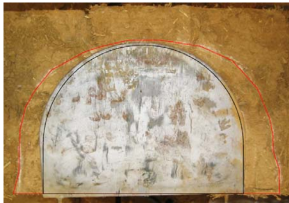
Fig. 4.6.104: Detalle de la posición relativa del gato plano respecto de la roza.
