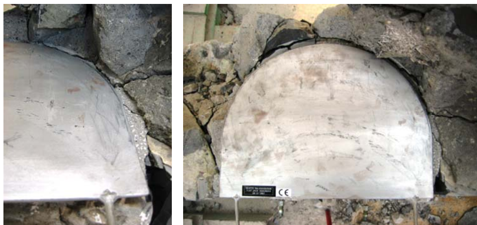
Fig. 4.2.111: Detalle de la posición relativa del gato plano respecto de la roza. Pueden apreciarse los contornos con nitidez.
