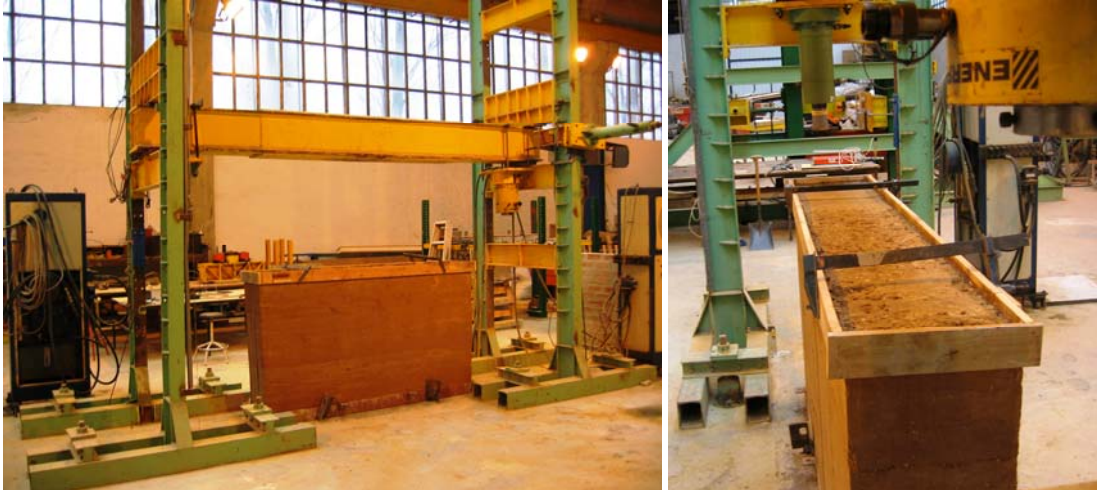
Fig. 4.5.51: Tapial dispuesto bajo el pórtico de carga (emplazamiento definitivo de los ensayos).
