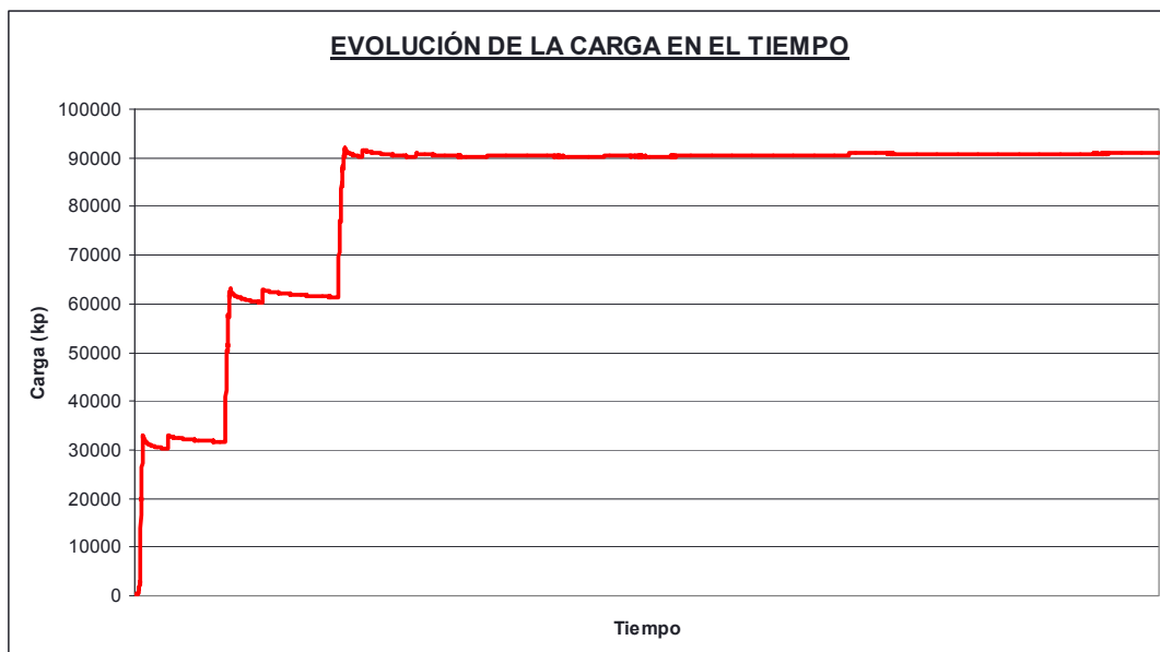
Fig. 4.1.59: Introducción de la carga durante el ensayo. El nivel medio de carga vertical mantenido constante en la cabeza del muro fue de 90,563.7 kp.
