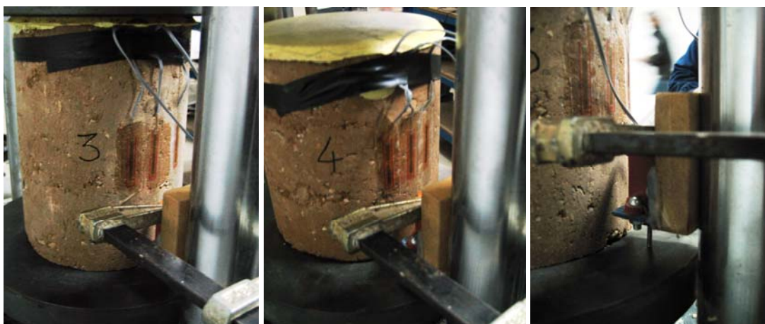
Fig. 4.5.96 y 4.5.97: Detalle de las dos probetas ensayadas a compresión simple para verificar la posible idoneidad de los adhesivos empleados para fijar las galgas a su superficie.
