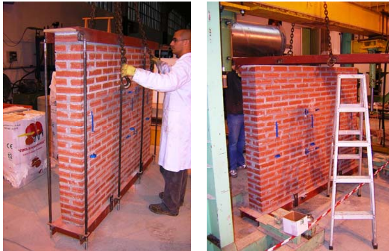
Fig. 4.3.7: Detalle de parte de las barras para introducir un leve pretensado en le muro con la finalidad de generarle daño durante el transporte.
