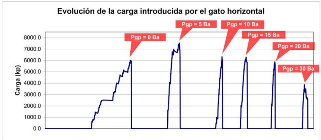
Fig. 4.3.107: Evolución de la carga introducida por el gato hidráulico horizontal. Se indica, para cada ciclo de carga, el nivel de tensión de compresión vertical existente, introducido por los gatos planos ( P_{gp} ).
