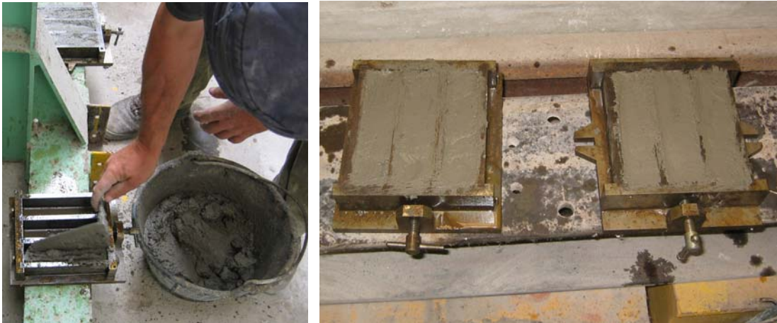
Fig. 4.3.4 y 4.3.5: Instantes tomados durante la ejecución de probetas prismáticas (160 x 40 x 40 mm) de mortero M-80a.
