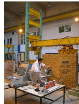
Fig. 4.6.66: Detalle de la posición del transductor (en rojo) para control de la presión introducida, manualmente, en los gatos planos.
