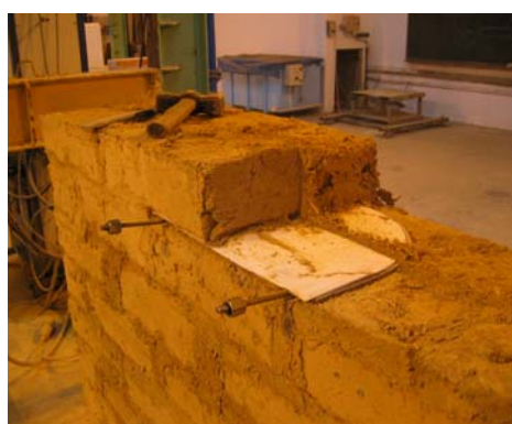
Fig. 4.6.94: Detalle de la posición del gato plano GPAd-A-Superior en fase de demolición del muro de adobe.
