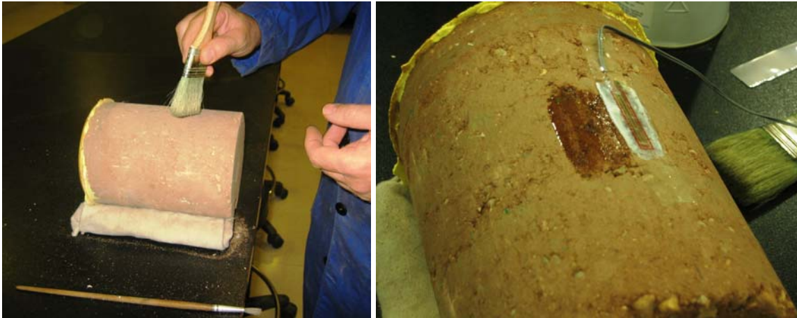
Fig. 4.5.91: Limpieza de las superficies de las probetas de tierra para liberarles de polvo y suciedad.
