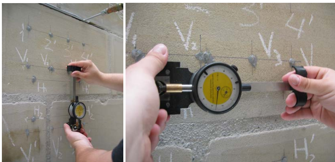
Fig. 4.1.173: Registro de la evolución de la deformación de los puntos de control vertical a lo largo del ensayo GPS-B Doble.
