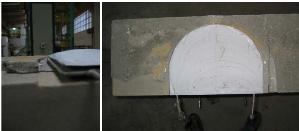
Fig. 4.1.247: Detalle de la posición relativa del gato plano respecto de la roza. Pueden apreciarse los contornos con nitidez.
