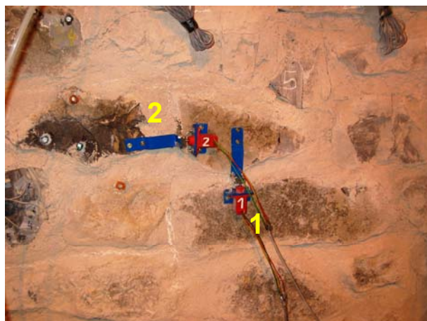
Fig. 4.2.19: Ubicación de los transductores dentro del alzado del muro.
