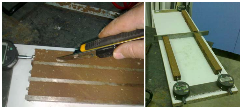
Fig. 4.5.62: Desmoldeo de las probetas.
