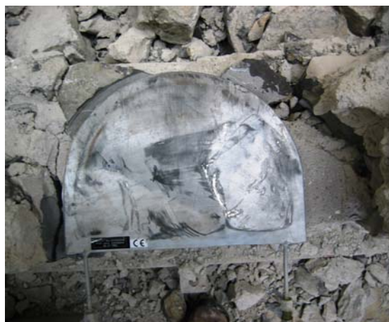
Fig. 4.2.117: Deformación residual existente en el gato plano GPMD1-Inferior tras la realización del ensayo.
