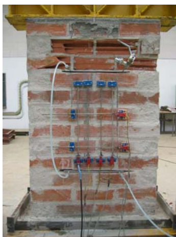
Fig. 4.4.34-4.4.36: Detalle de la rotura generada en la porción de fábrica aislada entre el gato plano superior y la viga de reacción.
