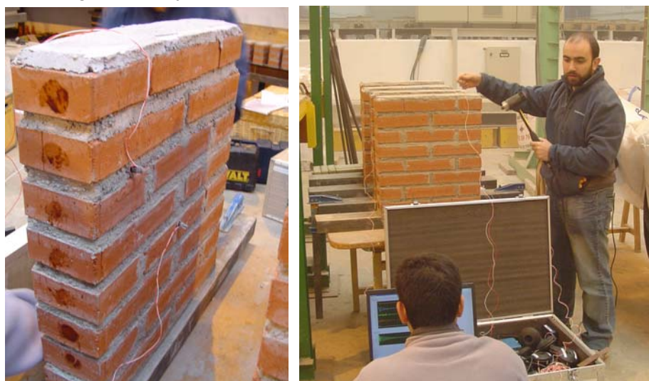
Fig. 4.3.121 y 4.3.122: Instantes de la auscultación sónica mediante equipo sónico multicanal.
