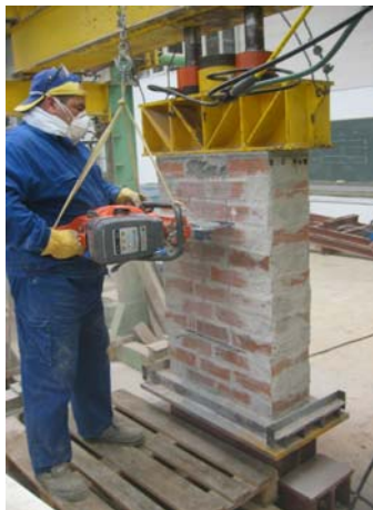
Fig. 4.4.31: Instante captado durante la ejecución de la rozas para la inserción del gato plano superior del ensayo nº 3.
