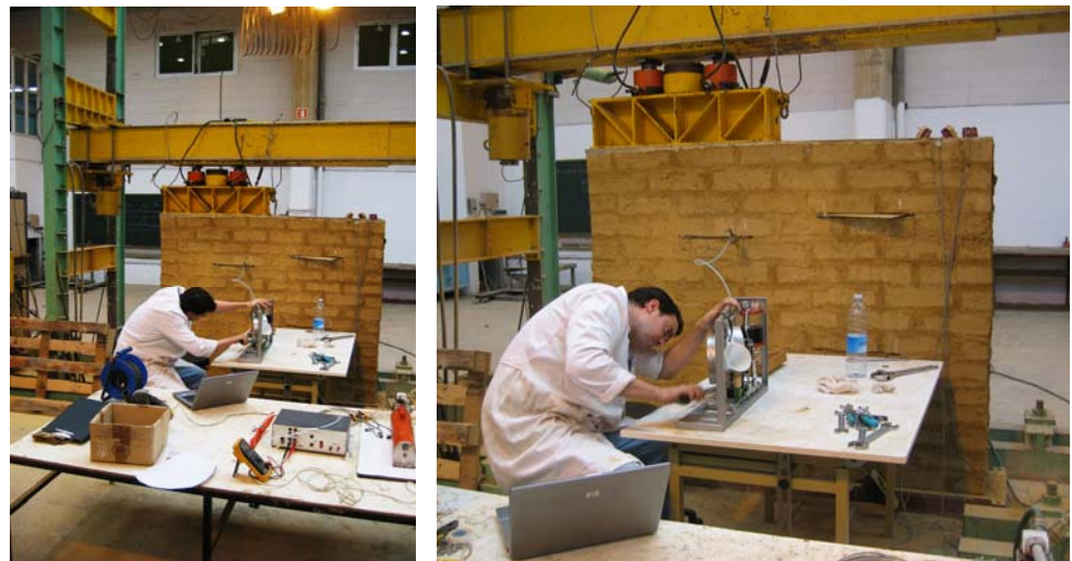
Fig. 4.6.44 y 4.6.45: Proceso de presurización del gato plano y control de la evolución de las deformaciones experimentales por los puntos de control.
