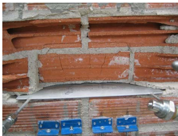
Fig. 4.4.34-4.4.36: Detalle de la rotura generada en la porción de fábrica aislada entre el gato plano superior y la viga de reacción.
