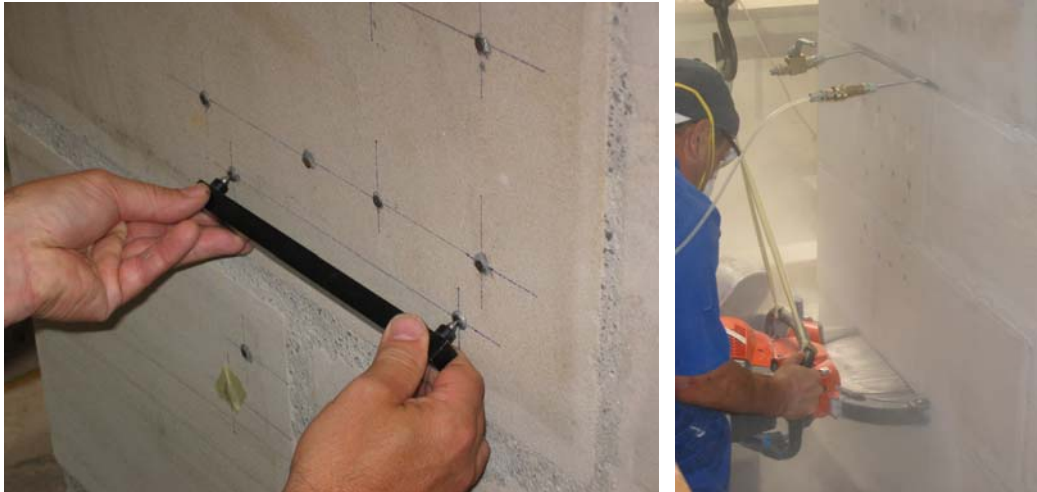
Fig. 4.1.145: Instante tomado durante el pegado de los puntos de control relacionados con el ensayo GPS-A Doble.
