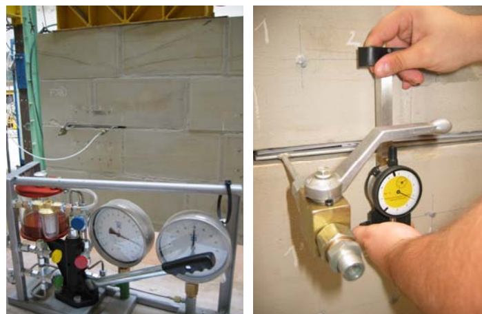
Fig. 4.1.141 y 4.1.142: Proceso de presurización del gato plano y control de la evolución de las deformaciones experimentas por los puntos de control.
