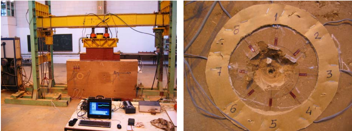
Fig. 4.5.156: Detalle de la localización, dentro del tapial, del ensayo HDTap3.
