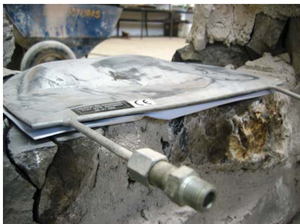
Fig. 4.2.117: Deformación residual existente en el gato plano GPMD1-Inferior tras la realización del ensayo.
