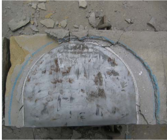
Fig. 4.1.270: Detalle de la posición de los gatos planos GPS-B Inferior (superior-derecha) y GPS-A Inferior (inferior-izquierda) en una fase avanzada del proceso de demolición.
