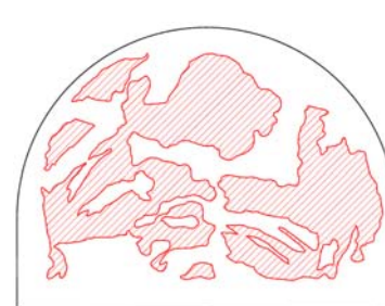
Fig. 4.2.84: Área de contacto entre el gato plano superior del ensayo GPMD1 y el muro ( 323.00 \text{ cm}^2 ).
