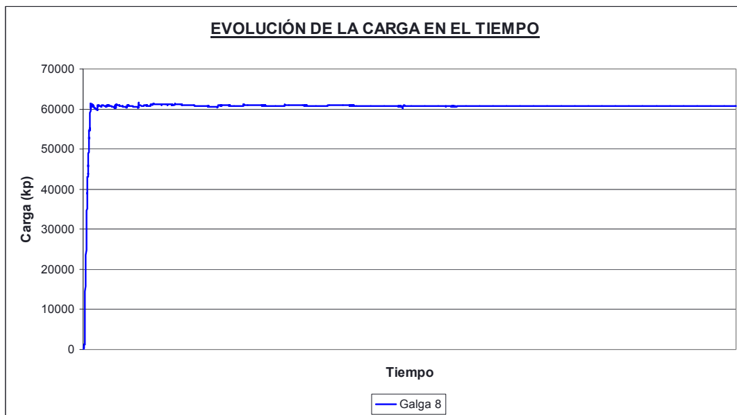
Fig. 4.1.100: Introducción de la carga durante el ensayo. El nivel medio de carga vertical mantenido constante en la cabeza del muro fue de 60,808.2 kp.
