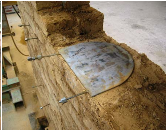
Fig. 4.6.102: Detalle de la posición del gato plano GPS-B-Superior en fase de demolición del muro de adobe.
