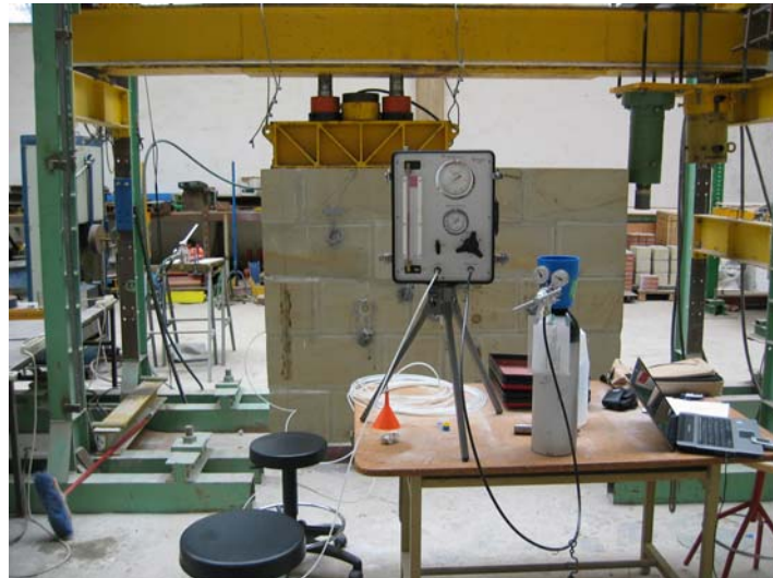
Fig. 4.1.241: Introducción de la sonda mini-presurométrica en la perforación realizada.
