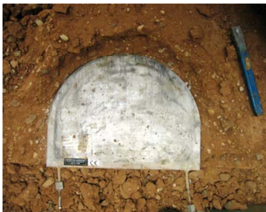
Fig. 4.5.180: Planta en la que puede comprobarse la posición relativa del gato plano GPTap-Doble-Inferior respecto de la roza.
