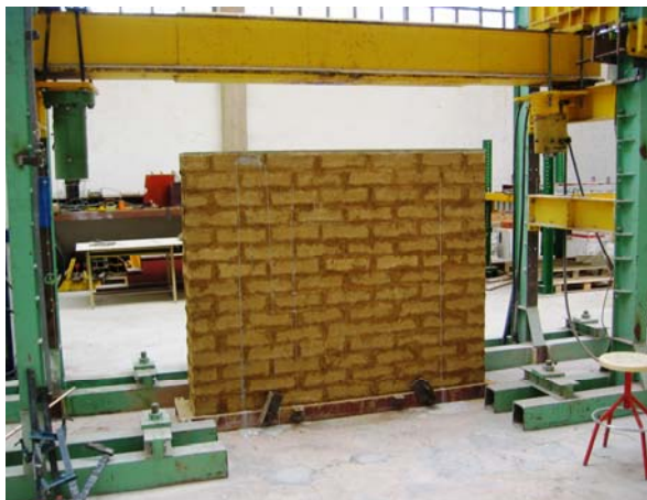
Fig. 4.6.8: Muro de adobe dispuesto bajo el pórtico de carga.
