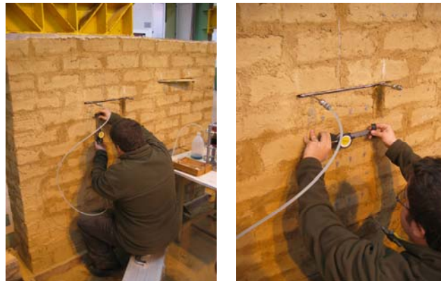
Fig. 4.6.52: Registro de la evolución de la deformación de los puntos de control vertical a lo largo del ensayo GPAd-A Doble.
