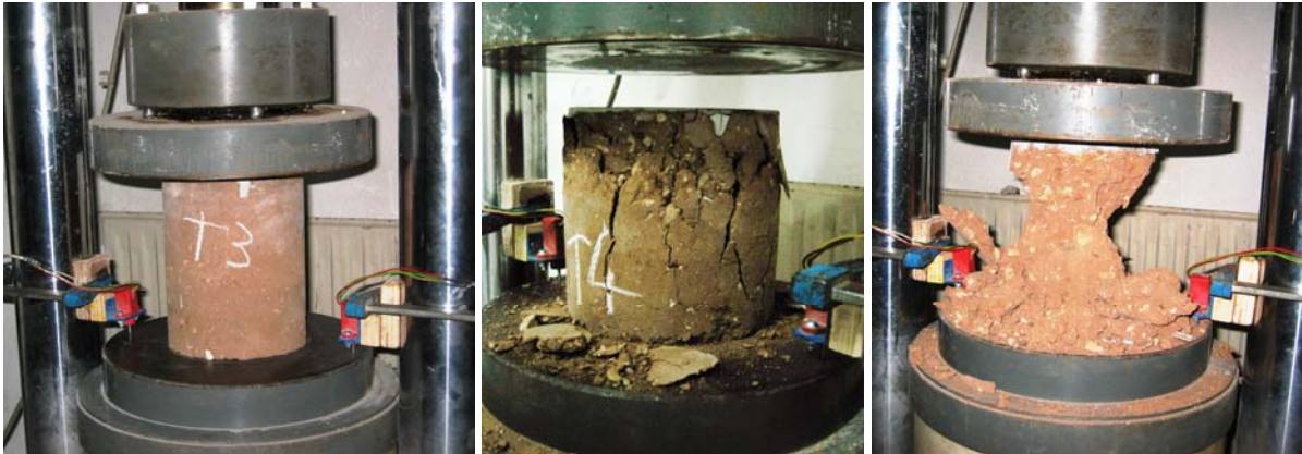
Fig. 4.5.68, 4.5.69 y 4.5.70: Fotografías de detalle de los ensayos realizados en las probetas T3, T4 y T5 para estimar la resistencia a compresión del tapial.
