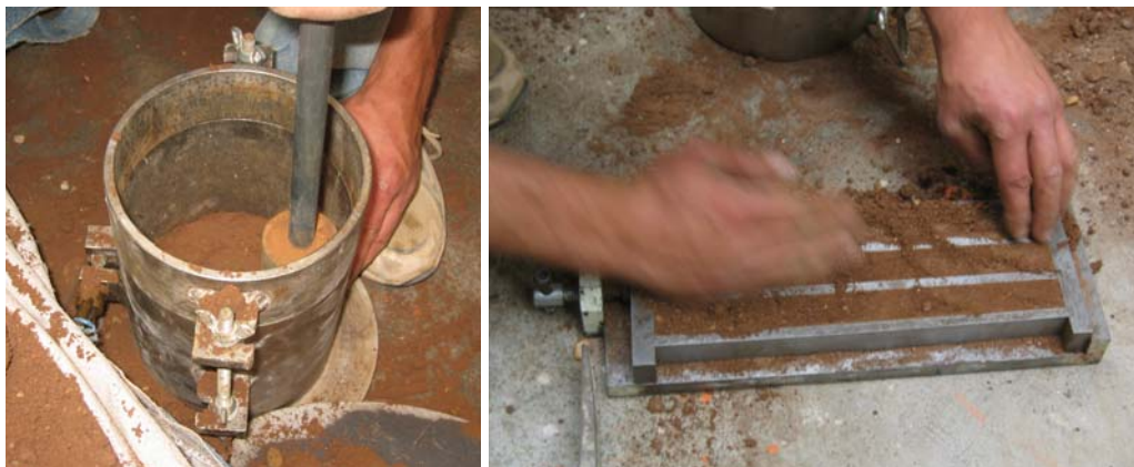
Fig. 4.5.59: Construcción de las probetas cilíndricas en moldes para la determinación del CBR.
