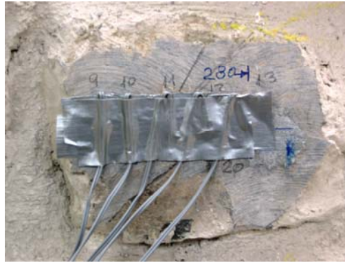
Fig. 4.2.12-4.2.13: Detalle de la numeración de dichas galgas en el proceso de toma de datos y fotografía ilustrativa de la ubicación de las mismas.
