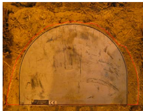
Fig. 4.6.65: Replanteo de la posición de la roza (de área 924.09 cm 2 ) respecto del gato plano inferior GPAd-B Doble (778.56 cm 2 ).
