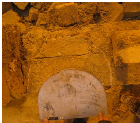
Fig. 4.6.108: Contornos de la roza y del gato plano GPAd-B-Inferior.
