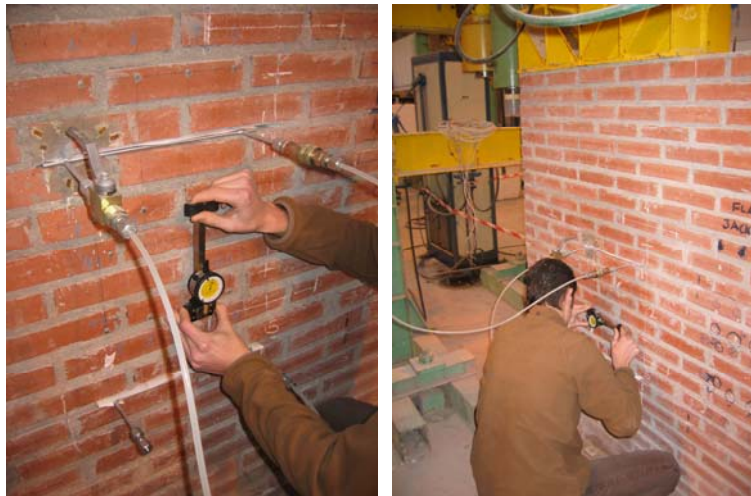
Fig. 4.3.85: Registro del movimiento de los puntos verticales.
