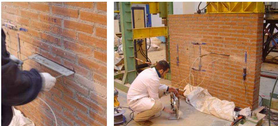
Fig. 4.3.62: Instante durante la introducción del gato plano rectangular.
