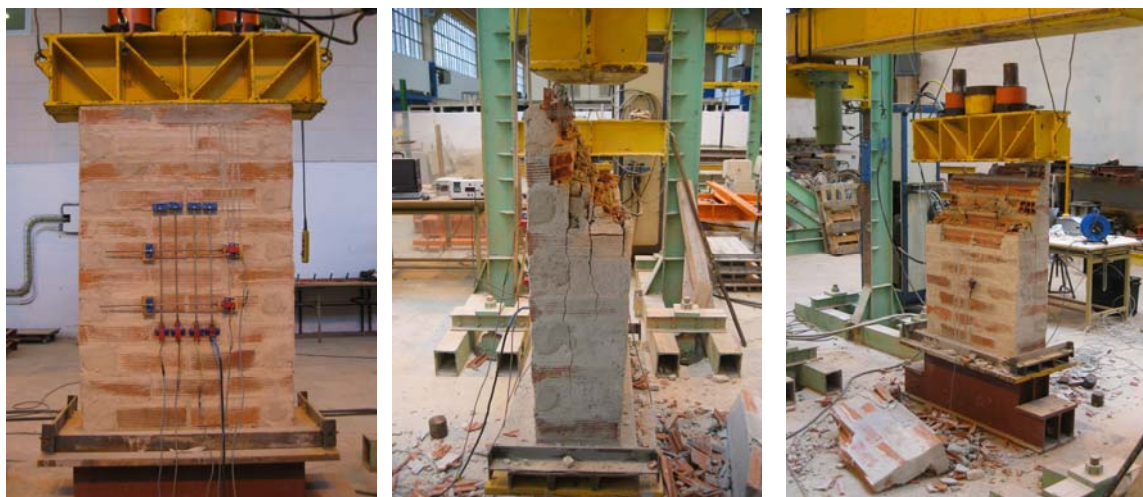
Fig. 4.4.41: Murete nº 4 instantes previos a la ejecución del ensayo a compresión frente a cargas pseudo-dinámicas hasta rotura (ensayo nº 4).
