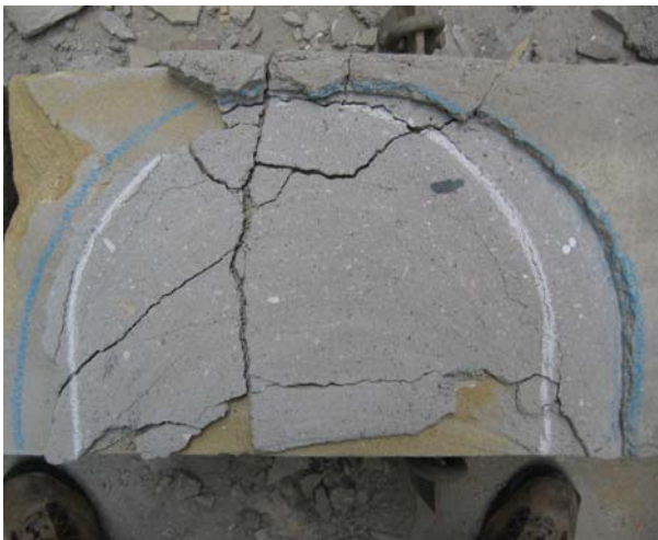
Fig. 4.1.272: Detalle de la posición relativa del gato plano GPS-B Superior respecto de la roza. Pueden apreciarse los contornos con nitidez.
