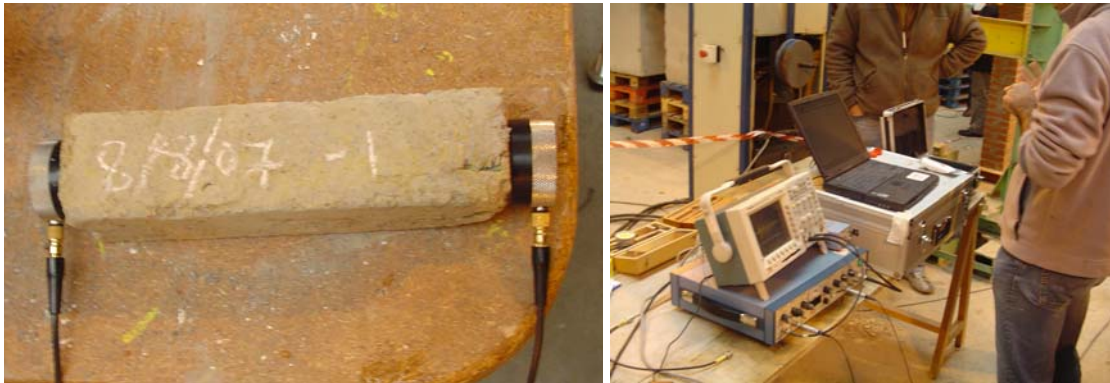
Fig. 4.3.118: Caracterización de morteros similares a los empleados en muros de fábrica de ladrillo, probetas de dimensiones aproximadas 160 x 40 x 40 mm (largo x ancho x alto), mediante inspección ultrasónica.
