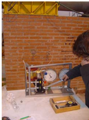
Fig. 4.3.77: Toma de lecturas de los movimientos de los puntos de control verticales.
