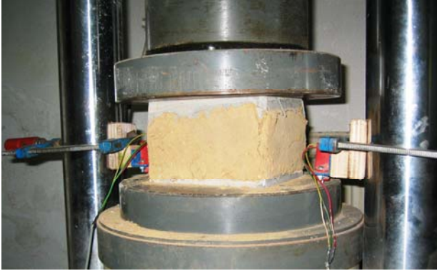
Fig. 4.6.12: Detalle de uno de los ensayos de compresión realizados sobre una de las probetas de adobe.
