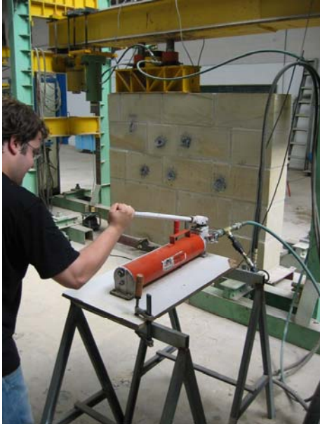
Fig. 4.1.131: Puesta en carga del muro.
