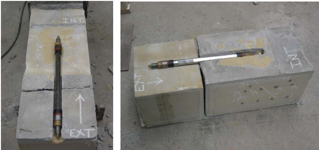
Fig. 4.1.281 y 4.1.282: Posición relativa de la sonda respecto de la perforación del ensayo mini-presurométrico DILS1.
