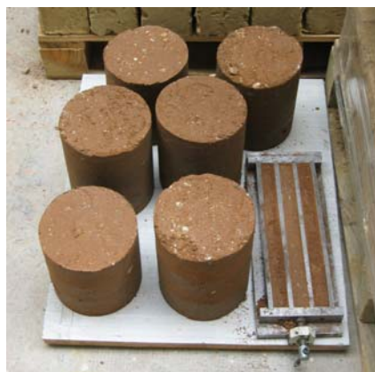
Fig. 4.5.59: Construcción de las probetas cilíndricas en moldes para la determinación del CBR.
