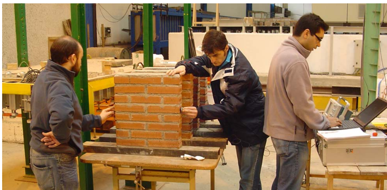
Fig. 4.3.120: Instante captado durante la inspección ultrasónica en cada fila de ladrillos de los muretes, en este caso atravesando una llaga de mortero.
