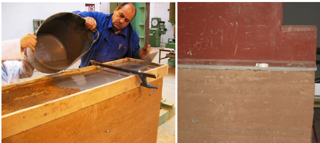
Fig. 4.5.53 y 4.5.54: Vertido de la capa de hormigón autonivelante y detalle del refrentado junto con el apoyo de la viga de reparto de carga.
