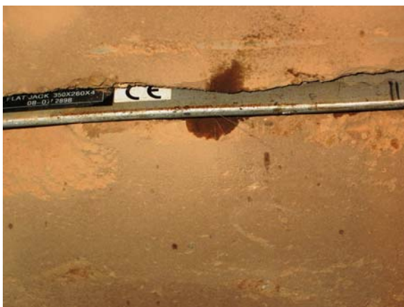
Fig. 4.5.131 y 4.5.132: Detalle de las pérdidas de fluido hidráulico por una de las juntas soldadas del gato plano inferior.
