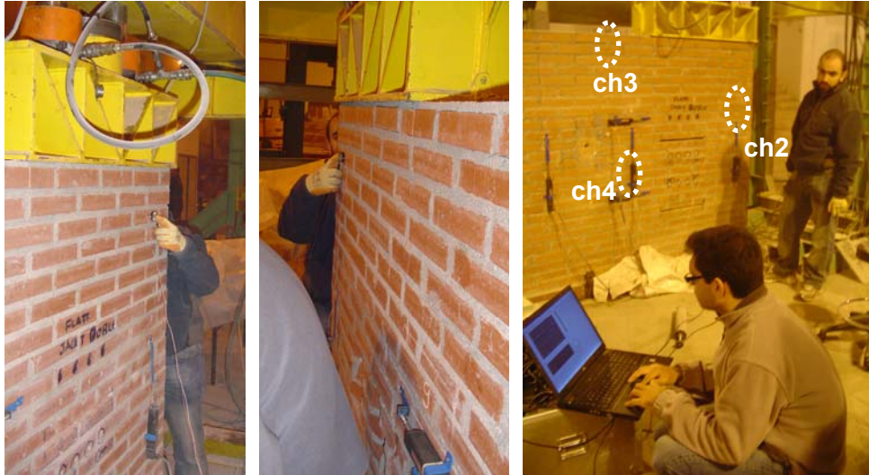
Fig. 4.3.127 y 4.3.128: Instantes captados durante la inspección ultrasónica.
