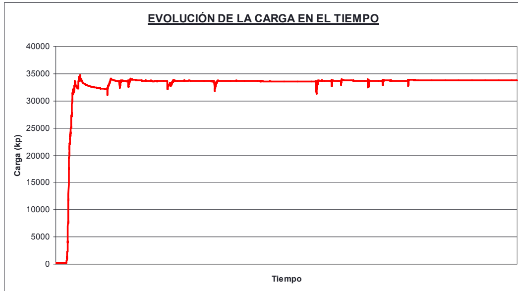
Fig. 4.2.36: Introducción de la carga durante el ensayo. El nivel medio de carga vertical mantenido constante en la cabeza del muro fue de 33,674.4 kp.
