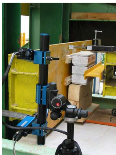
Fig. 4.1.129: Instante captado durante el ensayo de un triplete de fábrica de ladrillo frente a mecanismos de corte.
