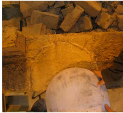
Fig. 4.6.97: Relación gráfica entre el área de la roza (898.61 cm 2 ) y área del gato plano doble GPAd-A-Superior, correspondiente en posición con el ensayo GPAd-Simple (778.56 cm 2 ).
