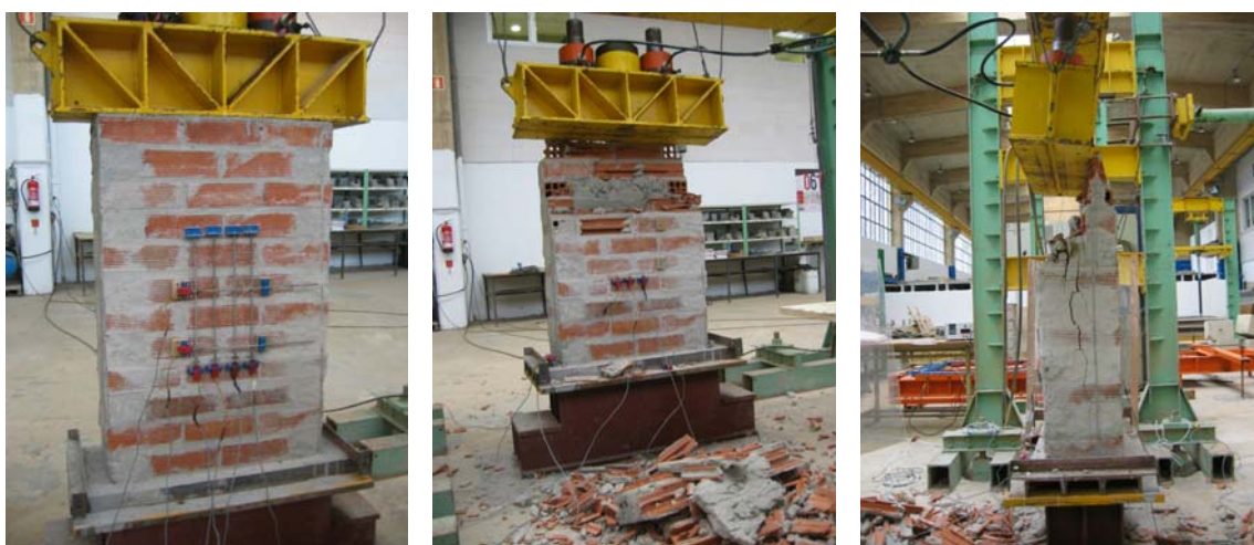
Fig. 4.4.4: Murete nº 1. Instantes previos a la ejecución del ensayo a compresión frente a carga monotónica creciente hasta rotura.
