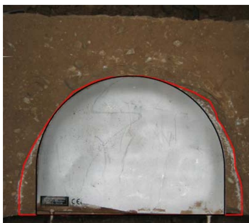
Fig. 4.5.127: Relación gráfica entre el área de la roza ( 874.06 \text{ cm}^2 ) y área del gato plano superior del ensayo GPTap-Doble ( 778.56 \text{ cm}^2 ).
