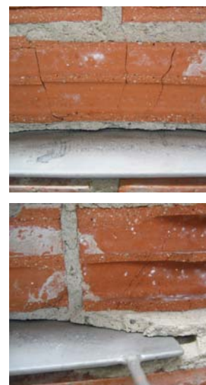
Fig. 4.4.34-4.4.36: Detalle de la rotura generada en la porción de fábrica aislada entre el gato plano superior y la viga de reacción.
