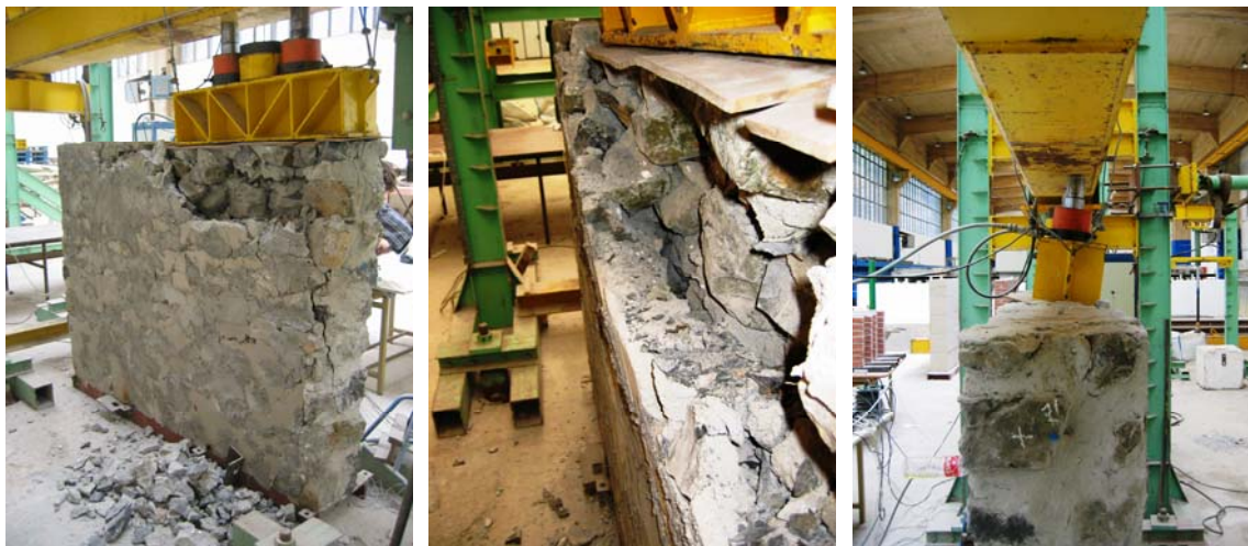
Fig. 4.2.65-4.2.67: Diferentes perspectivas del colapso local de la cabeza del muro de mampostería.
