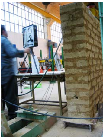
Fig. 4.6.80: Detalle general de la perforación realizada, mientras se está llevando a cabo el montaje del dispositivo para la realización del mini-presurometro DILAd1.
