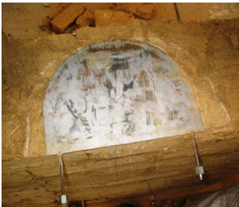
Fig. 4.6.104: Detalle de la posición relativa del gato plano respecto de la roza.
