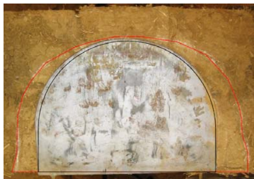
Fig. 4.6.64: Replanteo de la posición de la roza (de área 1,043.60 cm 2 ) respecto del gato plano superior GPAd-B Doble (778.56 cm 2 )
