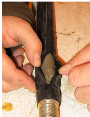
Fig. 4.2.101 y 4.2.102: Detalles de la rotura de la sonda.
