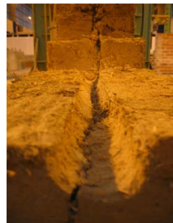
Fig. 4.6.111: Perspectiva de la huella dejada por la perforación tanto en la hilada de adobe inferior como en la superior.
