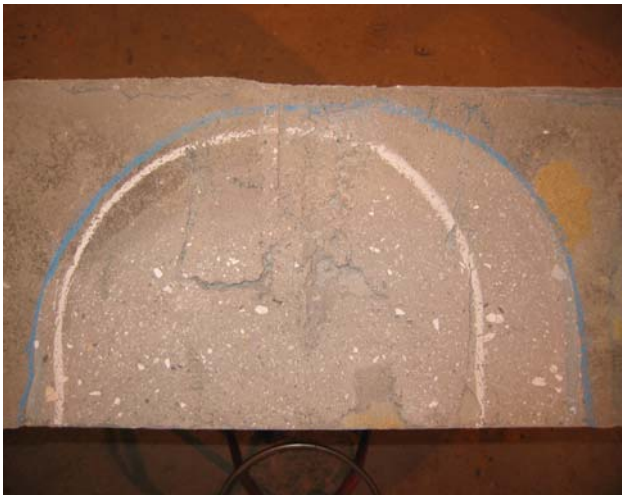
Fig. 4.1.266: Detalle de la posición relativa del gato plano GPS-B Superior respecto de la roza. Pueden apreciarse los contornos con nitidez.
