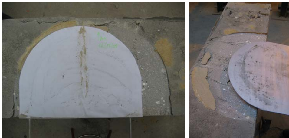
Fig. 4.1.264 y 4.1.265: Detalle de la posición relativa del gato plano GPS-B Superior respecto de la roza.
