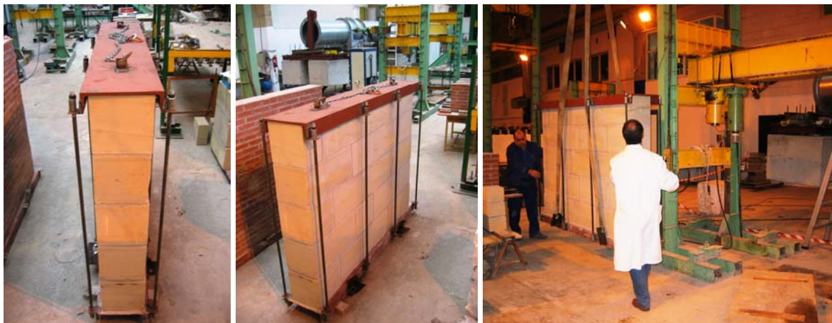
Fig. 4.1.9 y 4.1.10: Detalles del mecanismo de transporte una vez montado en el muro de sillería.
