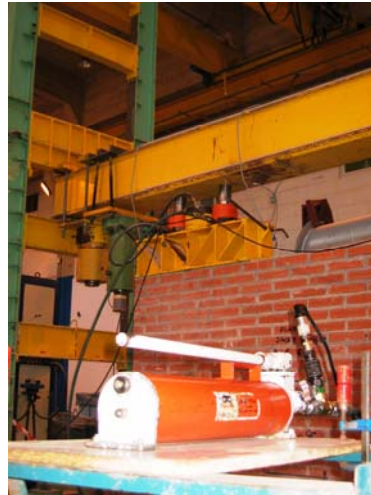
Fig. 4.3.81: Vista general de la bomba manual para la puesta en carga del muro.
