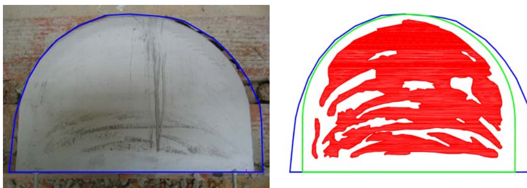
Fig. 4.4.20: Replanteo del área de la roza ( 851.89 \text{ cm}^2 ), el área del gato plano inferior ( 778.56 \text{ cm}^2 ) y el área de contacto entre el gato plano del ensayo y el muro ( 430.40 \text{ cm}^2 ).
