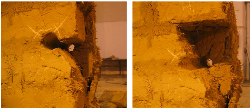
Fig. 4.6.113 y 4.6.114: Detalle de la perforación relacionada con el ensayo DILAd2. Pueden apreciarse las grietas radiales remanentes del ensayo en los adobes circundantes a dicha perforación.
