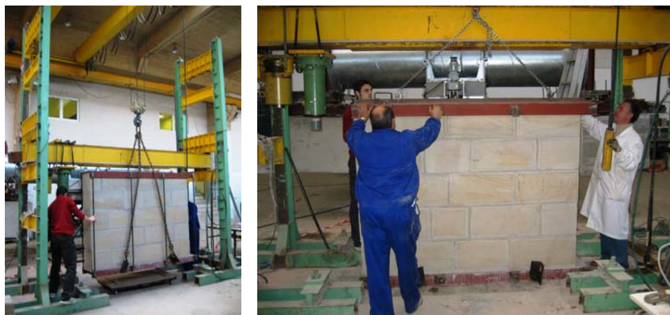
Fig. 4.1.12: El muro acaba de posicionarse bajo el pórtico de carga mediante un carrito, el cuál era removido con posterioridad.
