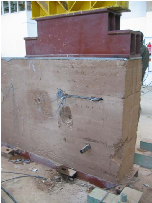
Fig. 4.5.163: Instante captado durante la ejecución del ensayo mini-presurómetro DILTap2.
