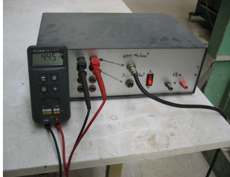
Fig. 4.1.132: Nivel de voltaje introducido en la cabeza del muro, equivalente a 26.5 toneladas.
