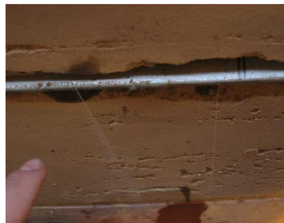
Fig. 4.5.131 y 4.5.132: Detalle de las pérdidas de fluido hidráulico por una de las juntas soldadas del gato plano inferior.
