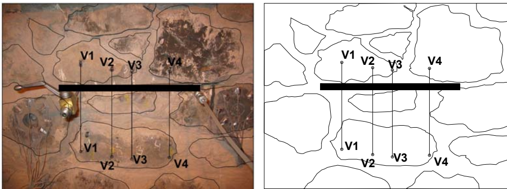
Fig. 4.2.73 y 4.2.74: Croquis del área de ensayo de gato plano simple realizado.
