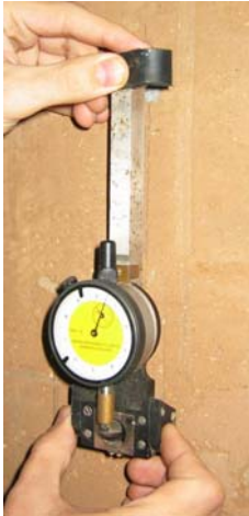
Fig. 4.5.139: Instante captado durante el registro de la deformación experimentada por el punto de control fijado al tapial en el área de ensayo en la que con posterioridad se realizaría el ensayo HDTap1
