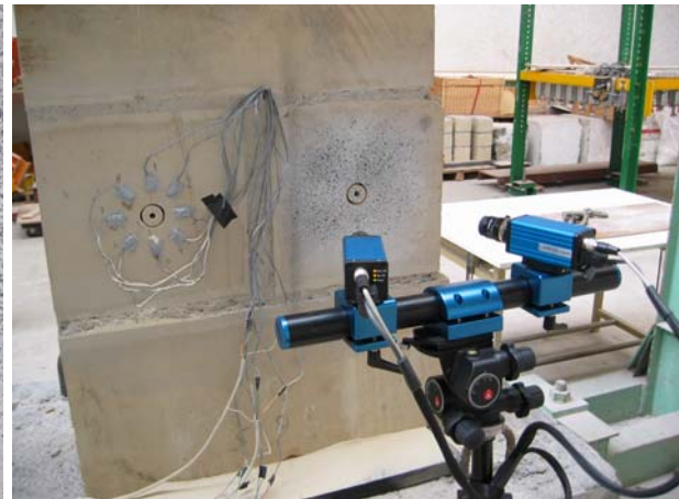
Fig. 4.1.122: Detalle de la perforación una vez realizada. La profundidad de la misma fue de 37.65 cm (mayor que 0.4 el diámetro definido por el centro de las áreas de control).
