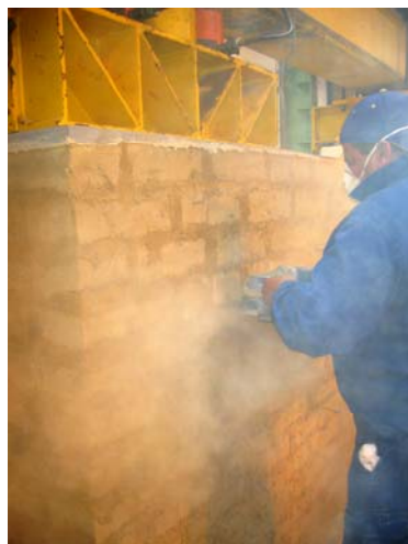
Fig. 4.6.38: Ejecución de una hendidura mediante sierra de disco, para posterior guiado de la sierra orbital.
