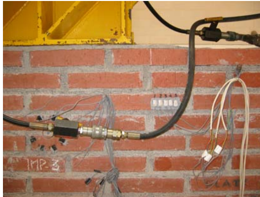
Fig. 4.3.11 y 4.3.12: Detalle de la numeración de dichas galgas en el proceso de toma de datos y fotografía ilustrativa de la ubicación de las mismas.
