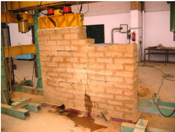
Fig. 4.6.102: Detalle de la posición del gato plano GPS-B-Superior en fase de demolición del muro de adobe.
