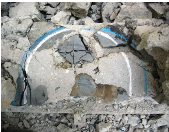
Fig. 4.2.119: Detalle de la posición relativa del gato plano GPMD1-Inferior respecto de la roza. Pueden apreciarse los contornos con nitidez.
