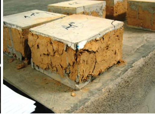
Fig. 4.6.12: Detalle de uno de los ensayos de compresión realizados sobre una de las probetas de adobe.
