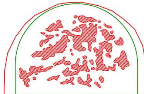
Fig. 4.5.170 y 4.5.171: Replanteo del área de la roza (896.58 cm 2 ), el área del gato plano GPS-A Inferior (778.56 cm 2 ) y el área de contacto entre el gato plano del ensayo y el muro (186.81 cm 2 ).
