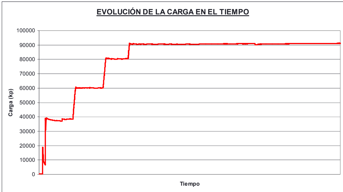
Fig. 4.1.41: Introducción de la carga durante el ensayo. El nivel medio de carga vertical mantenido constante a lo largo del ensayo en la cabeza del muro fue de 90,768.9 kp.
