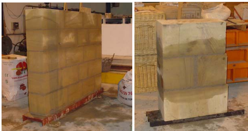
Fig. 4.1.4: Detalle del muro de sillería construido.
