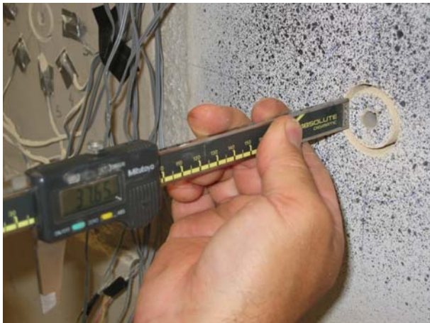
Fig. 4.1.122: Detalle de la perforación una vez realizada. La profundidad de la misma fue de 37.65 cm (mayor que 0.4 el diámetro definido por el centro de las áreas de control).
