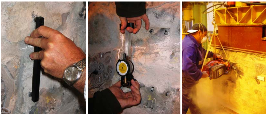
Fig. 4.2.69: Instante tomado durante el pegado de los puntos de control.
