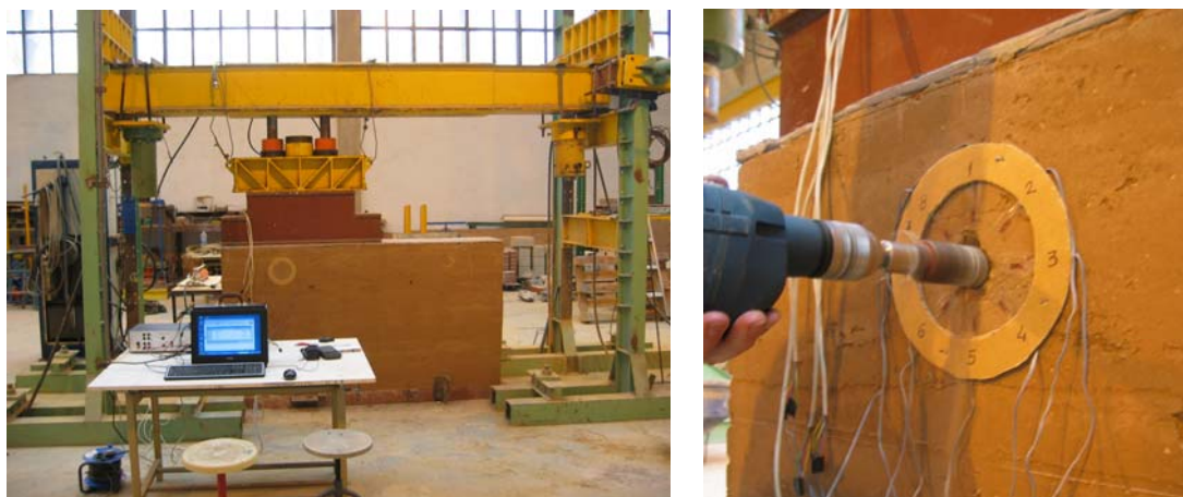
Fig. 4.5.154: Detalle de la localización, dentro del tapial, del ensayo HDTap2.
