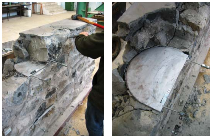
Fig. 4.2.109: Detalle de la posición del gato plano GPMD1-Superior en fase de demolición de la mampostería.
