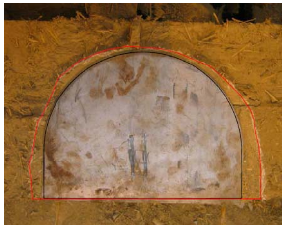
Fig. 4.6.100: Detalle de la huella residual existente en el muro tras la realización del ensayo de gato plano doble, a nivel del GPAd-A-inferior.
