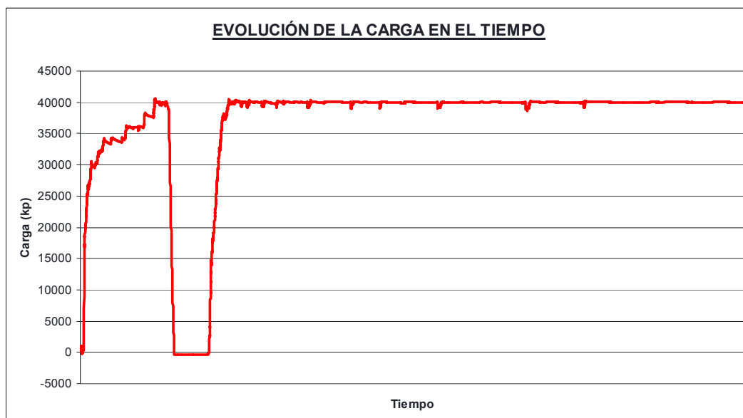
Fig. 4.2.28: Introducción de la carga durante el ensayo. El nivel medio de carga vertical mantenido constante en la cabeza del muro fue de 40,018.5 kp.
