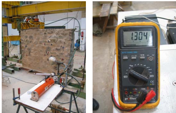
Fig. 4.2.59: Puesta en carga del muro para la ejecución del ensayo de gato plano simple.
