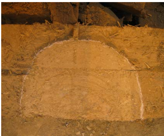
Fig. 4.6.100: Detalle de la huella residual existente en el muro tras la realización del ensayo de gato plano doble, a nivel del GPAd-A-inferior.
