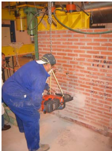
Fig. 4.3.83 y 4.3.84: Ejecución de la segunda roza, paralela con la realizada para el ensayo de gato plano simple.
