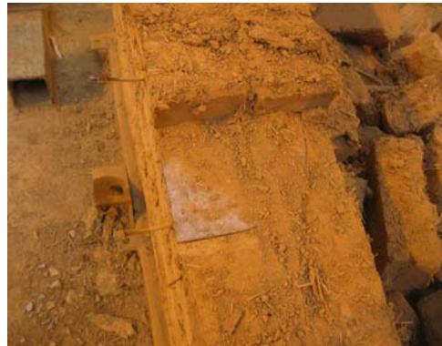
Fig. 4.6.99: Aspecto general de la huella residual existente en el muro tras la realización del ensayo GPAd-A Doble.
