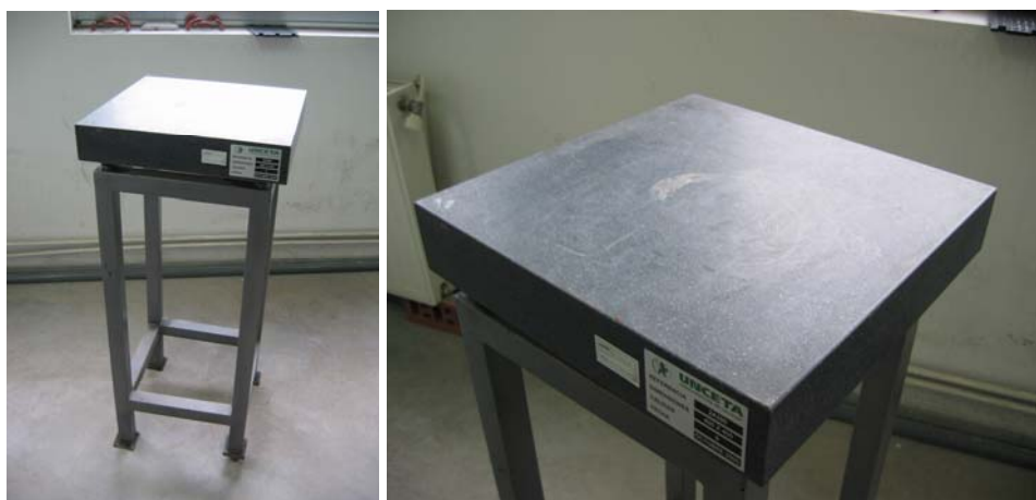
Fig. 4.5.66 y 4.5.67: Mesa de planeidad empleada en el proceso de refrentado de las probetas mediante hormigón autonivelante.
