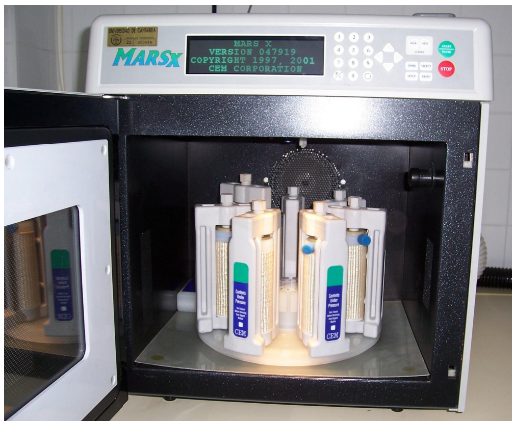
Figura 2.14. Proceso de extracción con microondas de los sedimentos.
