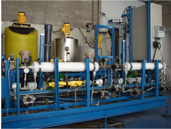
Figura 1.8. Planta piloto de tecnologías de extracción L-L en contactores de fibras huecas.
