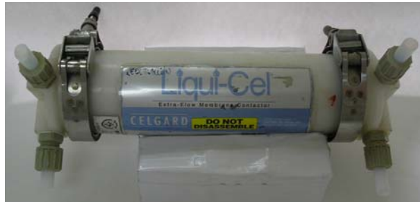
Figura 3.1. Módulo de fibras huecas Liqui-Cel empleado en la experimentación.
