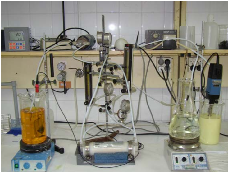
Figura 3.6. Sistema experimental de pertracción en emulsión en módulo de fibras huecas.
