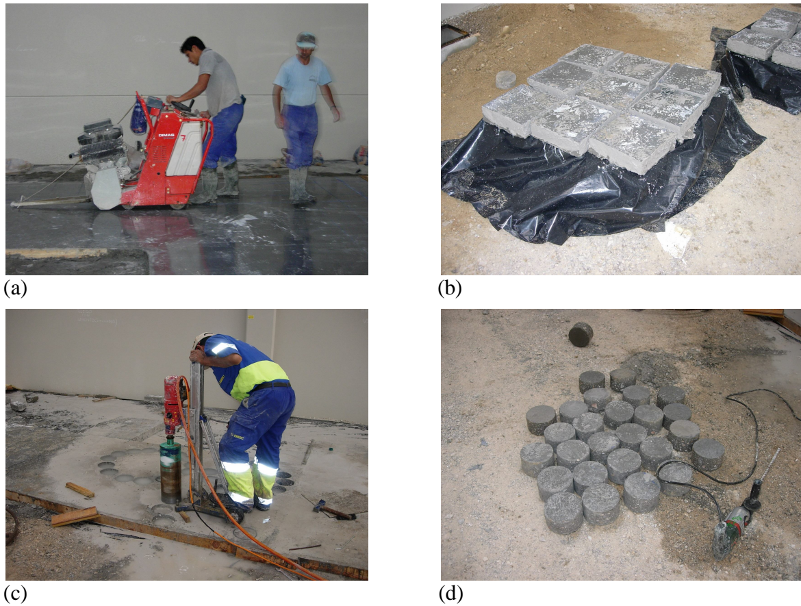
Figura 5.5: Procedimiento de extracción de muestras. (a) serrado del pavimento, (b) probetas usadas en los ensayos a ataque químico, (c) extracción de testigos cilíndricos del hormigón, (d) aspecto de los testigos cilíndricos extraídos.
