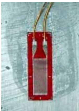
Figura 6.16: Galga Extensométrica FLA-6-11L de Tokyo Sistem de 120 \Omega para ensayos de poca deformación [113].
