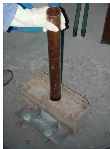
Figura 6.14: Aparato usado para medir el daño acumulado por impacto en el hormigón mediante el uso de galgas extensométricas. (a) Placa de carga y probeta usada en el ensayo. (b) Placa de carga y marco usado para retener la esfera. (c) Bola de acero usada para transmitir las cargas al hormigón. (d) Guía tubular de diámetro suficiente para permitir la caída libre de la maza metálica.
