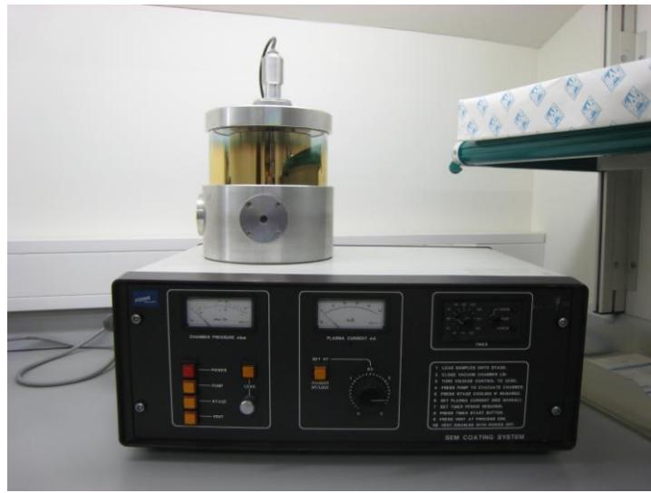
Figure 51. « *Sputtering* » Fisons Instruments SC 510
