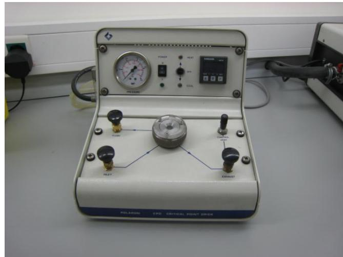
Figure 50. « *Critical point drying* » Polaroid CPD 7501
