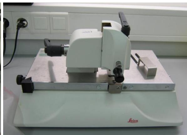
Figure 45. « Knifemaker » Leica EM KMR2
