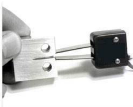
Figura 2.5. Extensómetro (tipo COD, Crack Opening Displacement) colocado en una probeta CT para la realización de un ensayo de tenacidad.
