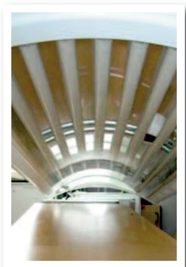
■ Figura 56. Interior de la lámpara, donde se observan los 8 tubos
