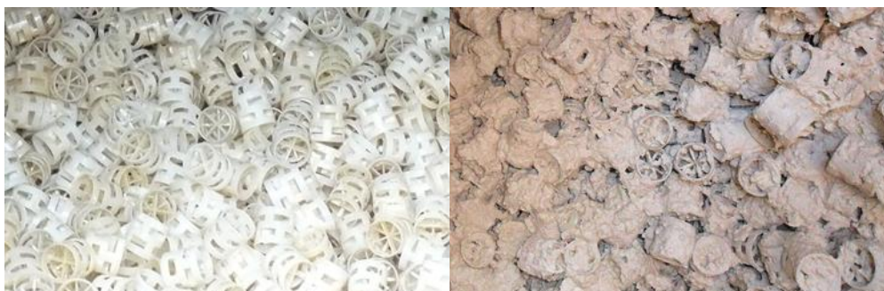
Figura 28: Estat del material de rebliment inicial del BFP i després de l'operació B, en el mòdul 1.
