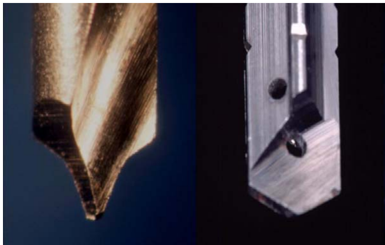
Figura 4: Detalle de la zona de corte de una fresa helicoidal (izquierda) y de una fresa plana (derecha).
