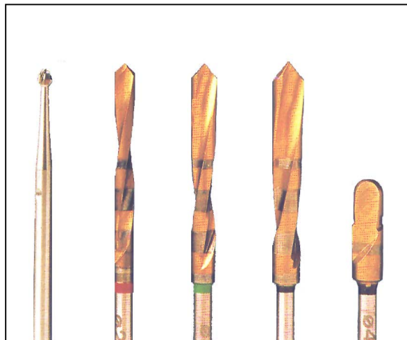
Figura 8a: Las fresas del sistema Astra están recubiertas de Nitruro de Titanio. En la imagen se muestran, de izquierda a derecha, la fresa redonda para marcar el punto de inicio de perforación, tres fresas helicoidales y la fresa piloto cortical de 4 mm. de diámetro.
