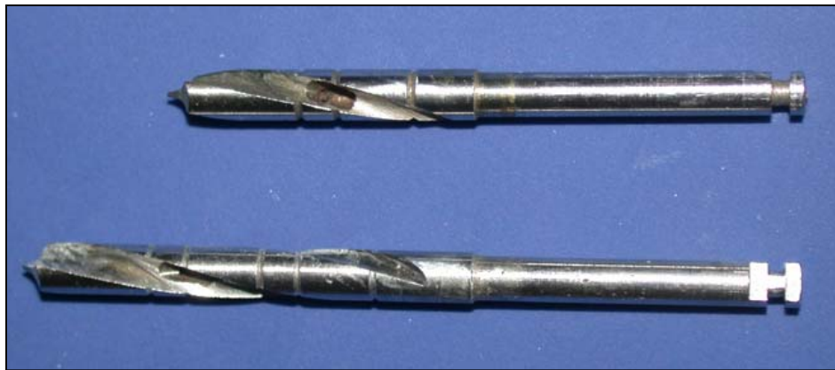
Figura 20: Fresas de irrigación interna a 8 mm. de la punta utilizadas en el estudio, sus longitudes totales son. Fresa corta: 33 mm. Fresa larga: 41 mm.
