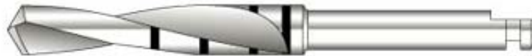
Figura 6b: Esquema de la fresa no desechable de 3 mm. de diámetro, sin irrigación interna.
