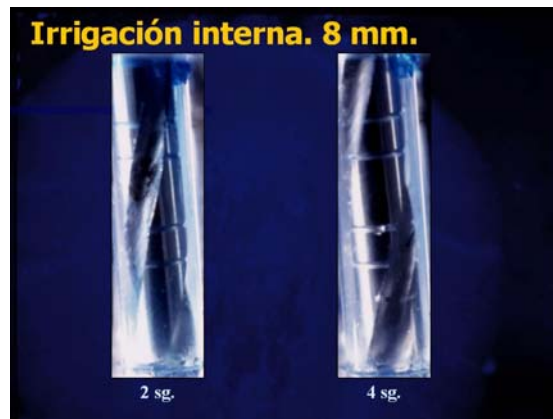
Figura 32: Evolución de las microfotografías para la irrigación interna a 8 mm. de la punta.
