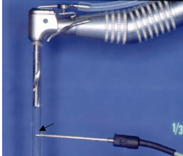
Figura 23: Montaje realizado para obtener las mediciones de la temperatura a la salida de la fresa mediante la punta del termopar. La fresa gira dentro de un tubo de cristal de 3 mm. de diámetro interno. (Fantomas A)
