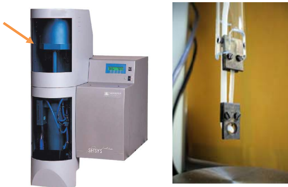
Figura 3. 4. a) Vista frontal de l'equip. A la part superior es troba el mòdul canviable (Anàlisi calorimètric i Anàlisi Termomecànic), b) sistema de subjecció de la proveta.
