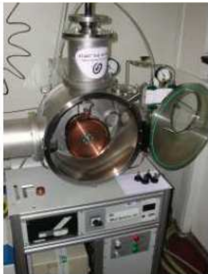
Figura 3. 2. Vista de la càmera interior de l'equip solidificació ràpida emprat on es pot veure la roda i el sistema d'inducció.
