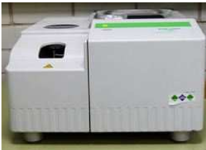
Figura 3. 4. Vista frontal de l'equip de calorimetria diferencial DSC 822 de la casa comercial Mettler-Toledo.
