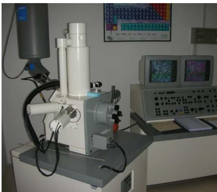
Figura 3. 6. Perspectiva de l'equip de microscòpia electrònica de rastreig. En la part de davant s'observa la columna d'acceleració d'electrons.
