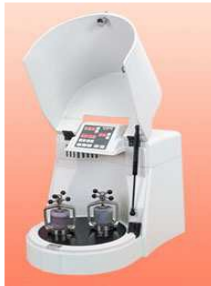
Figura 3. 3. Una vista de la càmera interior del micromolí Pulverisette 7, on es pot veure els dos contenidors.
