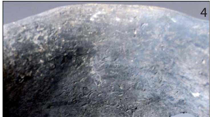
4 Hendiduras que indican el doblado de la boca
