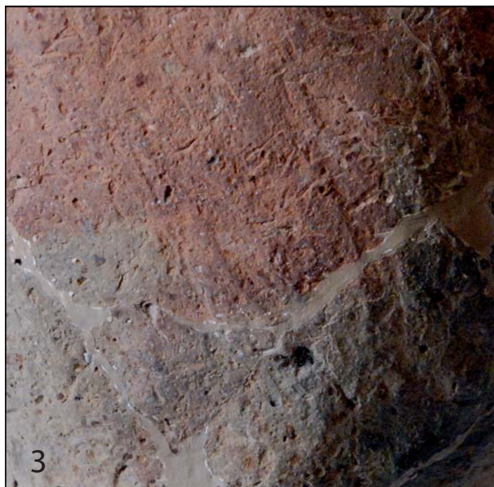
3 Acanaladuras generadas durante el raspado de la pieza
