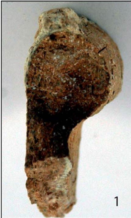
Grietas, ordenación circular de las inclusiones y fracturas transversales vinculadas a la confección por urdido
