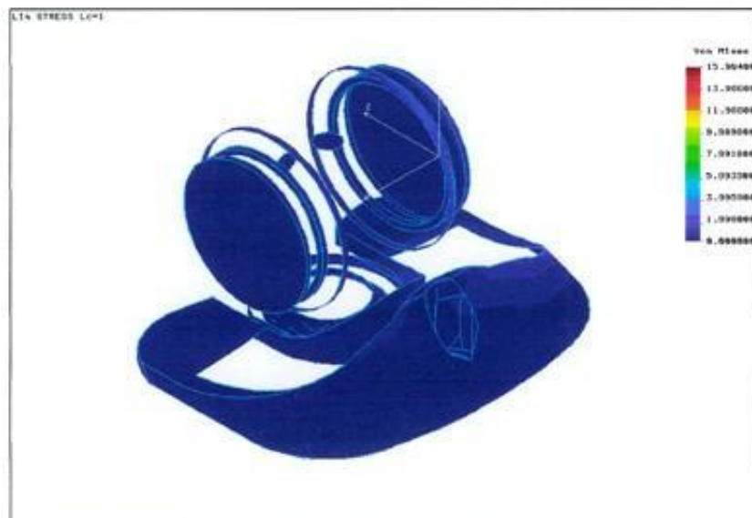
Tensiones producidas en el plástico
