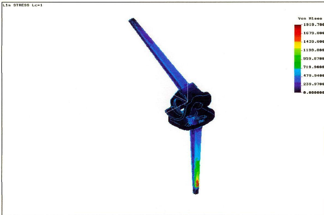
Tensiones producidas en el metal
