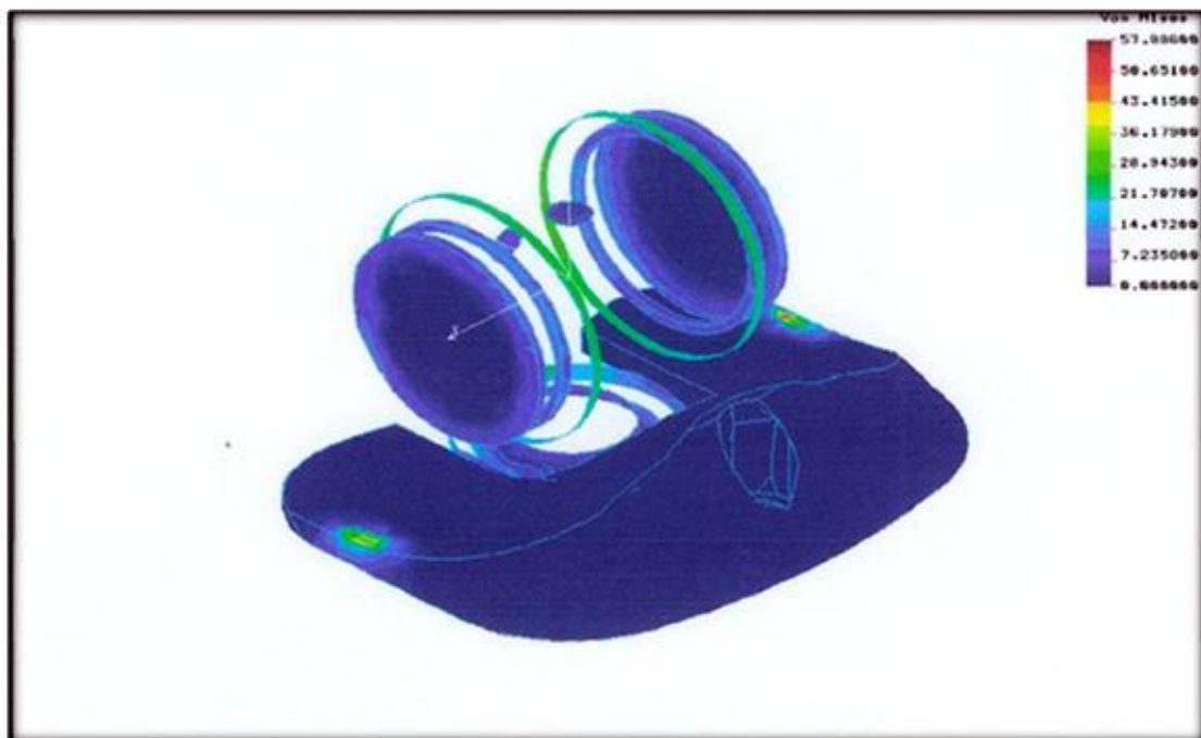
Tensiones producidas en el plástico
