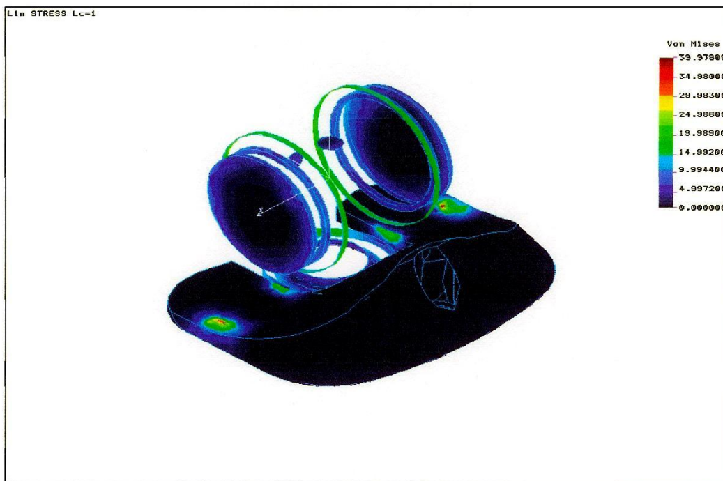
Tensiones producidas en el plástico
