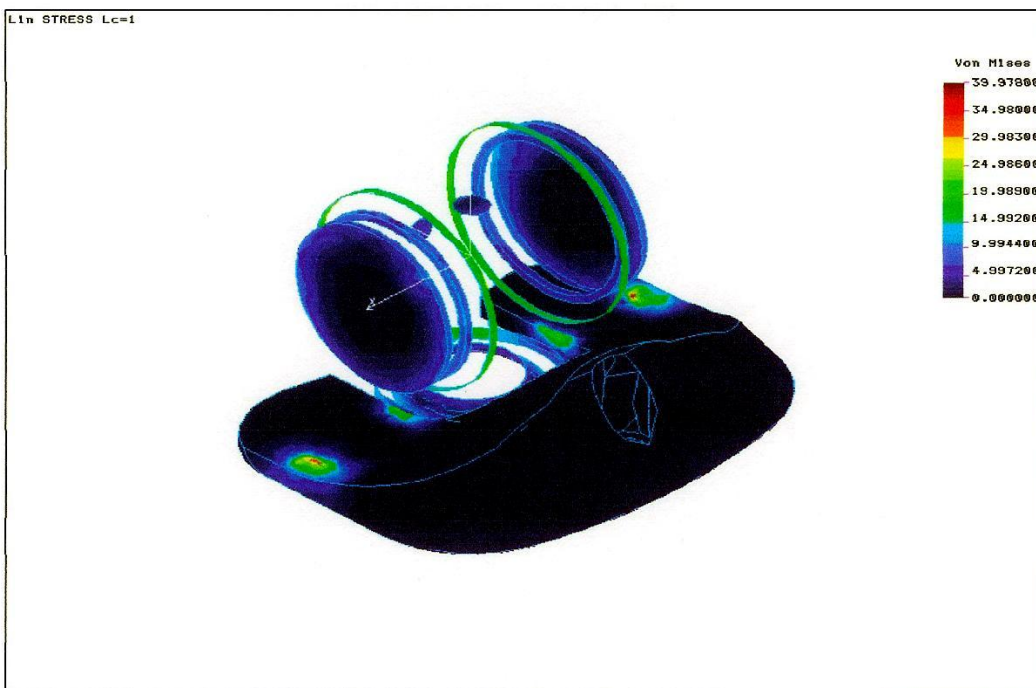
Tensiones producidas en el plástico
