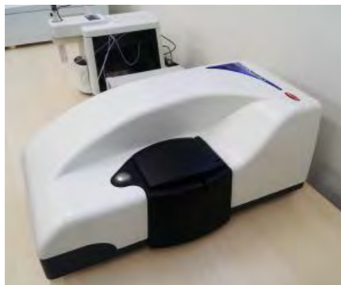
Figure 3.3. X-Ray Powder diffractometer (XRD) instrument from Institut Català de Nanociència i Nanotecnologia.
