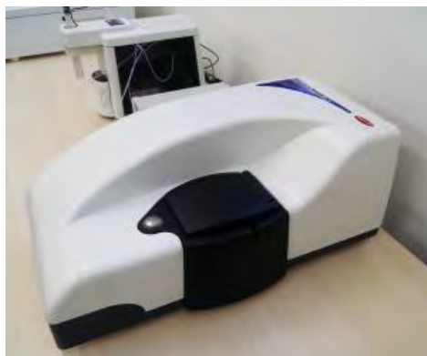
Figure 3.8 Malvern Zetasizer Nano-ZS instrument from Institut Català de Nanociència i Nanotecnologia.
