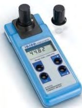
Figure 3.14. Hanna Microprocessor Turbidity Meter equipment from Universitat Politècnica de Catalunya.
