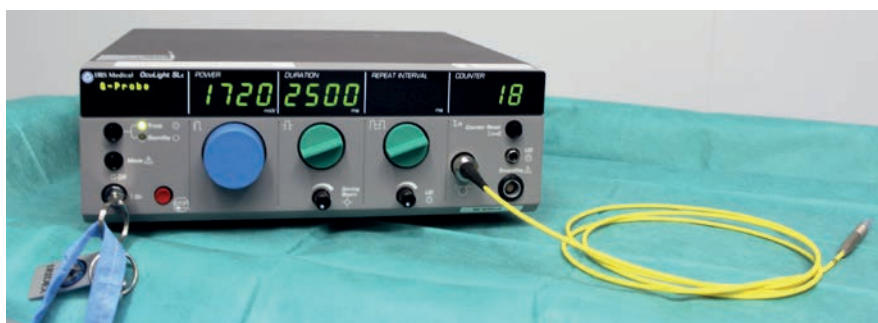
Figura 5. Láser diodo Oculight Sx y sonda G-probe.
