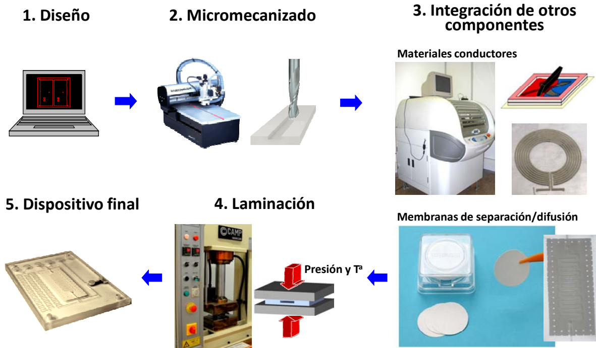
Figura 3.9. Esquema general del proceso de fabricación de microistemas analíticos mediante la tecnología de polímeros usando COC como sustrato.
