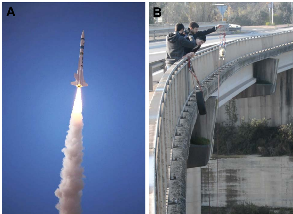
Figura 4.62. Imágenes de los experimentos realizados: A) momento del lanzamiento del cohete. B) momento de uno de los lanzamientos del montaje experimental al vacío, a modo de “puenting”.
