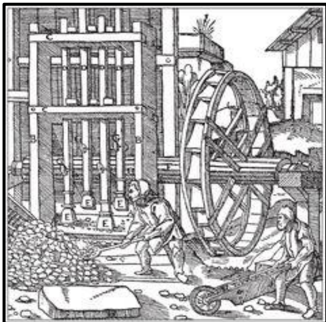
Fig.3. Grabado de Agrícola de un mortero hidráulico. HOOVER, Herbert Clark y HOOVER, Lou Henry. Georgius Agrícola. De Re Metallica. Translated from the first latin edition of 1556. Dover Publications, Inc., New York, 1950.
