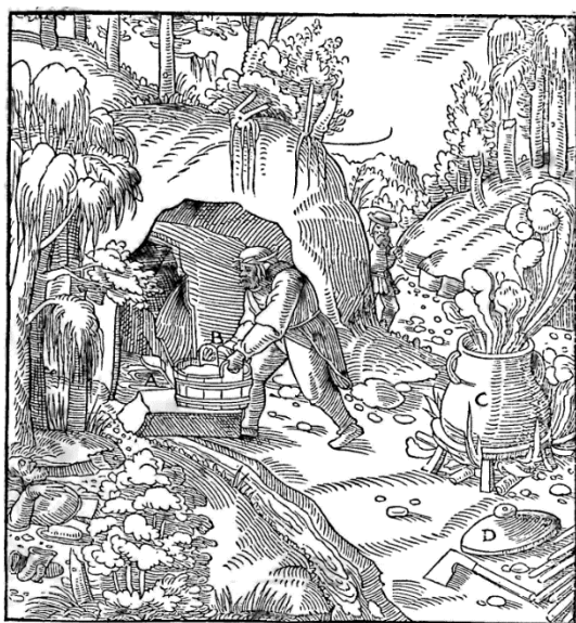
Fig.21. Si nos fijamos en la letra A, apreciamos como el agua procedente del interior de la mina encuentra un camino hacia el exterior mediante la construcción de una canalización. Fuente: HOOVER, Herbert Clark y HOOVER, Lou Henry. Georgius Agricola. De Re Metallica. Translated from the first latin edition of 1556. Dover Publications, Inc., New York, 1950.
