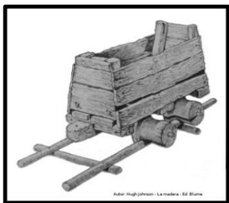
Fig.1. Ejemplo de una vagoneta de madera llamada “Der Hunt”. Fuente: JOHNSON, H. La madera. Origen, explotación y aplicaciones del más antiguo recurso de construcción . Ed. Blume S.A., Barcelona, 1986.
