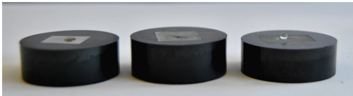
Figura 9. Diferent mullabilitat en mostres d'alumini: D2 (condició de desbast), hidrofílica (esquerre), D2_HCl (condició de desbast i reacció de HCl), hidrofílica (central), L20D2 (condició de desbast i revestiment complet), hidrofòbica (dreta).
