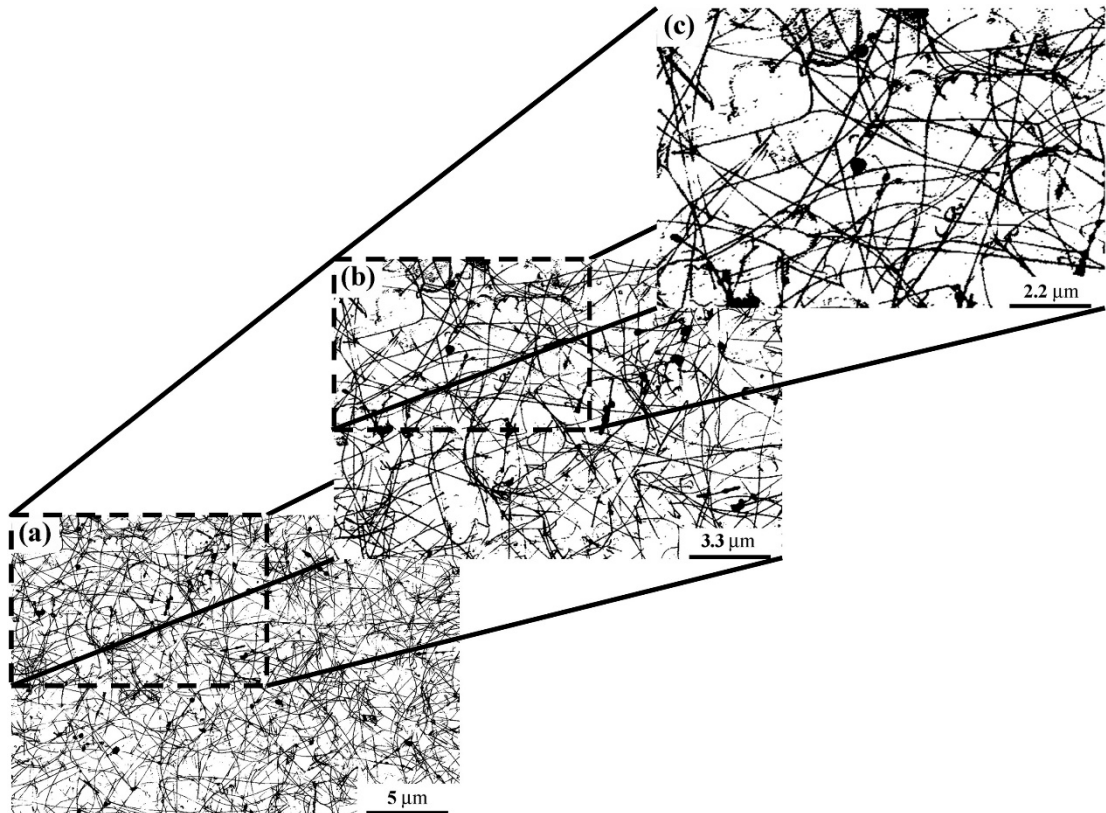
Figura 12. Morfologia de nanotubs de silici sintetitzats a 1200 °durant 0.5 h, amb creixement que presenta geometria fractal, a)imatge binària, b) imatge a majors augments de la regió marcada a a), i c) imatge a majors augments de la regió marcada a b) [108].
