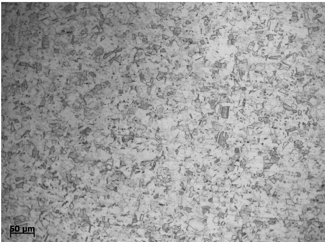
Figura 2. Micrografia realitzada per microscòpia de llum visible en un acer inoxidable 316L atacat electrolíticament amb àcid oxàlic (10%, 15 V, 1 min). La microestructura està formada per grans d'austenita.
