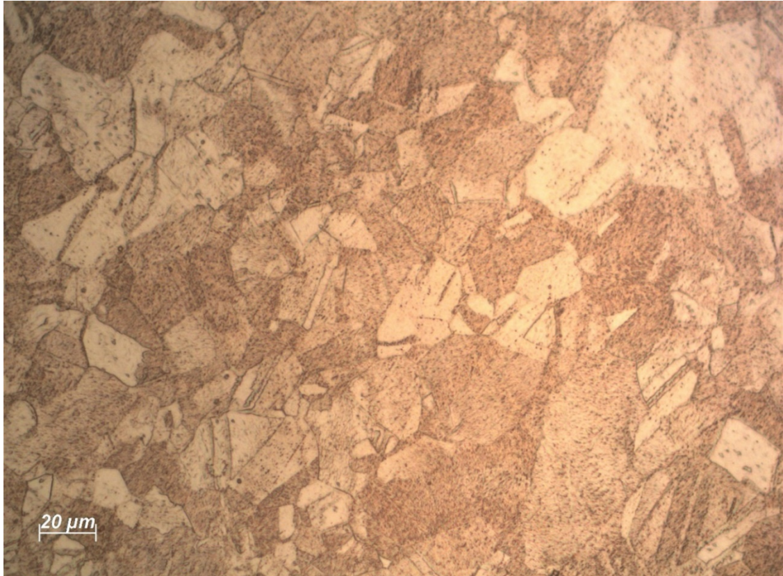
Figura 1 Micrografia realitzada per microscòpia de llum visible en coure UNS C10100, atacat amb una dissolució d'amoníac, aigua oxigenada i aigua.
