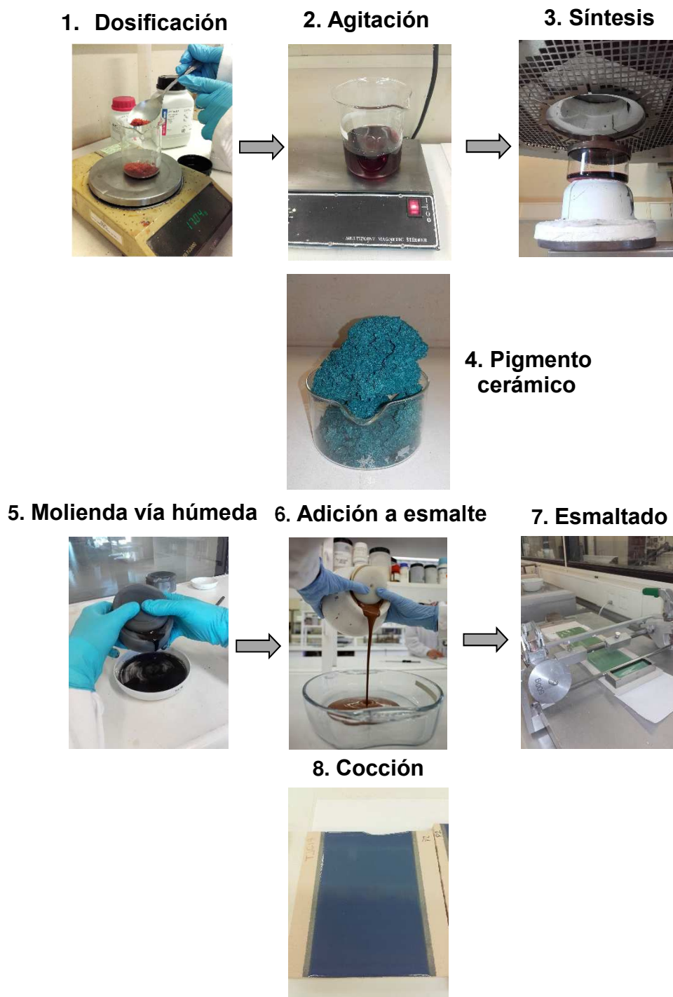
Figura 4.15 Metodología experimental para la obtención de piezas vidriadas con pigmentos sintetizados por SCD
