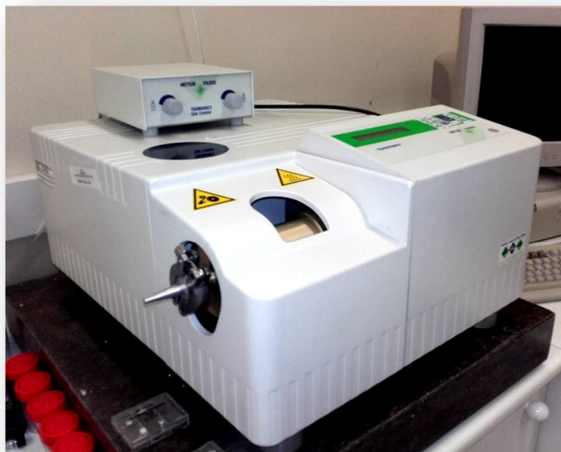
Figura 4.20 Equipo ATD-TG SDTA-e de Mettler Toledo
