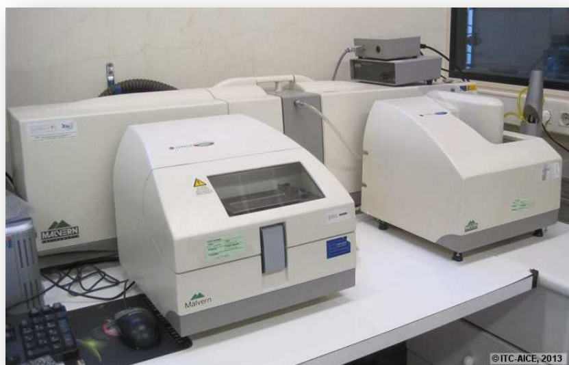
Figura 4.22 Equipo de determinación del tamaño de partícula Mastersizer 2000
