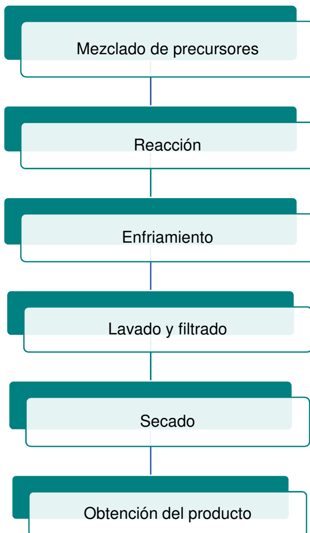
Figura 2.9 Principales etapas del método de síntesis hidrotermal
