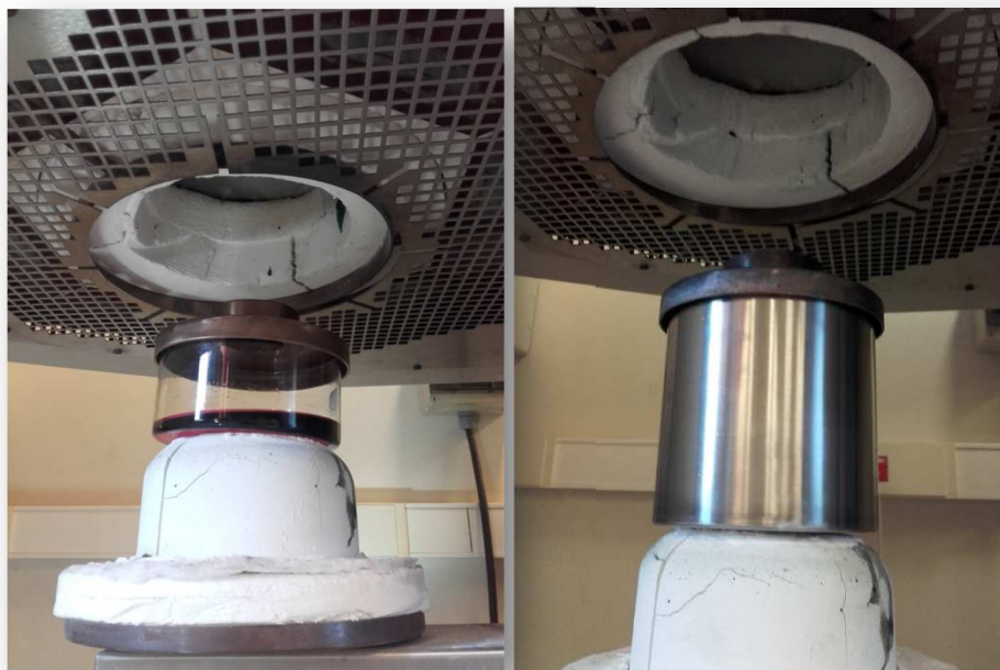
Figura 4.3 Síntesis SCD del pigmento en el horno: a) Cristalizador de Pyrex, b) Cristalizador de acero inoxidable
