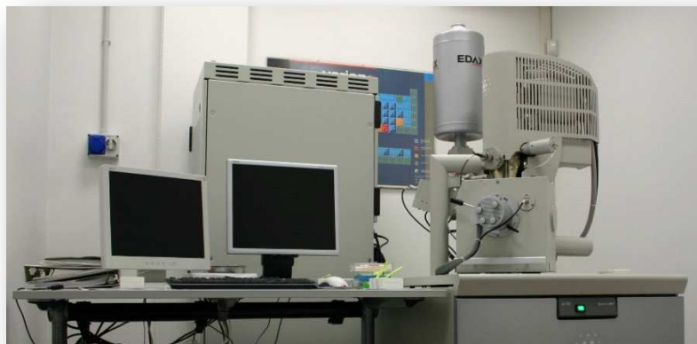
Figura 4.18 Microscopio electrónico de barrido FEG ESEM Quanta 200F
