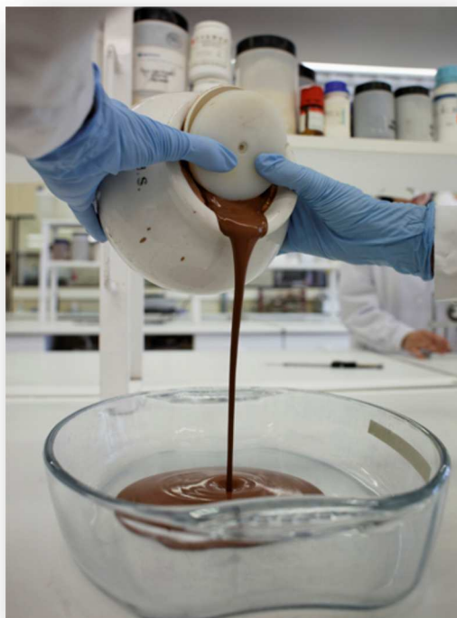
Figura 4.9 Suspensión de esmalte obtenida tras el proceso de molturación y homogeneización en molino de bolas
