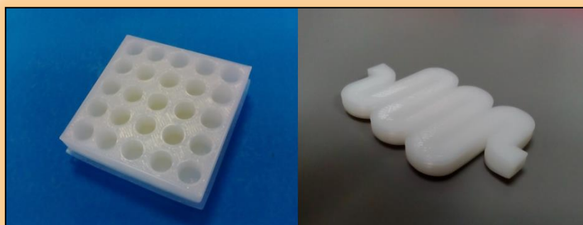
Figura 7.4. A la izquierda, pieza con los pocillos o “multi-plate Wells” para hacer ensayos. A la derecha, reactor de flujo continuo. Ambas piezas están impresas en Nylon.
