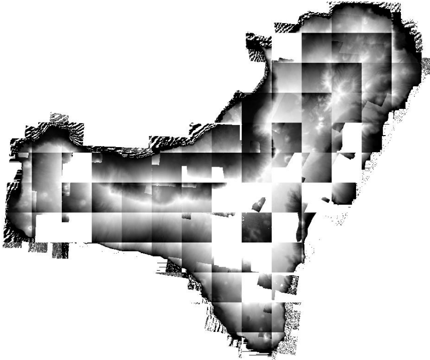
Figura 57. Model digital d'altura de la cobertura vegetal (MDACV) de les dades Lidar de l'any 2015.
