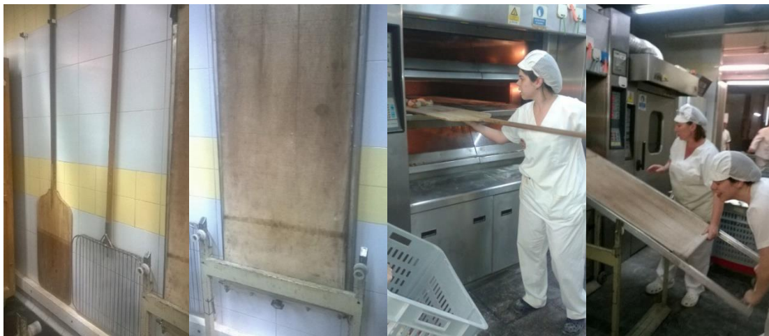
Foto 39 – Herramientas utilizadas para meter y sacar el pan del horno: las palas y la cinta transportadora, en la escuela del Gremio, se quedan colgadas en la pared delante del horno para ser usadas por los aprendices
