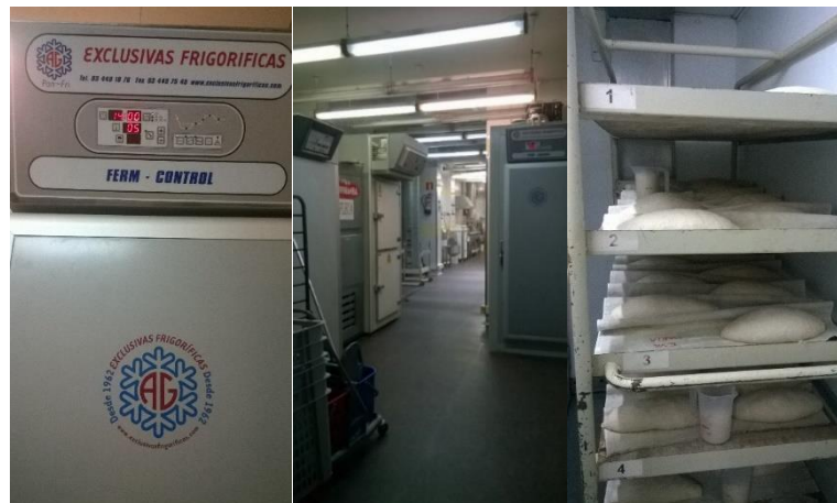
Foto 37 – La cámara de fermentación dentro del obrador del Gremio y visión interior de ella con los panes fermentando en su interior dispuestos en carros con tablas de madera y telas de lino
