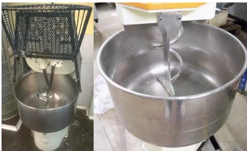
Foto 6 – Amasadora de brazos y amasadora en espiral, conocida también como cola de cerdo
