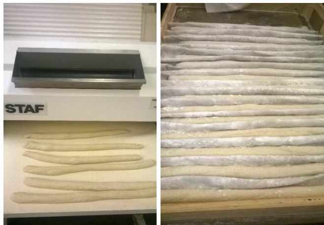
Foto 23 – Baguetes modeladas en la máquina formadora de barras y dispuestas en el cajón para fermentar después de formadas
