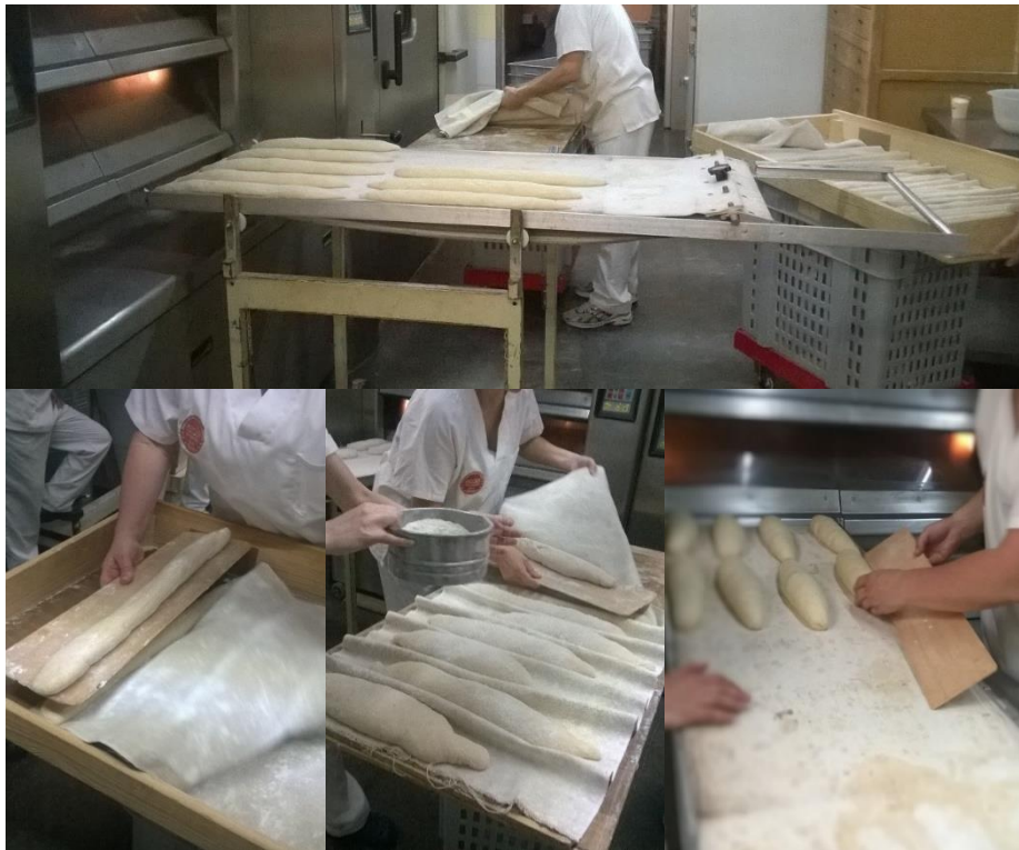
Foto 40 – Panes pasados de los cajones para la cinta transportadora con auxilio de la tabla de madera
