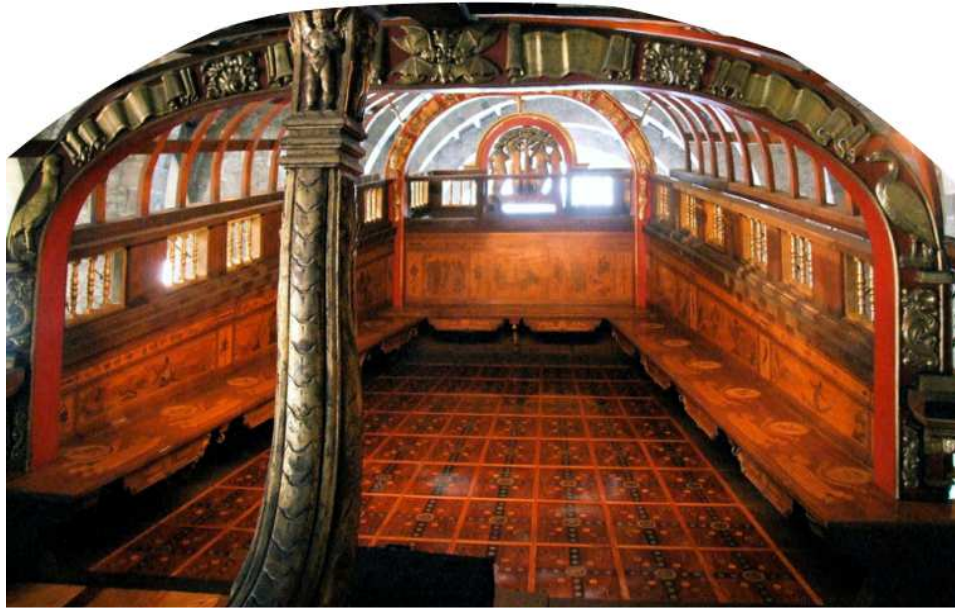
Tisera o armazón abovedado de madera en la zona noble de cubierta (factura moderna) Réplica Galera Real de Lepanto [MMB inv. 13271] | © WordPress
