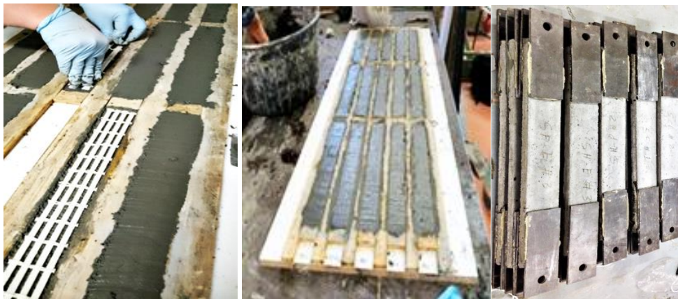
Figura 4.2. Fabricación de especímenes de FRCCM
