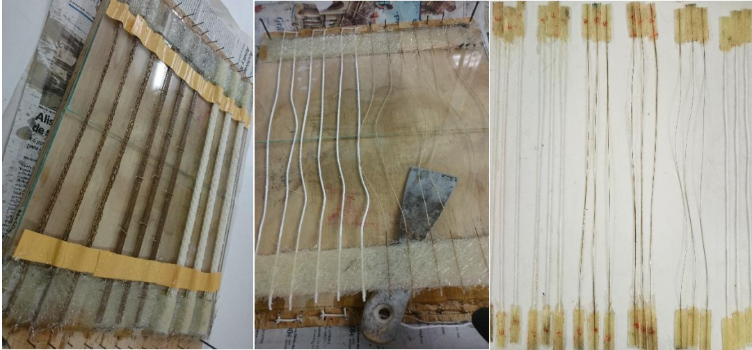
Figura A.5. Preparación de especímenes de hilo y mechones para ensayo de tracción
