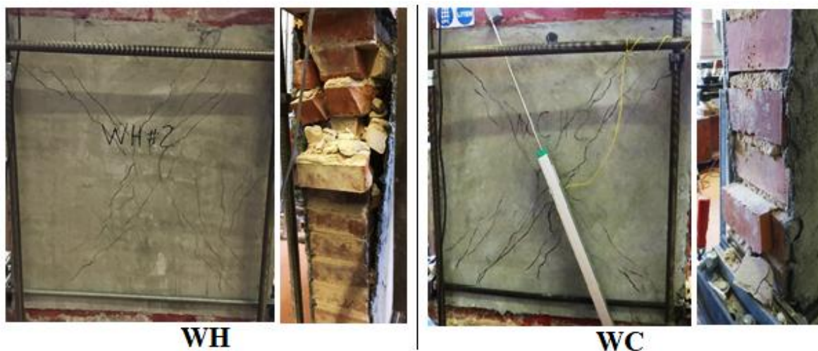
Figura 5.7. Fallos de especímenes: WH y WC
