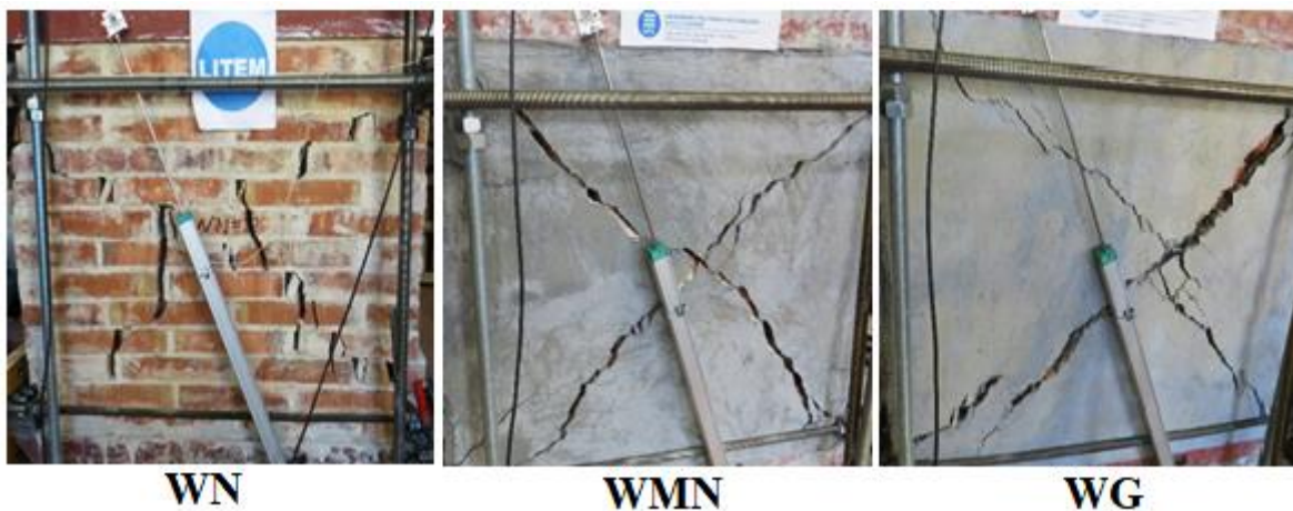
Figura 5.6. Fallos de especímenes: WN, WNM y WG
