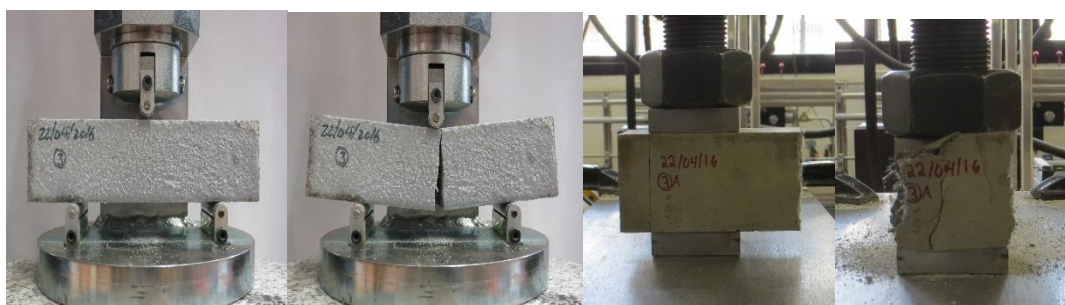
Figura 4.1. Ensayo a flexión y compresión de controles de mortero
