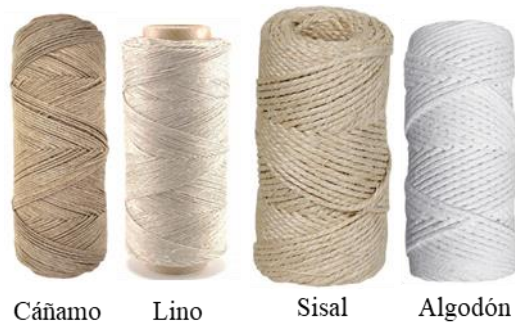
Figura A.1. Hilos de fibras vegetales
