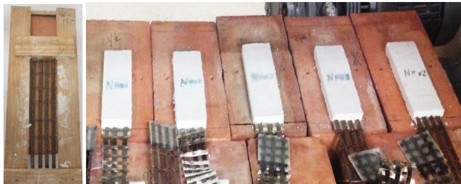
Figura 4.9. Preparación de especímenes para ensayo de adherencia
