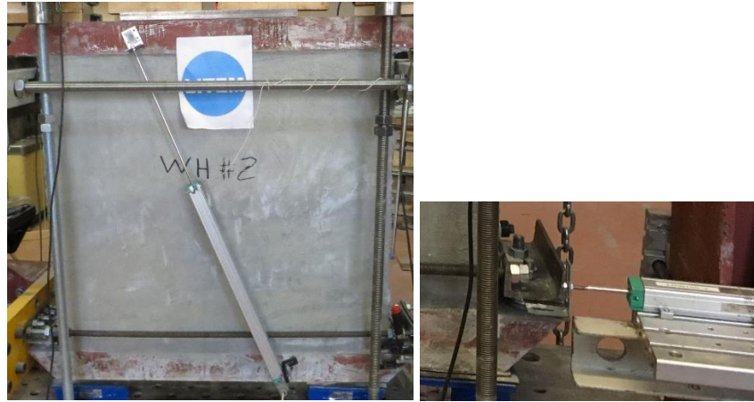
Figura B.5. Colocación de potenciómetros (LWR)
