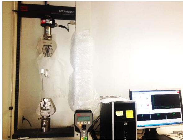
Figura A.7. Máquina de Ensayo MTS Insight
