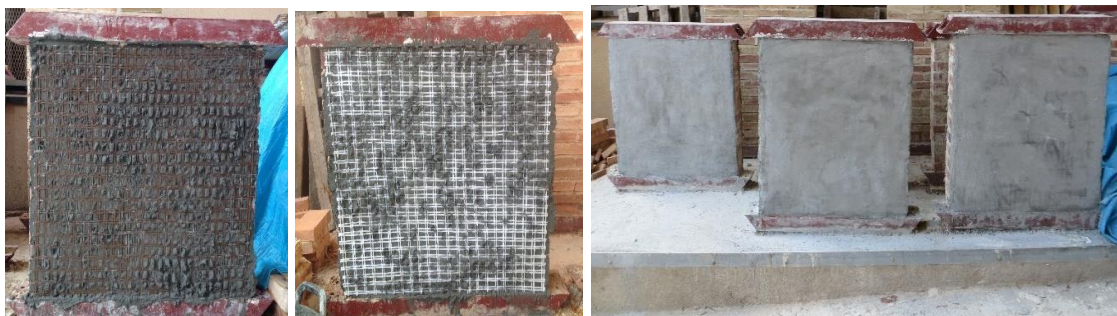
Figura 5.3. Reforzamiento de muros
