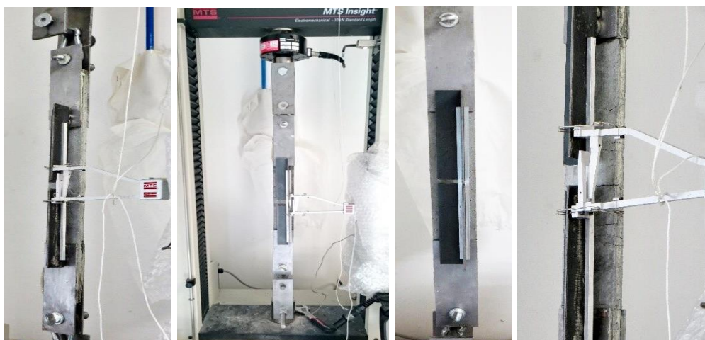
Figura 4.3. Ensayo a tracción de FRCM
