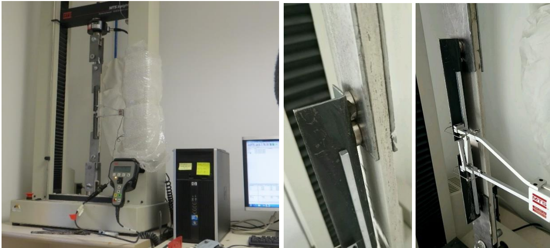
Figura A.14. Configuración de ensayo a tracción de FRCM
