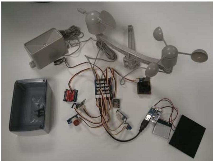
Figura 6.3: Montaje de un *SEnviro Thing*.
