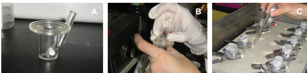
Figura 14. Preparació de l'assaig de permeació in vitro a través de cel·les de Franz. A: Preparació de la solució acceptora. B: Muntatge de la cel·la de Franz. C: Aplicació del fàrmac i inici de l'experiment.
