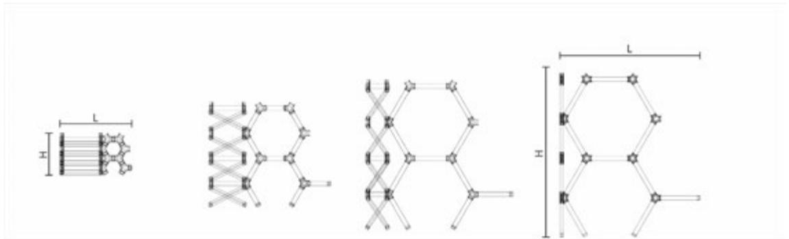
Ilustración 98: Proceso de plegado / desplegado del grupo de barras M2, vista en alzado
