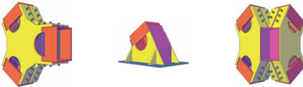
*Ilustración 110: Nudo tipo A (izq.), nudo tipo B (centro) y nudo tipo C (der.) para edificio de 8 pisos tipo C*
