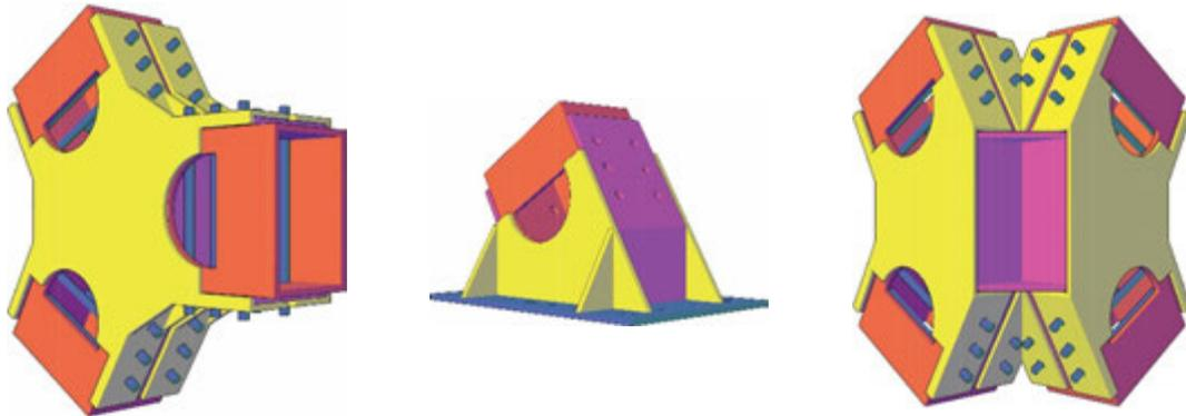
Ilustración 82: Nudo tipo A (izq.), nudo tipo B (centro), nudo tipo C (der.), para edificio de 8 pisos tipo C
