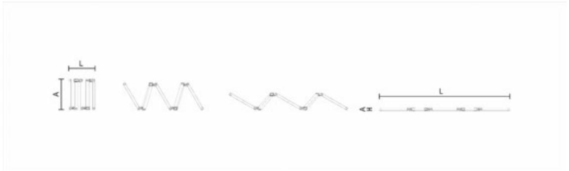
Ilustración 103: Proceso de plegado / desplegamiento del grupo de barras N2, vista en planta
