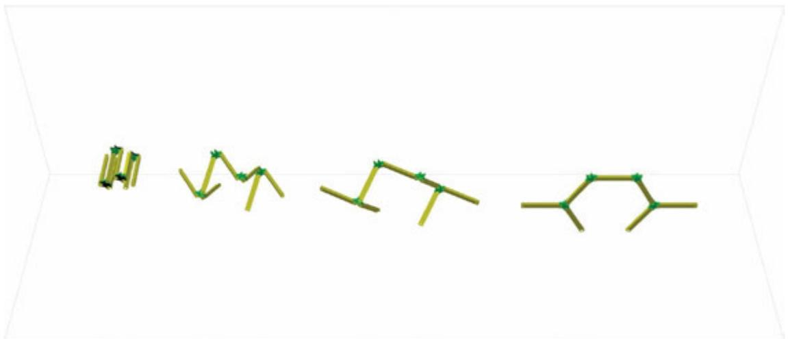
*Ilustración 102: Proceso de plegado / desplegado del grupo de barras N1, perspectiva lateral*
