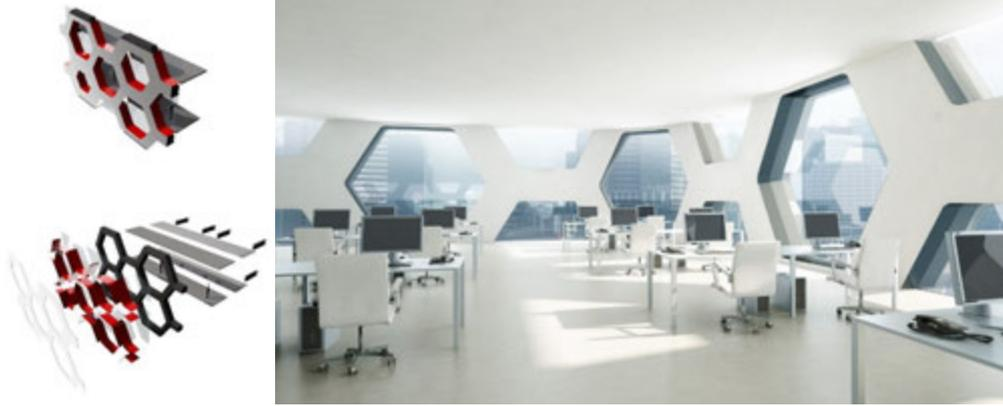
*Ilustración 16: Sinosteel International Plaza, composición de los paneles estructurales (izq.) y vista interior (MAD Architects, 2018)*
