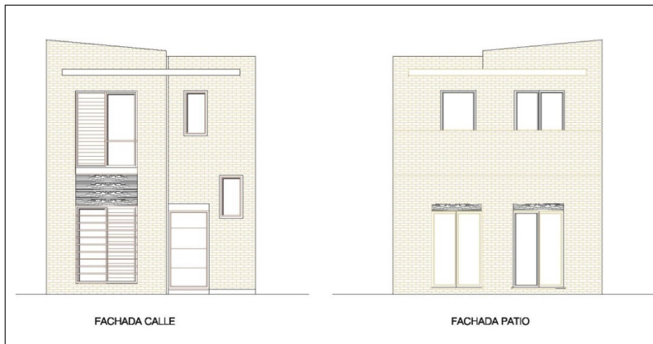
Figura 5.11 Fachadas de ladrillo caravista.
