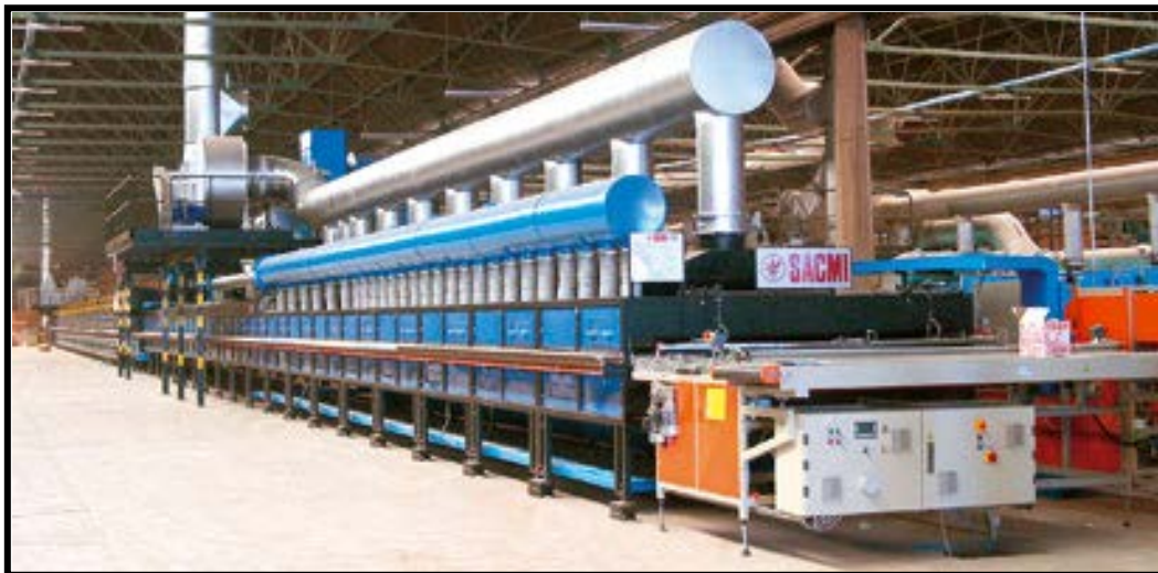
Figura 23: Horno monoestrato de rodillos.
