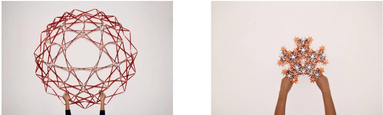
Fig 203. Maqueta Domo D30. Barras en metacrilato por corte laser y uniones impresas en 3d con pla.
