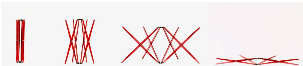
Fig 189. Módulo desplegable hexagonal con uniones PLA y barras de metacrilato. Proceso de despliegue.
