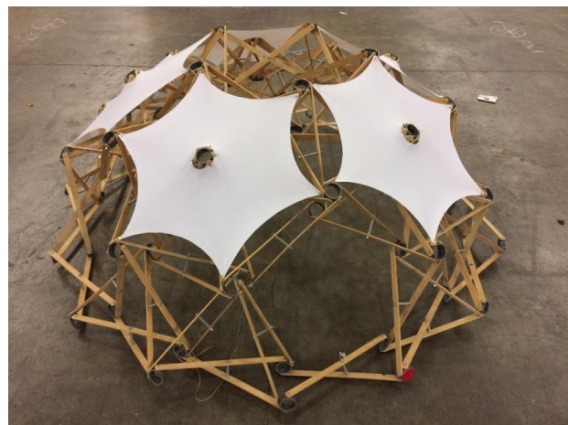
Fig 157. Domo desplegable con barras rectas articuladas. Diseño paramétrico y Maqueta presentada en el Maker Faire Barcelona 2017.
