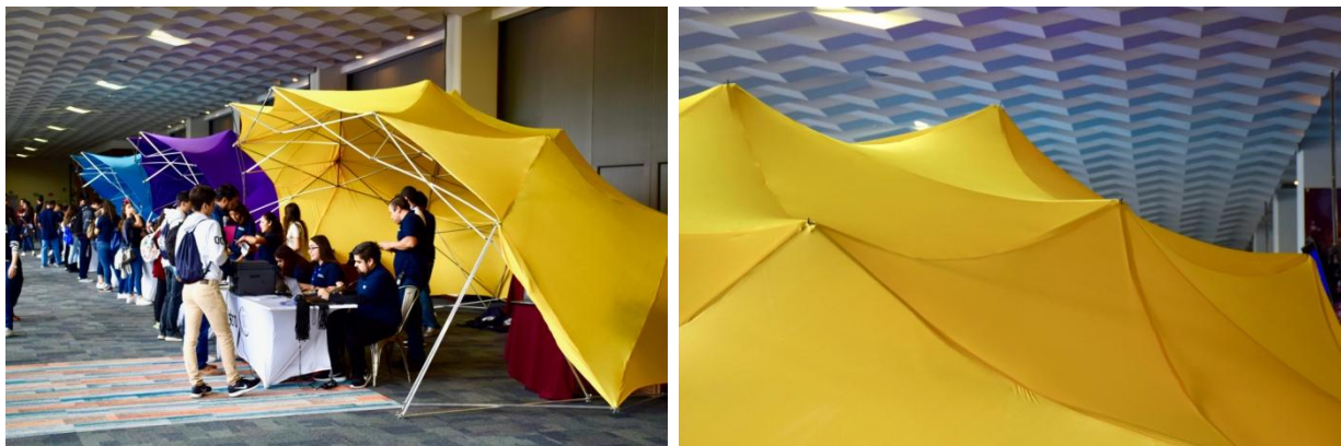
Fig 272. Medios domos desplegables con barras de aluminio y cubierta textil en lycra. Octubre 2018. Monterrey, México. DINAMIKA - Sinergia Creativa.
