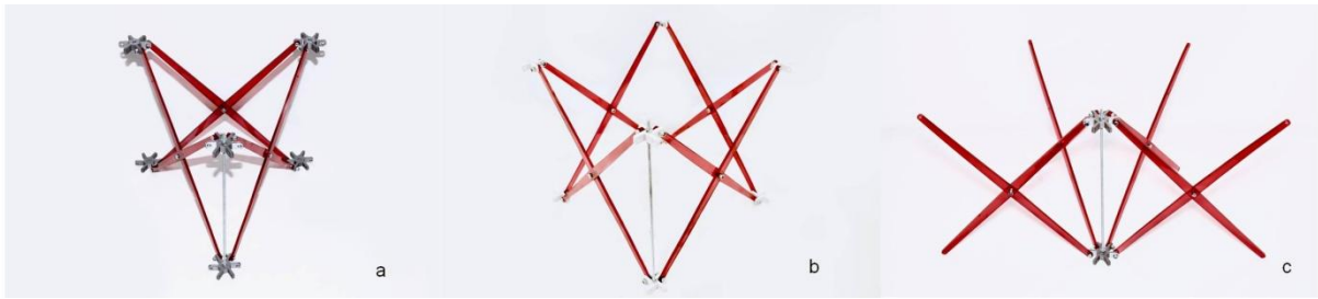
Fig 196. Módulos desplegados con elementos de control límite de movimiento. (a) Módulo triangular. (b) Módulo cuadrado. (c) Módulo hexagonal.
