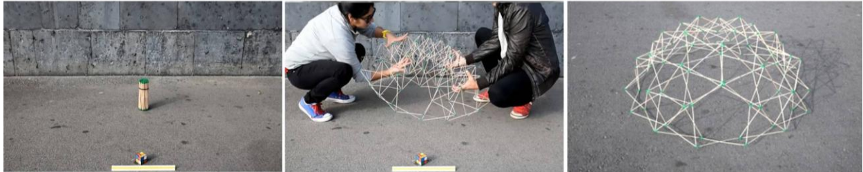
Fig 156. EDBRA. Sistema desplegable cerrado. Domo desplegable con barras rectas articuladas. Maqueta de trabajo. Proceso de despliegue.
