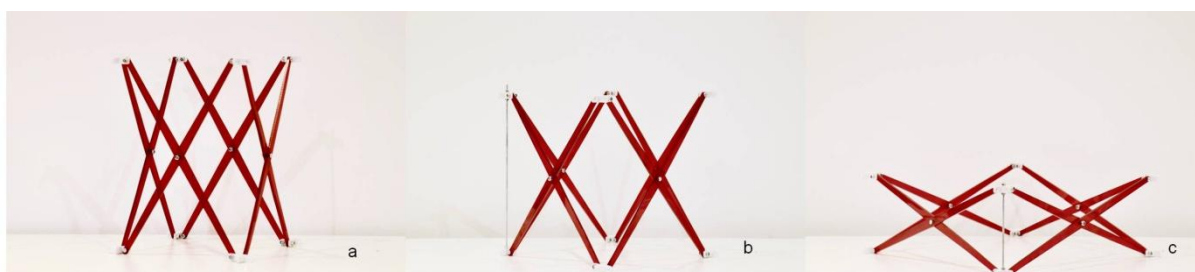
Fig 194. Módulo cuadrado desplegable. (a) Sin control de movimiento. (b) Control de movimiento 01. (c) Control de movimiento 02.
