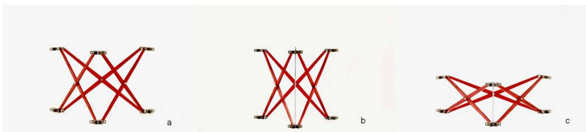
Fig 193. Módulo triangular desplegable. (a) Sin control de movimiento. (b) Control de movimiento 01. (c) Control de movimiento 02.
