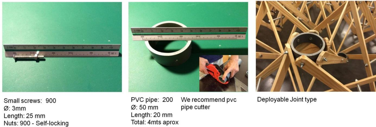
Fig 205. Materiales del prototipo. Domo Desplegable D30.
