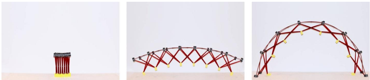
Fig 228. Arco desplegable con módulos triangulares con asimetría exterior. Maqueta con barras en metacrilato cortadas a laser y uniones impresas en 3d en PLA.
