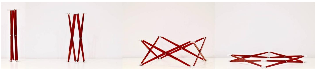
Fig 188. Módulo desplegable cuadrado con uniones PLA y barras de metacrilato. Proceso de despliegue.
