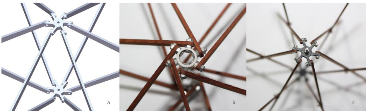
Fig 186. Ensamblado de módulo hexagonal. (a) Modelado mecánico 3d. (b) Maqueta con uniones de pvc. (c) Maqueta con uniones impresas en 3d (pla).
