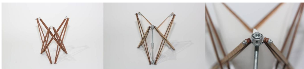
Fig 190. Módulo triangular desplegable con elemento de bloqueo de movimiento y barras a flexión activa.
