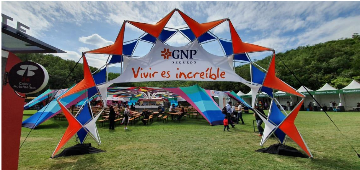
Fig 277. Arco desplegable de acceso para evento cultural con barras de aluminio y cubierta textil en lycra. Mayo 2019. Monterrey, México. DINAMIKA - Sinergia Creativa.
