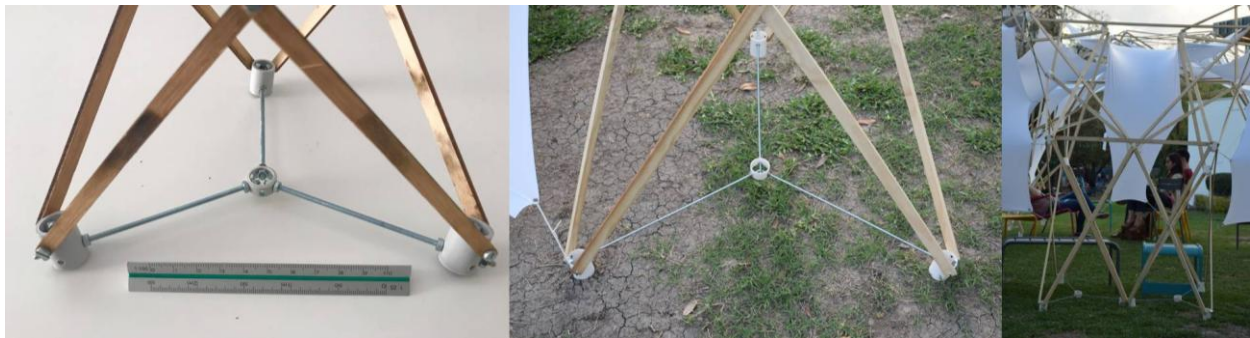
Fig 252. Anclajes y sistemas de control de movimiento. Pabellón Vertex.
