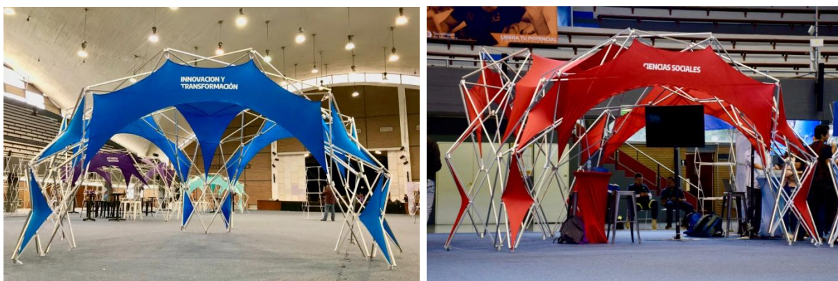
Fig 275. Vertex con barras de aluminio y cubierta textil en lycra. Monterrey, México. Octubre 2018. DINAMIKA - Sinergia Creativa.
