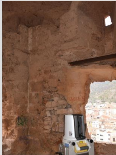
Fig. 1.70 Toma de datos con el Escáner 3D
