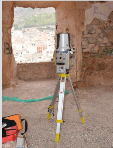
Fig. 1.71 Medición de la Bóveda de una de las salas del Castillo con el Escáner 3D
