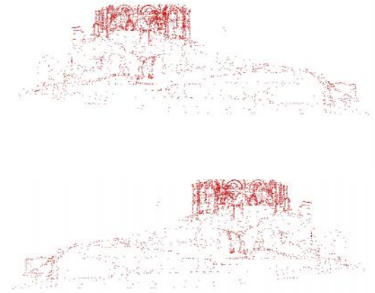
Fig. 1.48 Levantamiento topográfico alzado. Nube de puntos
