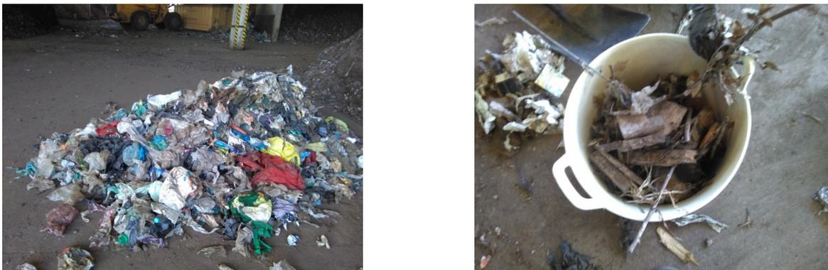
El rechazo de tromel generado de la muestra (180 kg) se caracterizó completo para determinar las diferentes fracciones de impropios presentes y el material orgánico perdido (Figura 6.17). Se observó que estaba constituido mayormente por materiales plásticos, suponiendo una elevada masa y también volumen. La composición de este rechazo estaba constituida principalmente por plásticos tipo bolsa, alcanzando el 37,4 % del rechazo.
