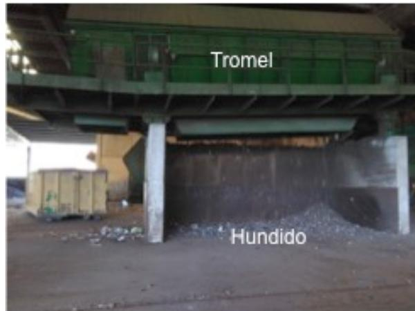
**Figura 6.5 Hundido (izquierda) y rechazo (derecha) del tromel de 80 mm.**
