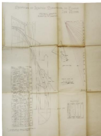
Càlcul gràfic de la diagonal del cimbori i l'absis, projecte d'església de Fígols Les Mines, Bernardí Martorell, 1919. Fons: Junta Diocesana de Reparació de Temples, ADS (lligall 71).
