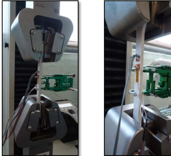
Figura 4.9: Ensayo SST según la ISO 527-5 [160]
