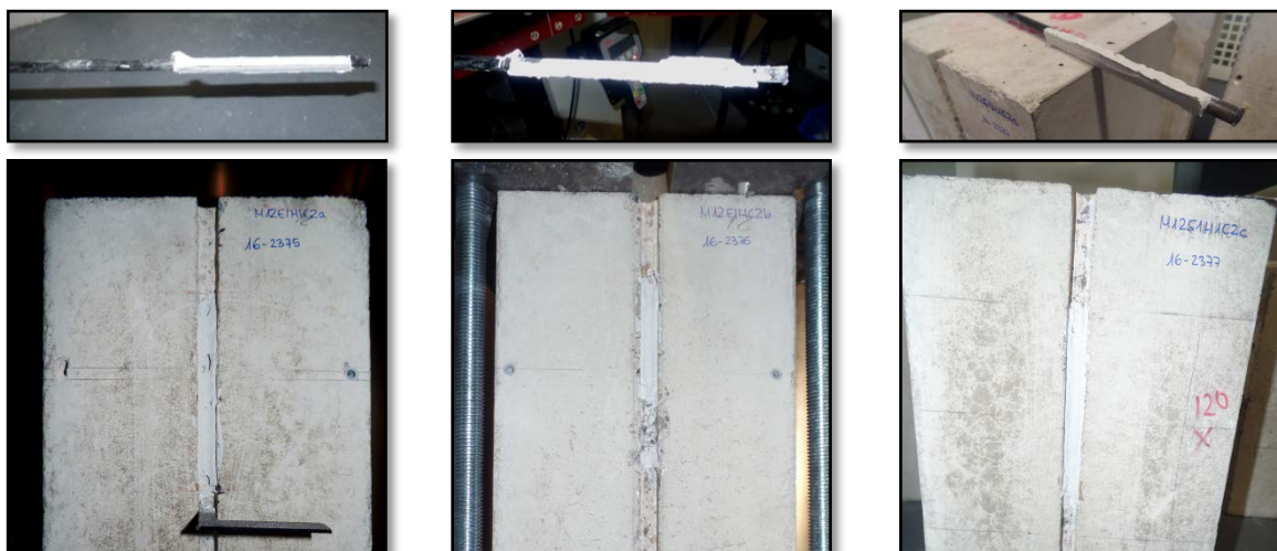
a) A: Interfacial barra – adhesivo con desprendimiento de adhesivo.
