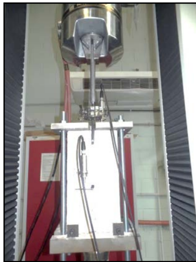
Figura 4.18: Configuración ensayo pull-out
