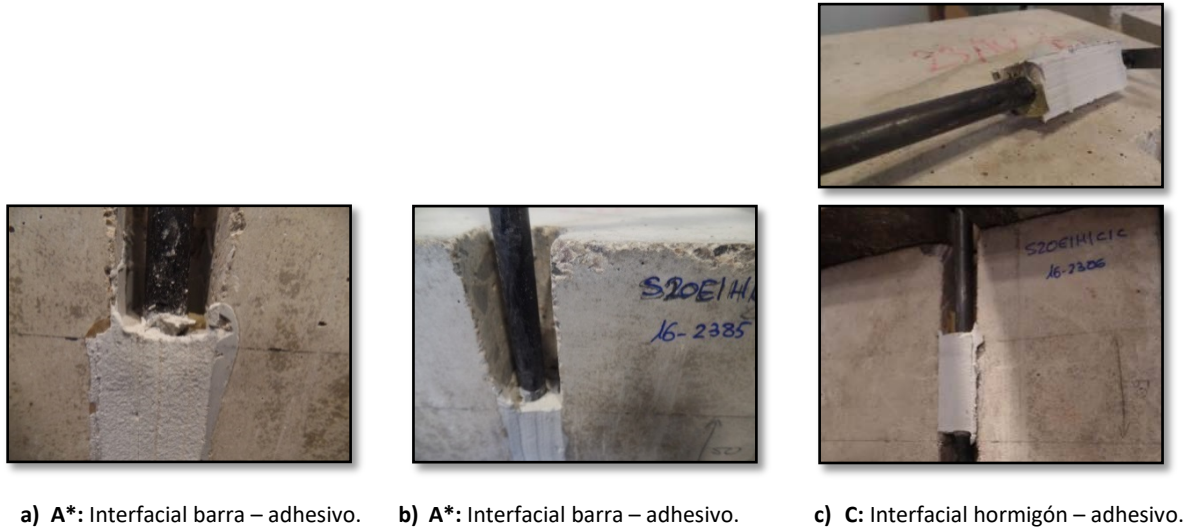
Figura 6.23: Modo de rotura de las probetas S-20-C1-40_x
