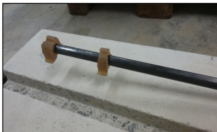
Figura 4.14: Tapones de látex para delimitar la longitud de adherencia
