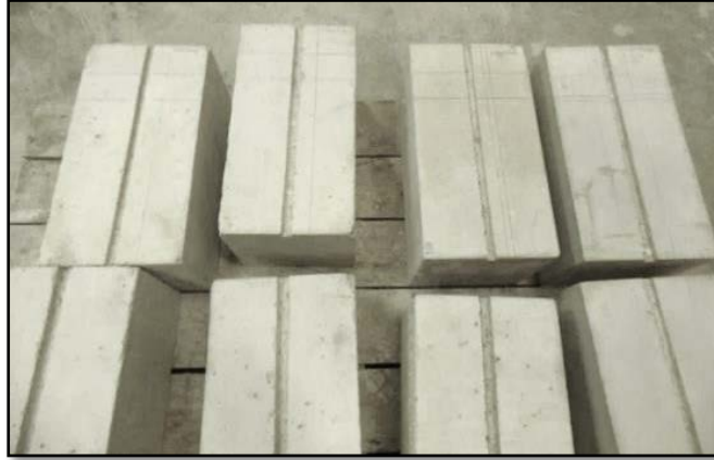
Figura 4.16: Preparación de ranuras
