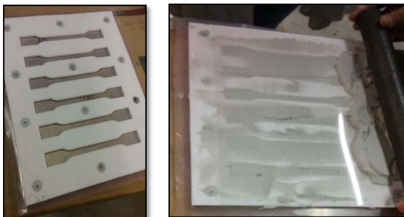
Figura 4.7: Preparación de probetas según la ISO 527-2 [160]
