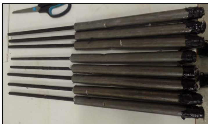
Figura 4.13: Protección de las barras CFRP para evitar el daño de las fibras y la falla por la zona de sujeción
