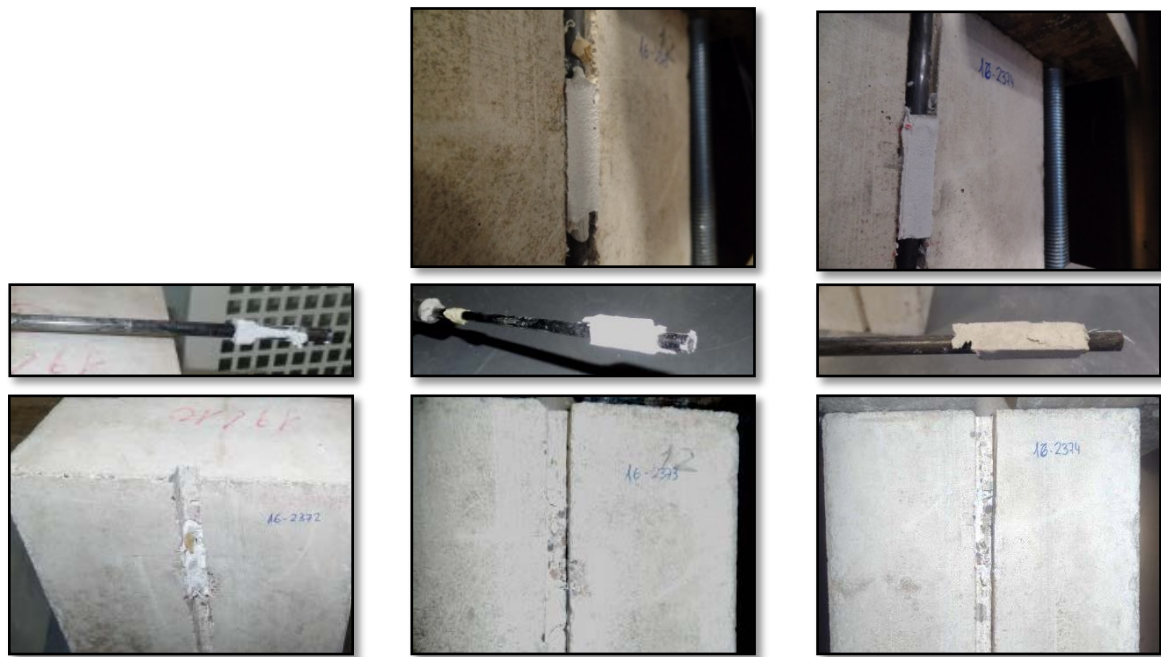
a) A: Interfacial barra – adhesivo con desprendimiento de adhesivo.
