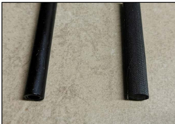
Figura 4.4: Barras utilizadas en las dos series de la campaña experimental: Sika CarboDur BC® (izquierda) y MBrace Mbar 165/2500® (derecha)
