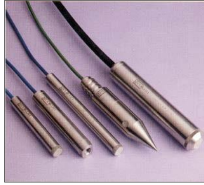
Figura 3.79. a) Unidad de lectura de los piezómetros de cuerda vibrante b) Sensores de cuerda vibrante
