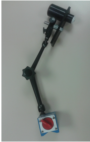
Figura 9.34.: Braç magnètic articulat, amb el sensor acoblat
