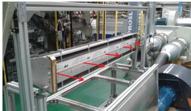
Figura 5.6.: Muntatge experimental, i posició dels punts de mesura, per a la caracterització de velocitats en el llavi de la pantalla
