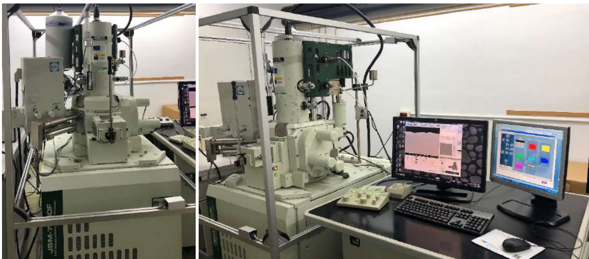
Figura 4. 5. Microscopio electrónico de barrido de emisión por efecto de campo (Field Emission –Scanning Electron Microscope, FE-SEM) JEOL J-7100F (JEOL Ltd, Tokio, Japón) con un detector Robinson BSE acoplado y espectroscopia de rayos X de dispersión de energía (EDS).
