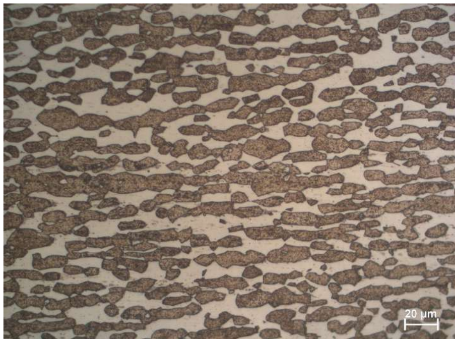
Figura 3. 2. Microestructura ferrítico-austenítica del acero inoxidable dúplex procesado por laminación en caliente, después de una homogenización a la temperatura de
