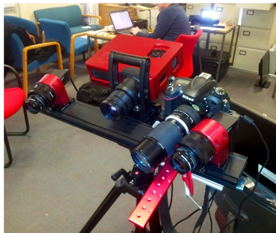
Figura 7.4. Mech Scan Macro White Light 3D Scanner equipado con una cámara fotográfica Nikon supletoria.
