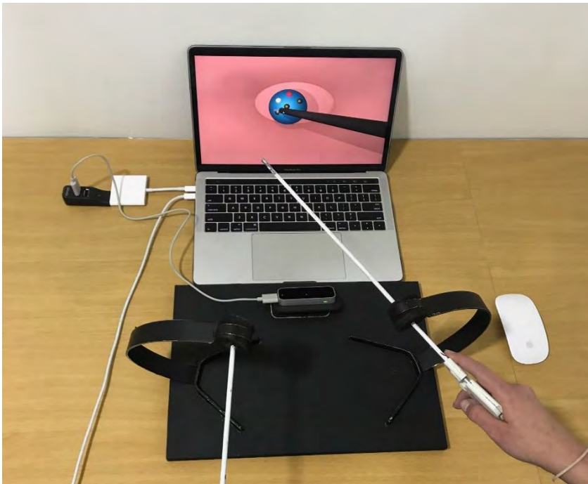
Figura 23. Versión final del simulador una vez se agregaron los dispositivos de hardware sin componentes electrónicos: la base y los dispositivos de soporte para las pinzas y para el LMC
