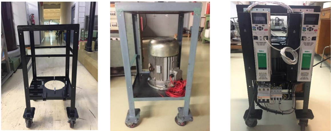
Fig. 70: Estructura metálica de la bancada, Presentación del Motor y Conjunto acabado. Fuente: Propia
