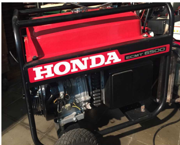
Fig. 60: Grupo electrógeno \cos\phi=1 , HONDA 6,4 kW-6,5 kVA (conjunto máquina térmica- alternador), comercial ECMT 6500 13.0. Fuente: Propia
