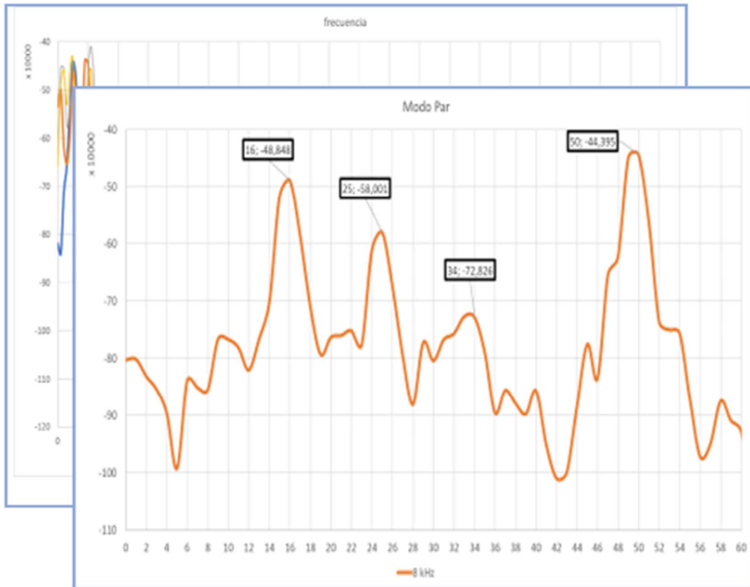
Fig. 150: Registro Espectral de muy baja frecuencia, hasta 60 Hz. Motor Novat usado como carga y girando en vacío. Fuente: Propia.
