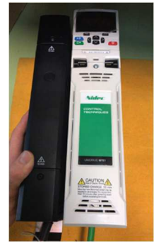
Fig. 63 Convertidor de Frecuencia (VSD) de la serie Unidrive. Fuente: Propia
