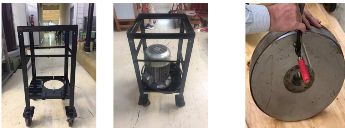
Fig. 1 Chasis, Montaje del motor eléctrico de 9 kW, 400 V, 50 Hz y volante de inercia del prototipo de acumulador cinético de energía eléctrica (ACEE) construido. Fuente: Propia.
