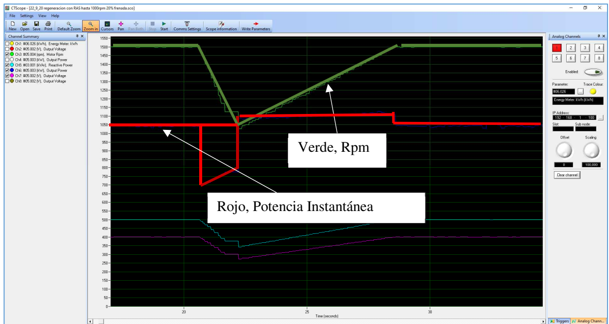
Fig. 137: Imagen de registro de descarga de energía del volante de inercia y recuperación del sistema (ACEE). CT Scope. Fuente: Propia
