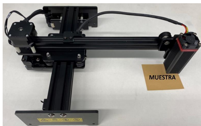
Figura 49. Grabador fotolitográfico de láser continuo ( \lambda = 455 \text{ nm} , P_{\text{máx.}} = 20 \text{ W} ( 330 \text{ W/cm}^2 ), \varnothing = 1 \text{ mm} ).
