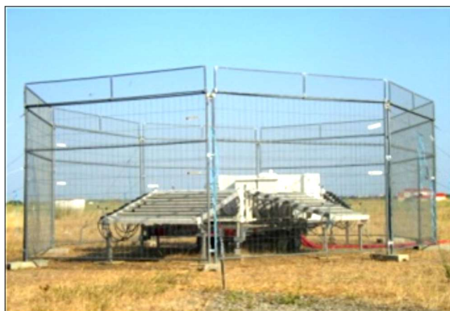
Figura 3.18. PCL1300 UHF Wind profiler (Font: Météo France).
