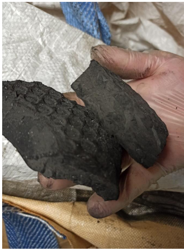
Figura 1. Vista de los residuos generados por un EGCS de tipo híbrido operando en ciclo cerrado. Fuente: el Autor.
