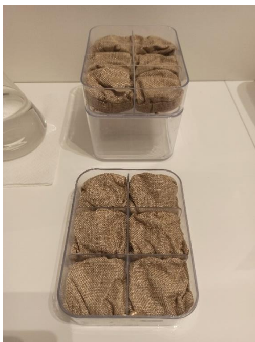
Figura 78. Vista del sistema diseñado para el tratamiento de las aguas ácidas. Fuente: el Autor.
