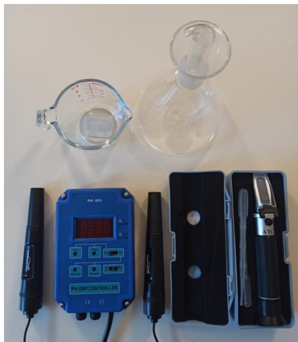
Figura 59. Vista del equipo adquirido durante la investigación para análisis de acidez (pH), salinidad y densidad. Fuente: el Autor.
