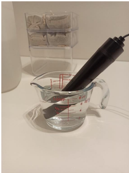
Figura 70. Vista del análisis de pH del agua de la dársena sur del puerto de Barcelona previo al ensayo. Fuente: el Autor.
