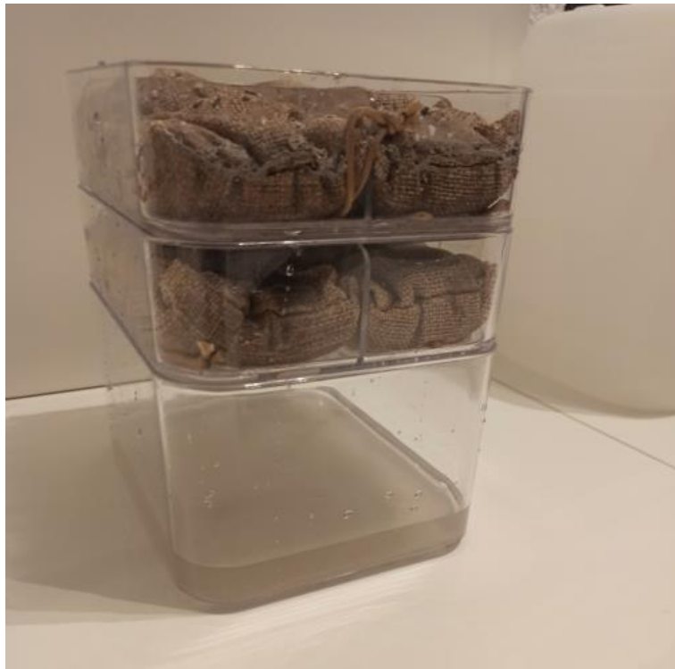
Figura 81. Vista del sistema propuesto tras filtrar el agua con pH de 3,01 unidades. Fuente el Autor
