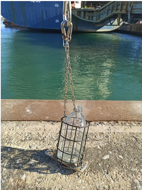
Figura 48. Vista del aparejo diseñado para la toma de muestras de la Dársena Sur del puerto de Barcelona. Fuente: el Autor.
