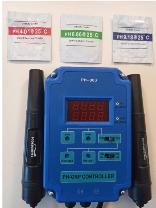
Figura 64. Vista del equipo adquirido durante la investigación para análisis de acidez (pH) y soluciones para calibración. Fuente: el Autor.
