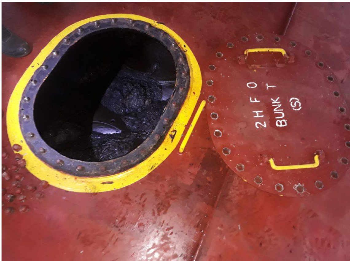
Figura 7. Vista de la formació de fangs en el interior de un tanque de fuelóleo muy bajo en azufre. Fuente: http://www.ameydemarine.com
