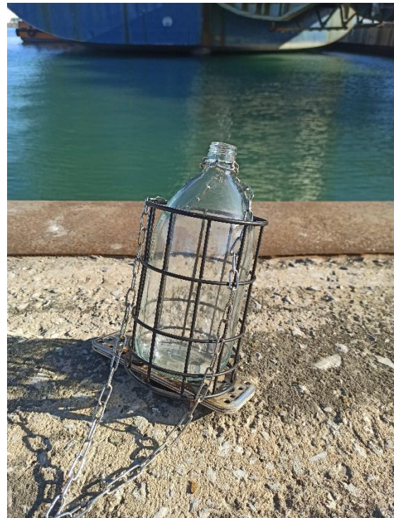
Figura 49. Vista del aparejo diseñado para la toma de muestras de la Dársena Sur del puerto de Barcelona. Fuente: el Autor
