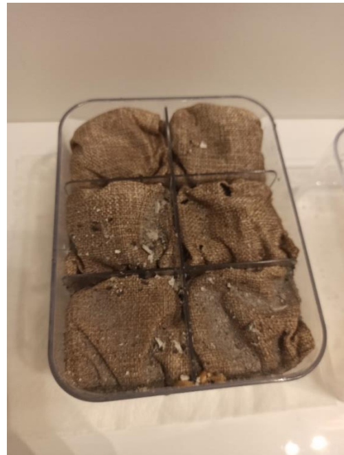
Figura 83. Vista de los filtros con restos de la materia particulada del agua de ensayo. Fuente: el Autor.
