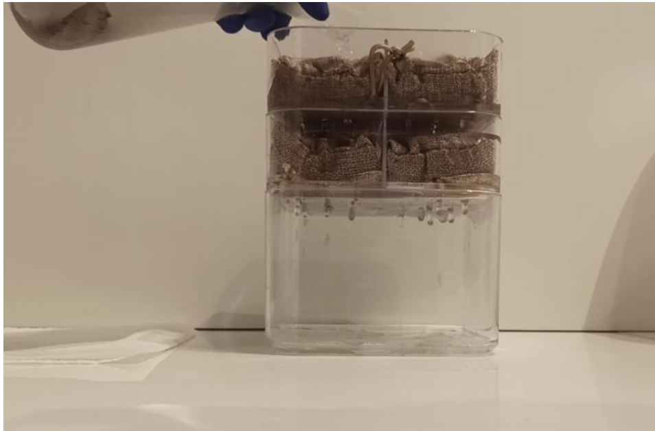
Figura 80. Vista del sistema propuesto filtrando el agua con un pH de 3,01 unidades y con materia particulada en suspensión. Fuente el Autor:
