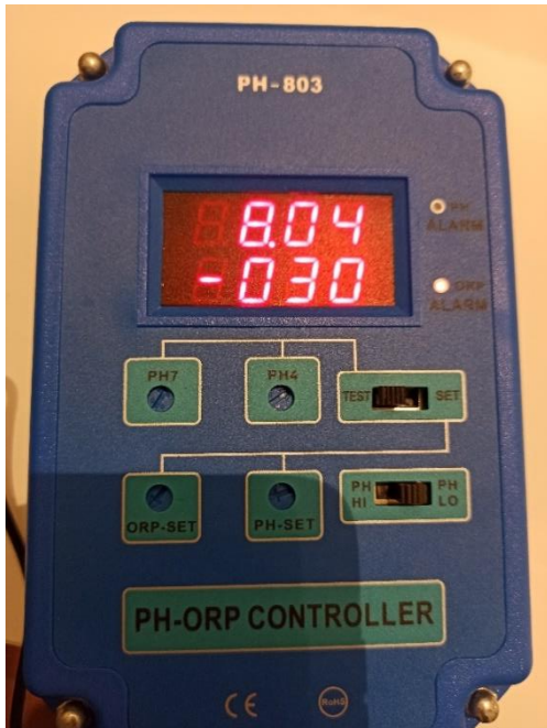
Figura 82. Vista del valor de pH obtenido tras filtrar el agua ácida obtenida por el sistema propuesto. Fuente: el Autor.
