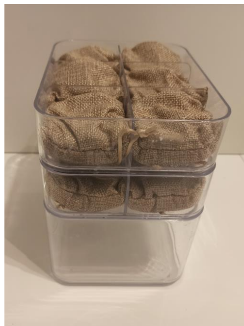
Figura 77. Vista del sistema diseñado para el tratamiento de las aguas ácidas generadas. Fuente: el Autor.
