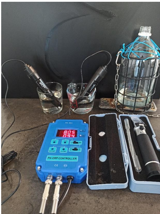
Figura 60. Vista de la obtención del nivel de acidez (pH) y potencial redox (ORP) con el equipo de medición particular. Fuente: el Autor.
