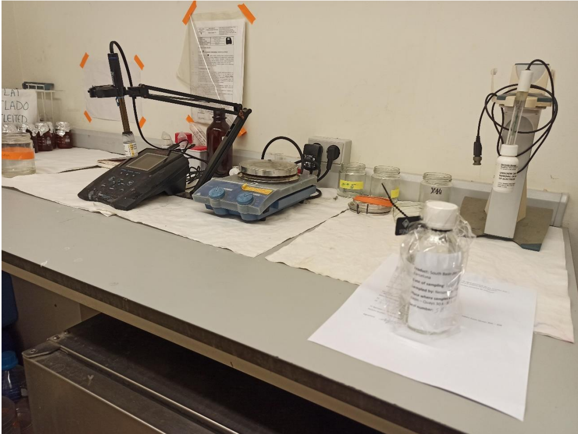
Figura 47. Vista del equipo empleado por el Instituto de Diagnóstico Ambiental y Estudios del Agua (IDAEA) para analizar la acidez (pH) de las muestras entregadas con vista de una de las muestras que ha sido analizada durante la investigación. Fuente: el Autor.
