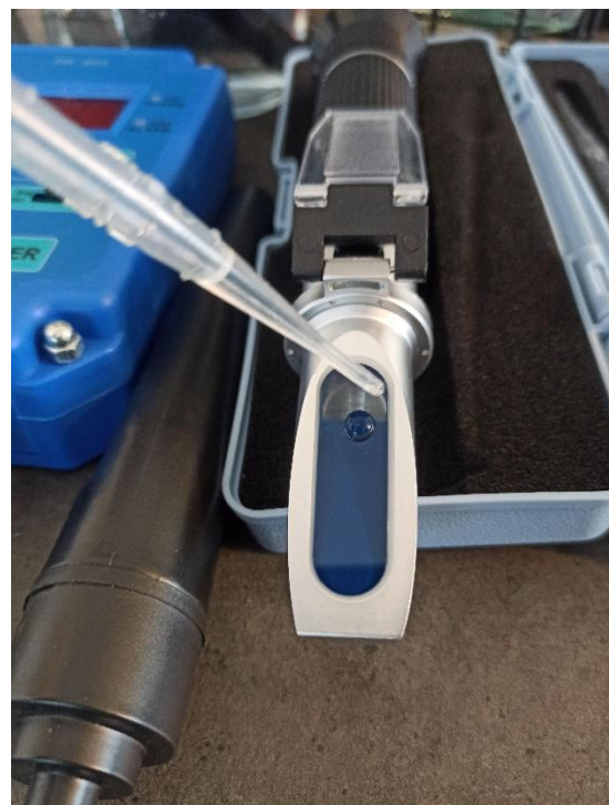
Figura 61. Vista del análisis de la salinidad y densidad con el refractómetro. Fuente: el Autor.
